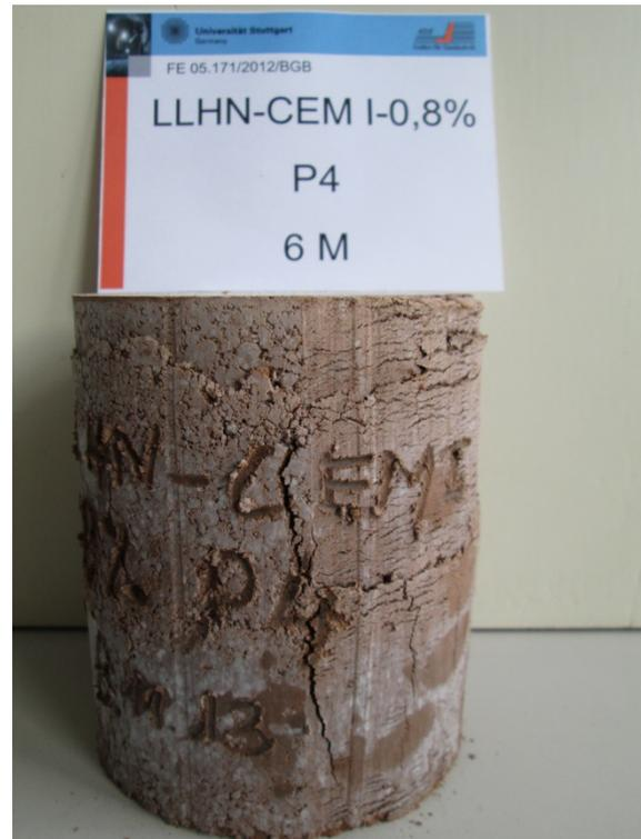
Anlage 12, Bild 53: Bruchbild Probenmaterial 4 mit 4% CEM I und 8.000 ppm Sulfat nach 6 Monaten ( Probe 4)
