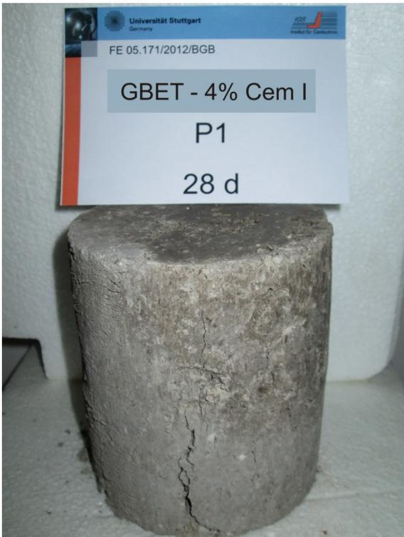
Anlage 12, Bild 3: Bruchbild Probenmaterial 1 mit 4% CEM I Probe 1 nach 28 Tagen
