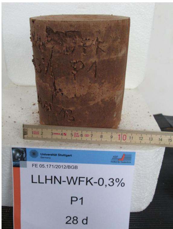
Anlage 12, Bild 18: Bruchbild Probenmaterial 4 mit 4% WFK und 3.000 ppm Sulfat nach 28 Tagen (Probe 1)
