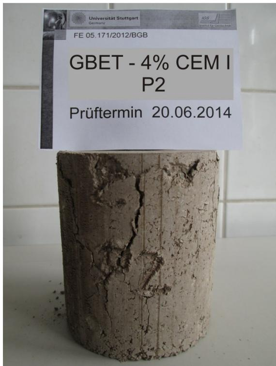
Anlage 12, Bild 6: Bruchbild Probenmaterial 1 mit 4% CEM I Probe 2 nach 6 Monaten
