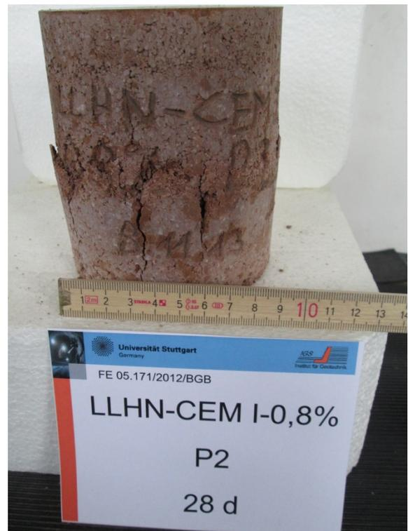
Anlage 12, Bild 33: Bruchbild Probenmaterial 4 mit 4% CEM I und 8.000 ppm Sulfat nach 28 Tagen (Probe 2)
