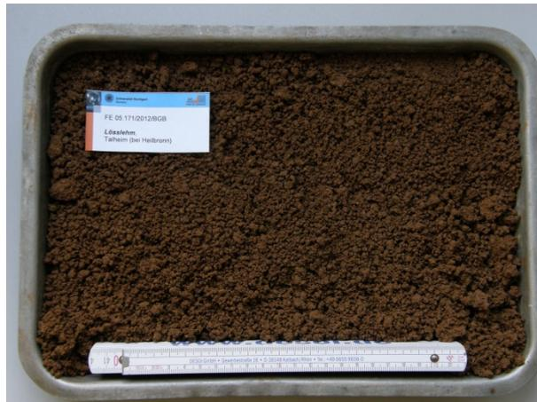
Bild 5: Aufbereitetes Probenmaterial 4 (Lösslehm, Talheim)
