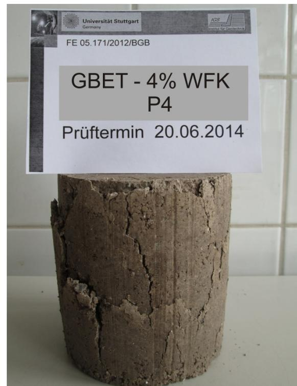
Anlage 12, Bild 9: Bruchbild Probenmaterial 1 mit 4% WFK Probe 4 nach 6 Monaten
