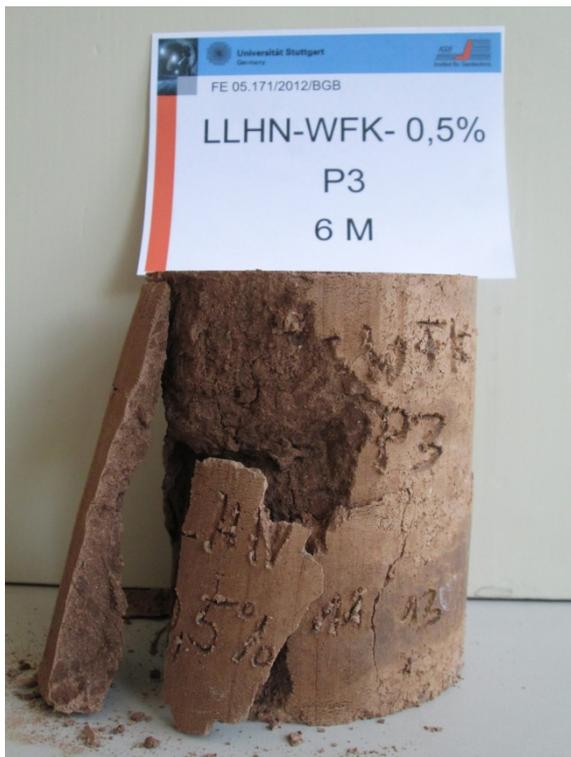
Anlage 12, Bild 40: Bruchbild Probenmaterial 4 mit 4% WFK und 5.000 ppm Sulfat nach 6 Monaten ( Probe 3)
