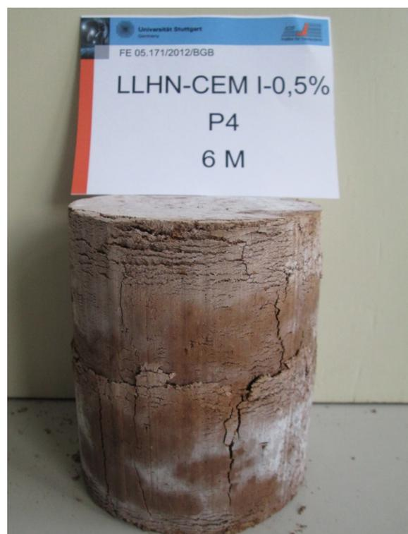
Anlage 12, Bild 51: Bruchbild Probenmaterial 4 mit 4% CEM I und 5.000 ppm Sulfat nach 6 Monaten ( Probe 4)
