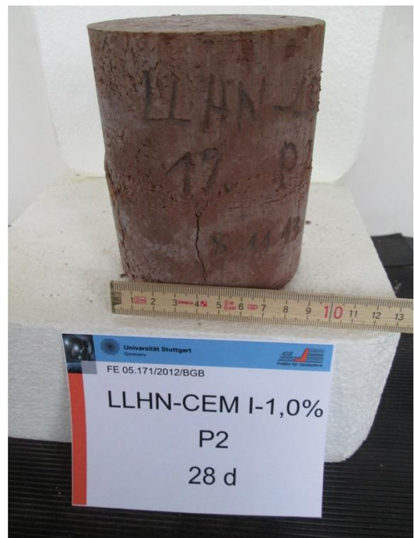
Anlage 12, Bild 35: Bruchbild Probenmaterial 4 mit 4% CEM I und 10.000 ppm Sulfat nach 28 Tagen (Probe 2)
