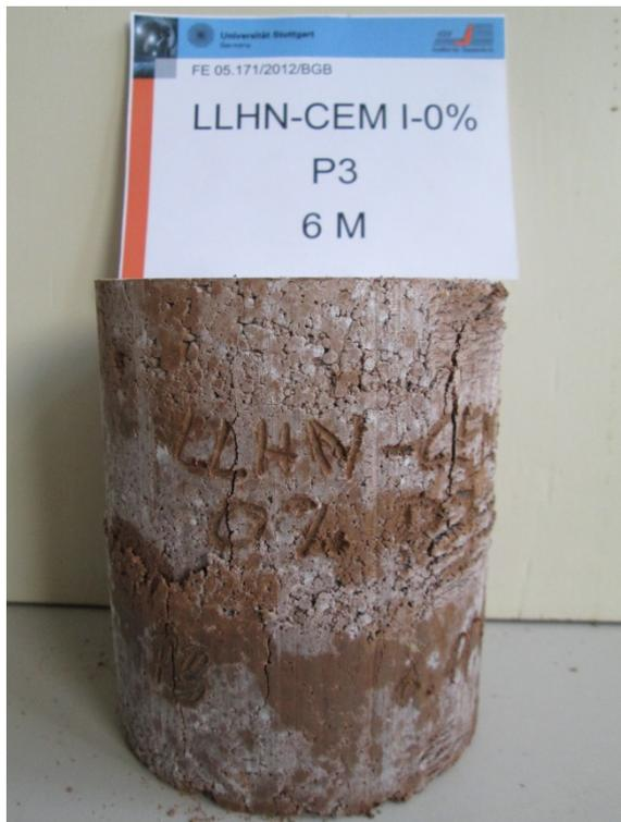
Anlage 12, Bild 46: Bruchbild Probenmaterial 4 mit 4% CEM I und 0 ppm Sulfat nach 6 Monaten ( Probe 3)
