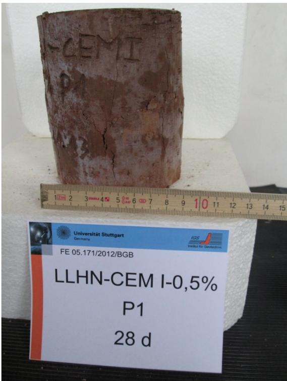
Anlage 12, Bild 30: Bruchbild Probenmaterial 4 mit 4% CEM I und 5.000 ppm Sulfat nach 28 Tagen (Probe 1)
