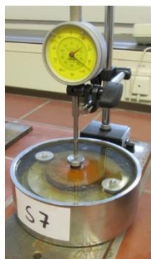
Bild 8: Prüfeinrichtung zur Messung der Quellhebung
