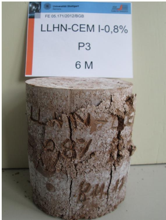
Anlage 12, Bild 52: Bruchbild Probenmaterial 4 mit 4% CEM I und 8.000 ppm Sulfat nach 6 Monaten ( Probe 3)
