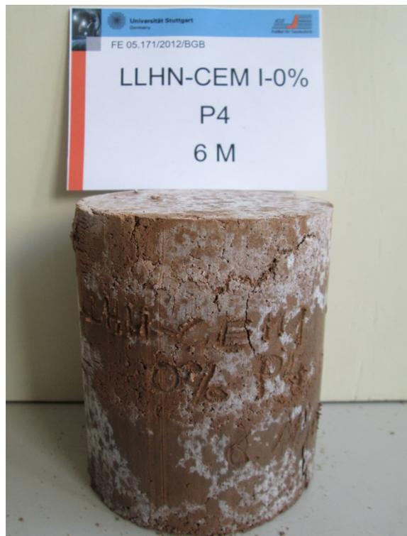
Anlage 12, Bild 47: Bruchbild Probenmaterial 4 mit 4% CEM I und 0 ppm Sulfat nach 6 Monaten ( Probe 4)
