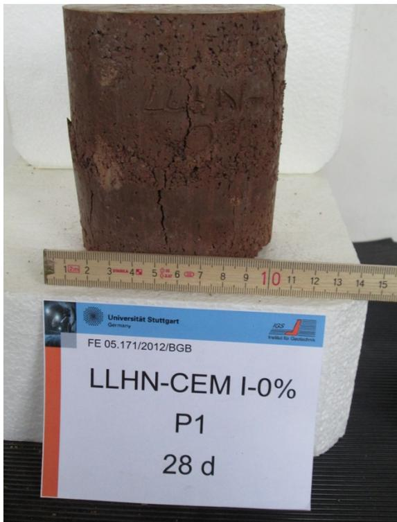
Anlage 12, Bild 26: Bruchbild Probenmaterial 4 mit 4% CEM I und 0 ppm Sulfat nach 28 Tagen (Probe 1)
