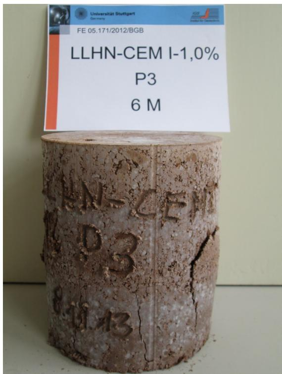
Anlage 12, Bild 54: Bruchbild Probenmaterial 4 mit 4% CEM I und 10.000 ppm Sulfat nach 6 Monaten ( Probe 3)
