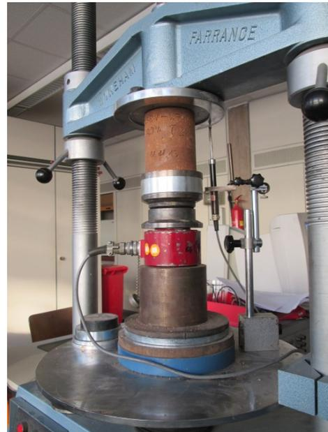
Bild 19: Einaxialer Druckversuche: Prüfpresse
