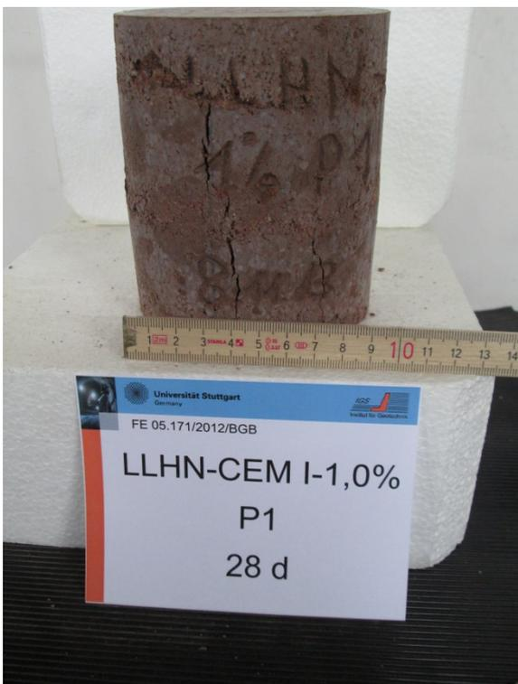
Anlage 12, Bild 34: Bruchbild Probenmaterial 4 mit 4% CEM I und 10.000 ppm Sulfat nach 28 Tagen (Probe 1)
