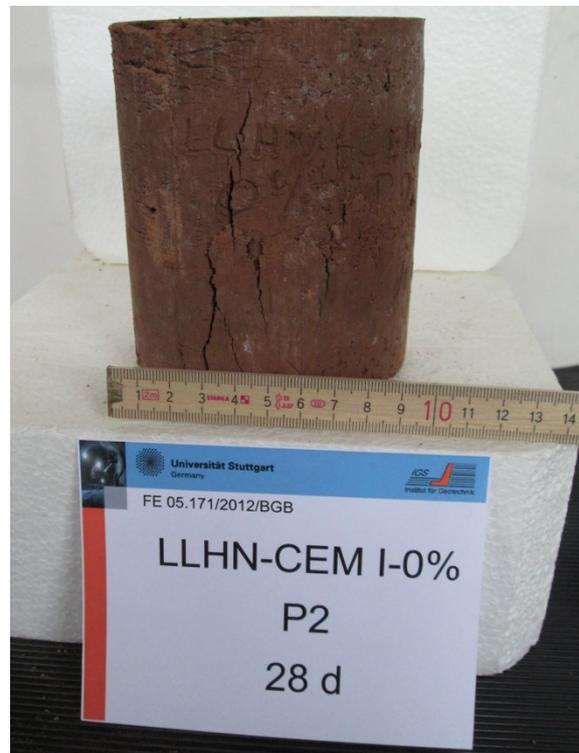
Anlage 12, Bild 27: Bruchbild Probenmaterial 4 mit 4% CEM I und 0 ppm Sulfat nach 28 Tagen (Probe 2)
