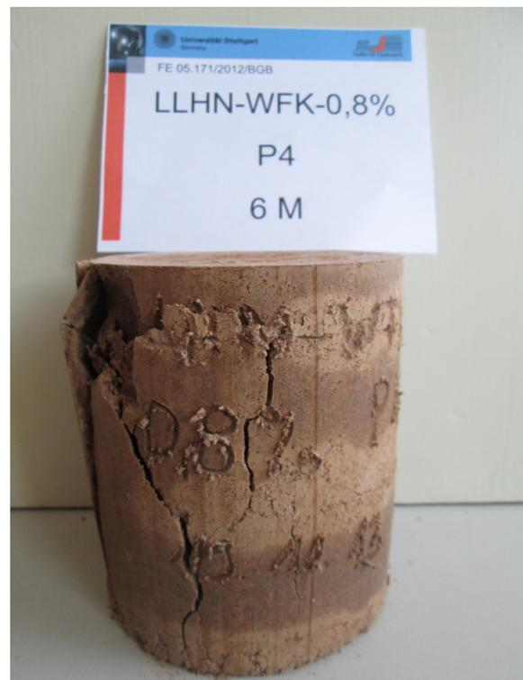
Anlage 12, Bild 43: Bruchbild Probenmaterial 4 mit 4% WFK und 8.000 ppm Sulfat nach 6 Monaten ( Probe 4)
