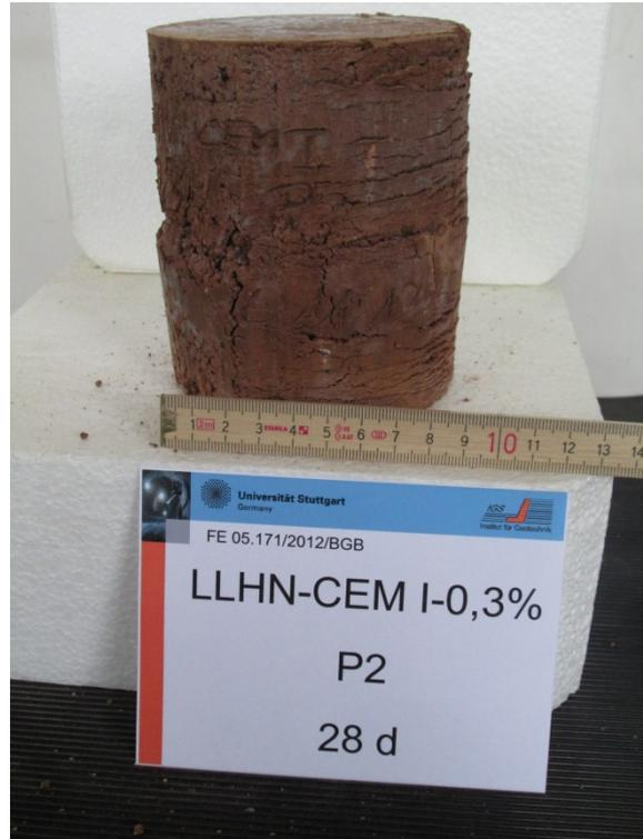
Anlage 12, Bild 29: Bruchbild Probenmaterial 4 mit 4% CEM I und 3.000 ppm Sulfat nach 28 Tagen (Probe 2)
