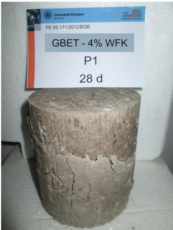
Anlage 12, Bild 4: Bruchbild Probenmaterial 1 mit 4% WFK Probe 1 nach 28 Tagen
