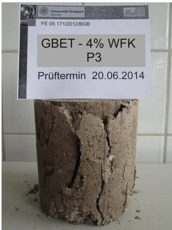
Anlage 12, Bild 8: Bruchbild Probenmaterial 1 mit 4% WFK Probe 3 nach 6 Monaten
