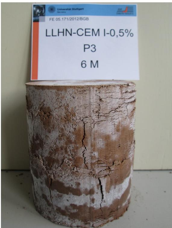
Anlage 12, Bild 50: Bruchbild Probenmaterial 4 mit 4% CEM I und 5.000 ppm Sulfat nach 6 Monaten ( Probe 3)
