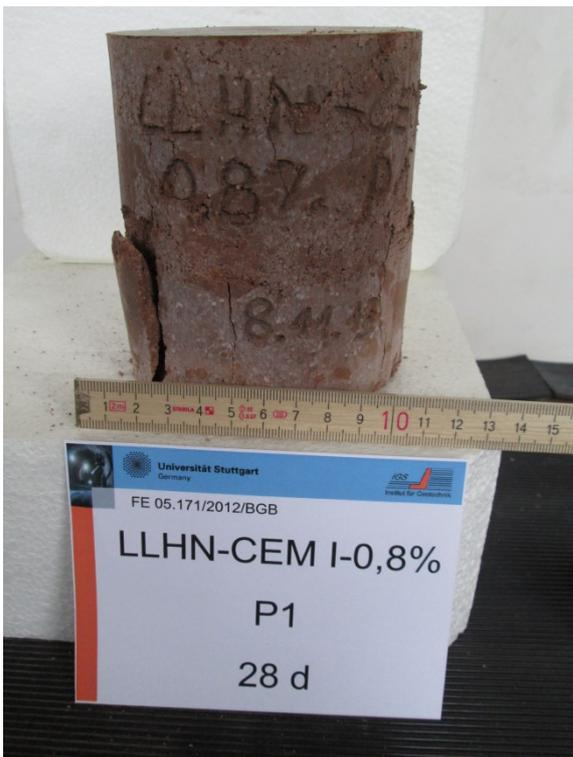
Anlage 12, Bild 32: Bruchbild Probenmaterial 4 mit 4% CEM I und 8.000 ppm Sulfat nach 28 Tagen (Probe 1)
