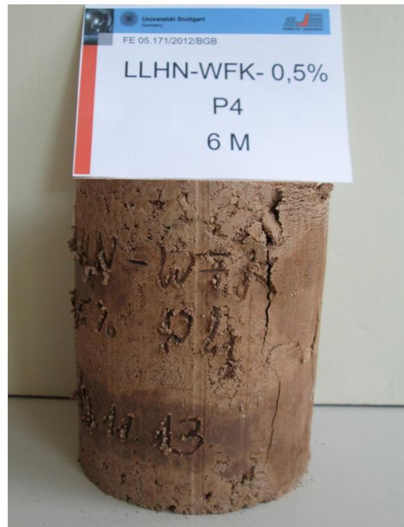
Anlage 12, Bild 41: Bruchbild Probenmaterial 4 mit 4% WFK und 5.000 ppm Sulfat nach 6 Monaten ( Probe 4)
