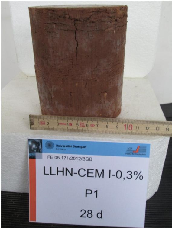
Anlage 12, Bild 28: Bruchbild Probenmaterial 4 mit 4% CEM I und 3.000 ppm Sulfat nach 28 Tagen (Probe 1)
