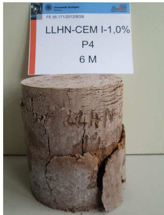
Anlage 12, Bild 55: Bruchbild Probenmaterial 4 mit 4% CEM I und 10.000 ppm Sulfat nach 6 Monaten ( Probe 4)
