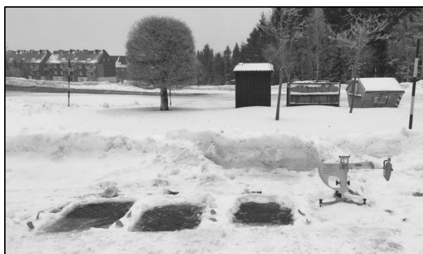
Bild 135: Versuchsaufbau zur Griffigkeitsmessung mit dem SRT-Pendel
