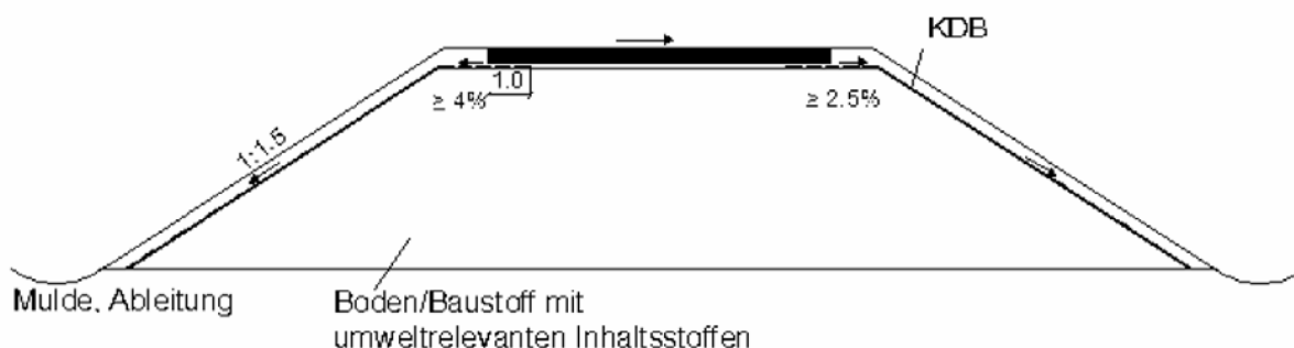
Abbildung 3.3: Bauweise C – Damm mit witterungsunempfindlichen Dichtungselementen
