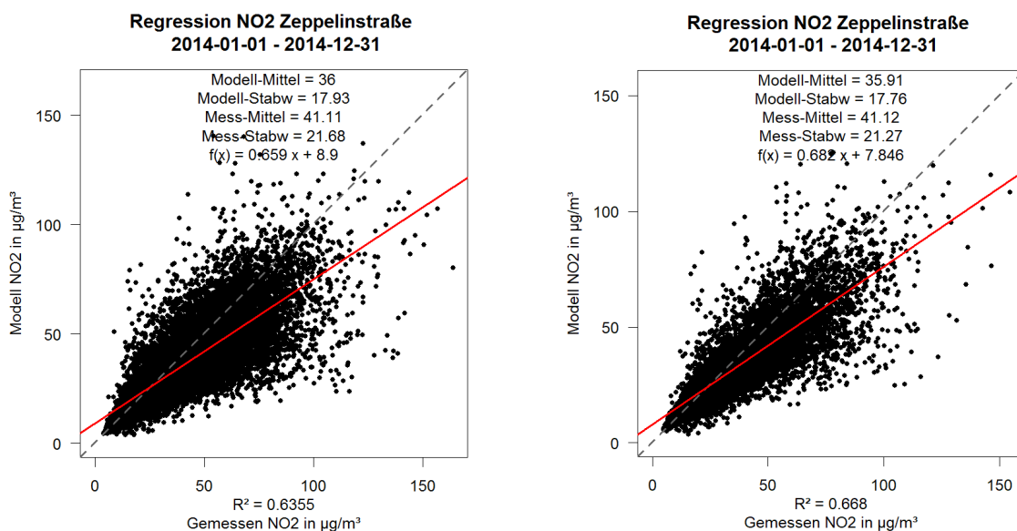
Abbildung 6-1: Streudiagramm der gemessenen und modellierten NO 2 -Immissionen, links als Halbstundenwerte, rechts als Stundenwerte
