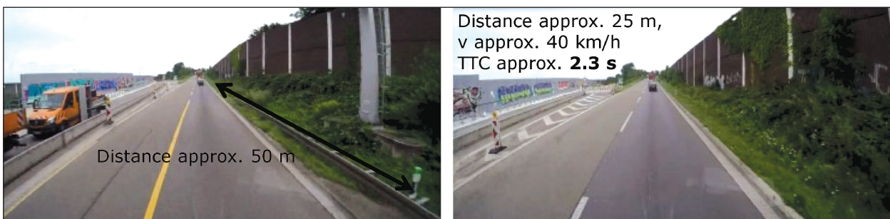
Bild 15: Warnung auf vorausfahrendes Fahrzeug
