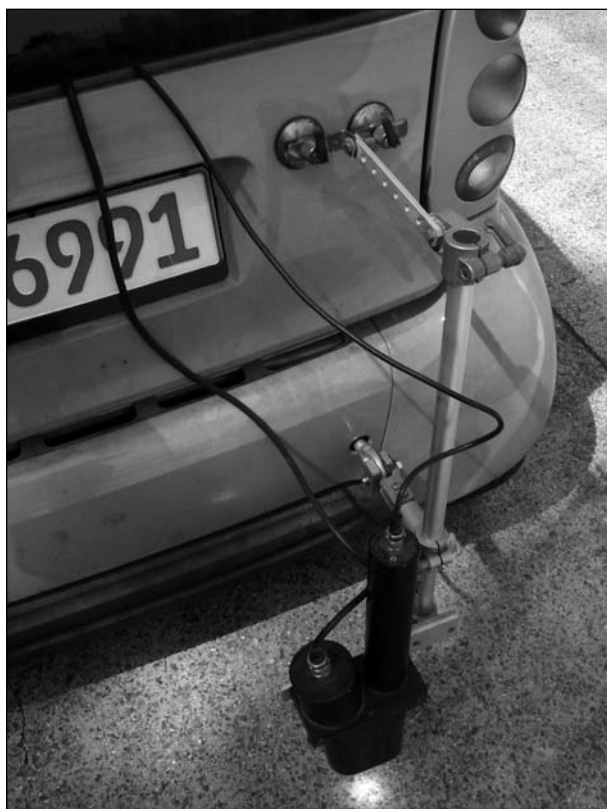
Bild 6.11: „Correvit“-Gerät am Heck des MCC Smart zur Geschwindigkeitsermittlung
