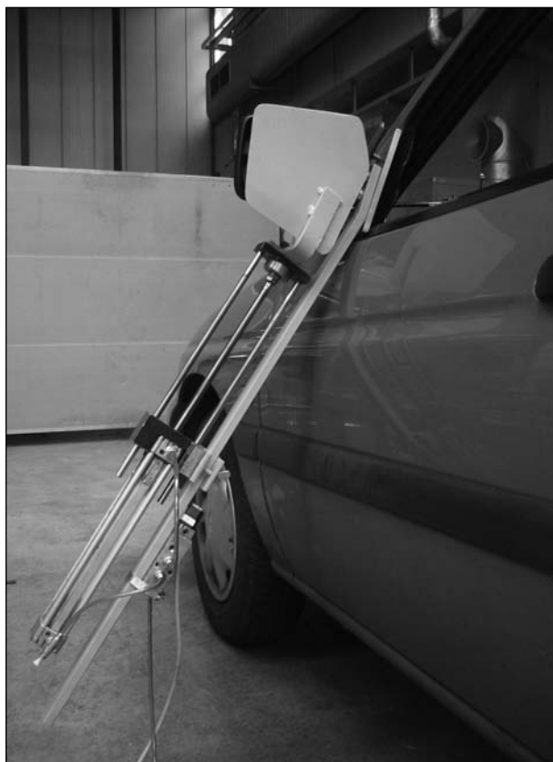
Bild 6.10: Pneumatikzylinder mit Blende, befestigt am Versuchsfahrzeug
