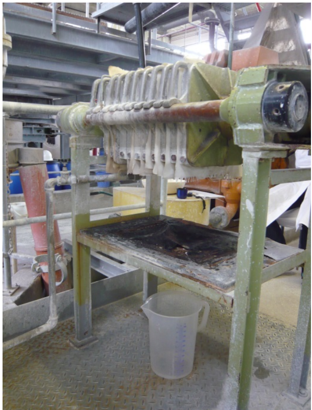
Kammerfilterpresse mit Trichterplatte und Auffangbehälter für Filtrat
