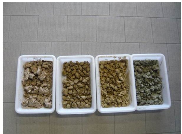
Bodenproben mit 2cm Schichtdicke nach der Trocknung im Trockenschrank mit täglichem Fräsvorgang
