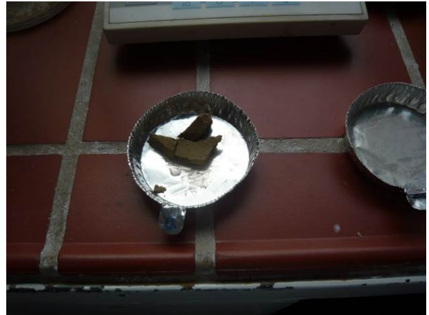
Bestimmung des Restwassergehalts anhand mehrerer Proben eines Filterkuchens nach DIN 18121
