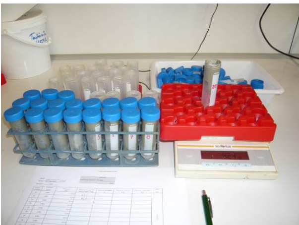
Zentrifugenbehälter aus Kunststoff mit Probematerial
