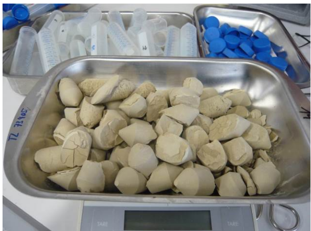
Probematerial nach Trocknung im Trockenschrank
