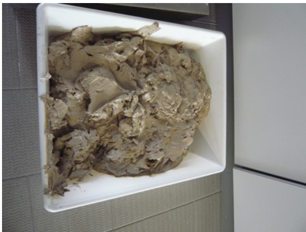
Austrag aus Dekanter - entwässerter Boden TA
