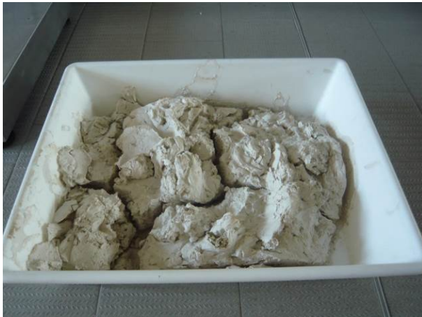
Dekanterausstrag TA nach Anschlußtrocknung in belüfteter Halle
