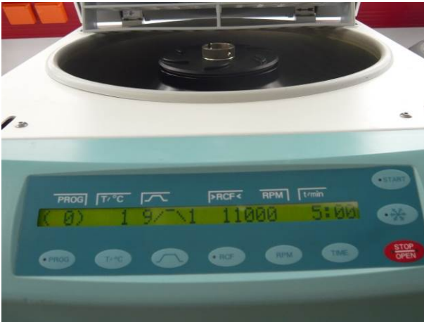
Display Laborzentrifuge, Typ Rotina 380R
