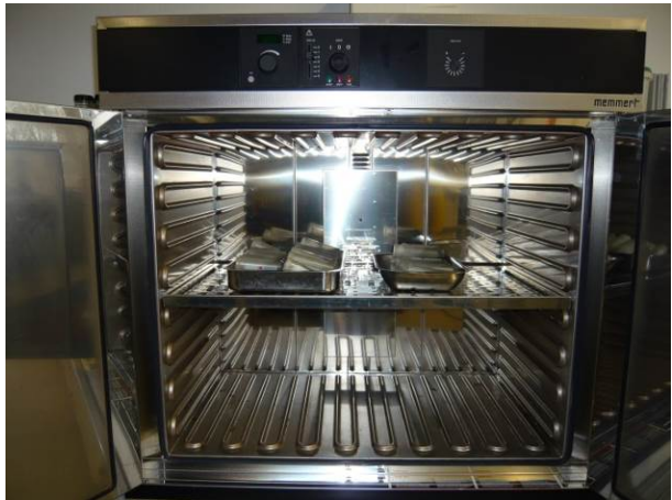
Trocknung der Zentrifugenbehälter mit Probematerial zur Bestimmung des Restwassergehalts
