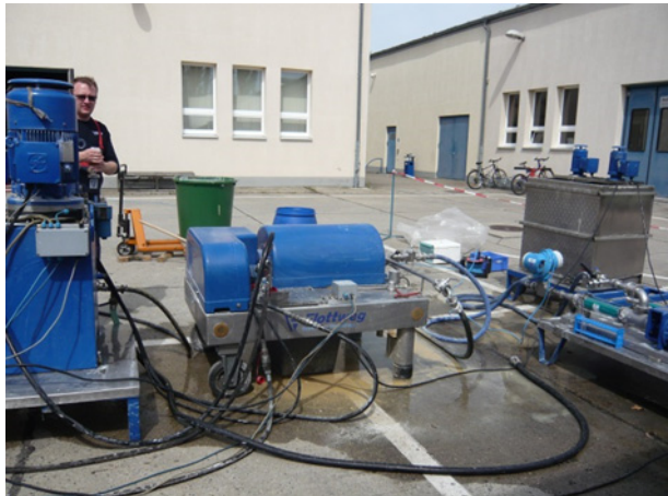
Zentrifuge mit Auffangbehälter für Feststoff
