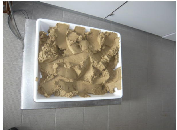
Austrag aus Dekanter - entwässerter Boden TL
