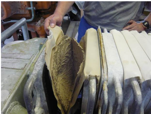
Bildung des Filterkuchens in der Filterplatte
