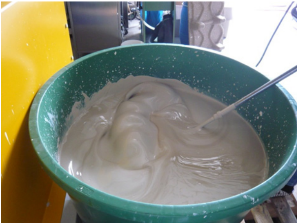
Herstellung einer pumpfähigen Suspension
