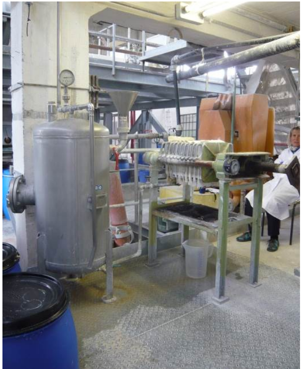
Kammerfilterpresse im Technikum mit Suspensionsbehälter und Druckluftanschluss
