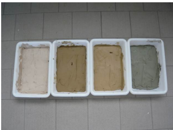
Bodenproben mit 2cm Schichtdicke vor der Trocknung im Trockenschrank
