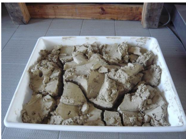
Dekanterausstrag TL nach Anschlußtrocknung in belüfteter Halle
