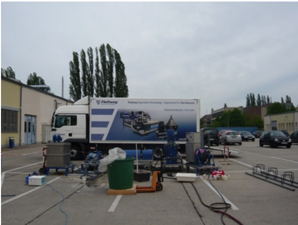
Mobile Decanter-Anlage der Fa. Flottweg
