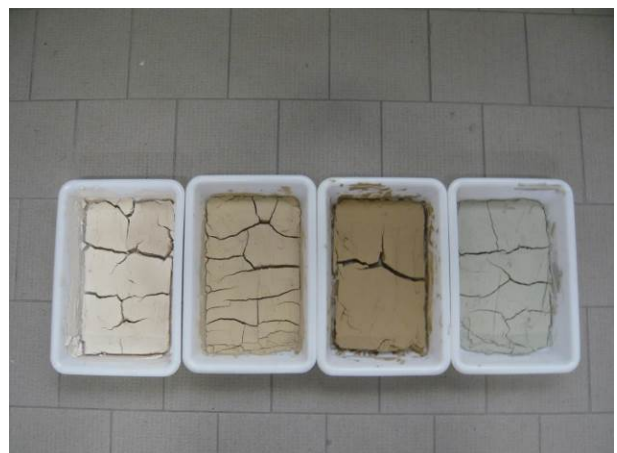
Bodenproben mit 2cm Schichtdicke nach der Trocknung im Trockenschrank
