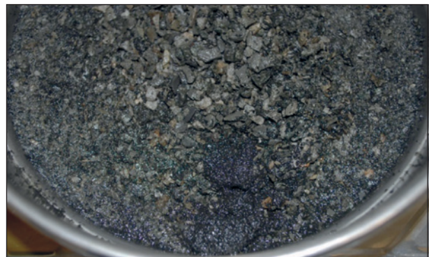
Bild 8: Feine extrahierte Gesteinskörnung mit Gummipartikeln
