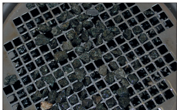
Bild 10: Abgesiebte Kornklasse 5/8 mm
