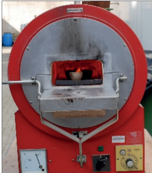
Bild 12: Muffelofen zur Veraschung
