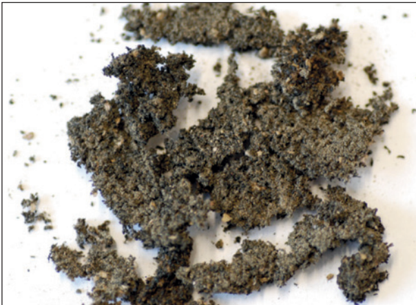
Bild 56: Faserstoffe in ungelösten Gummipartikeln
