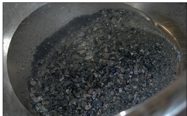
Bild 9: Mit Wasser getrennte Gummipartikel von den Gesteinskörnungen
