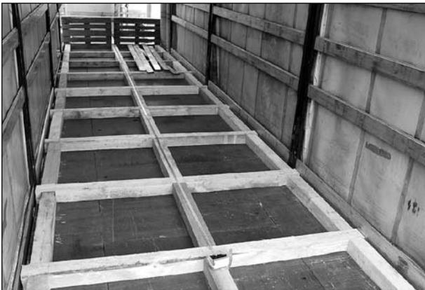
**Bild 6:** Maßnahmen zur Ladungssicherung
