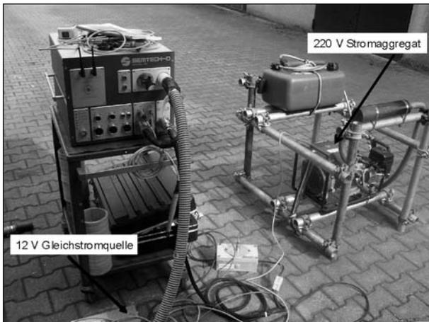
Bild 16: SEMTECH-D mit Energieversorgung
