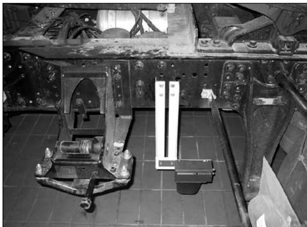
**Bild 15:** Geschwindigkeitsmesssystem DATRON am Fahrzeug
