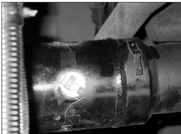
**Bild 14:** Auf der Kardanwelle montierter Dehnmessstreifen im Rohzustand
