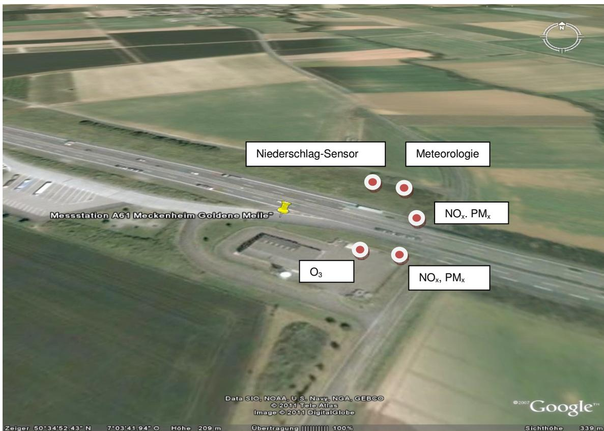
Abbildung 10: Messquerschnitt an der A61 Messgeräte Standort (Google Perspektive)
