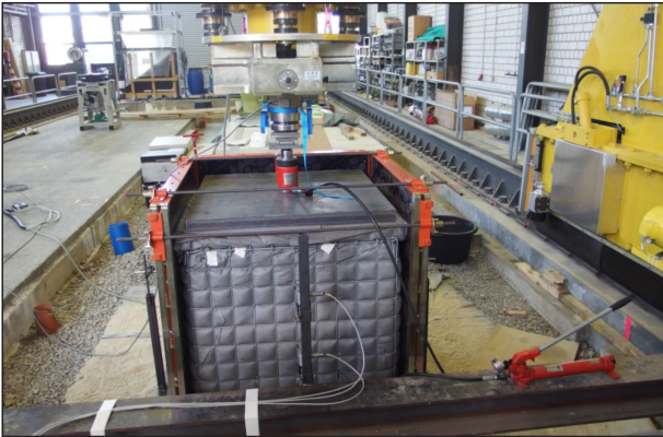
Bild 4–6: Versuch 0, Belastungszyylinder mit Handhydraulikpumpe für die Laststufen von 0 bis 110 kN
