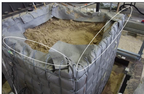
Bild 4-96: Versuch 2, Umgebogene Ösen der Gittermatten (Frontseite im Bild oben rechts)
