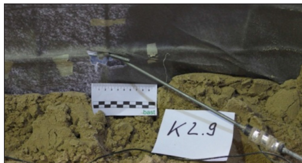
Bild 4–113: Versuch 2, Distanzhalter K2.9 an der linken Seite der Gabione musste mit dem Stahlrohr aufgebogen werden
