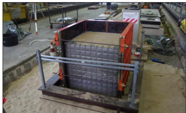
Bild 4–33: Versuch 1, Aufgebaute Gabione mit U-förmiger Stahlrahmenschalung
