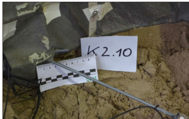
Bild 4–112: Versuch 2, Aufgebogener Distanzhalter K2.10 an der rechten Seite der Gabione
