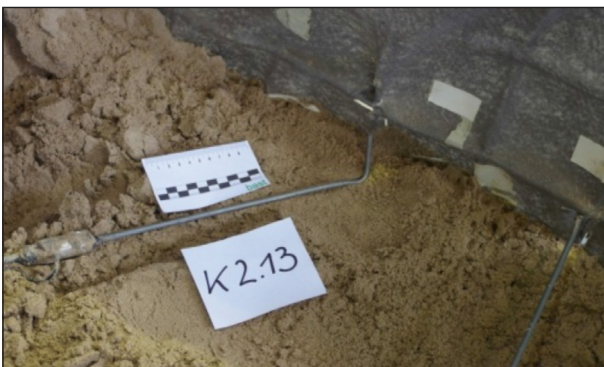
Bild 4–111: Versuch 2, Komplett aufgebogener Distanzhalter K2.13 an der Frontseite der Gabione
