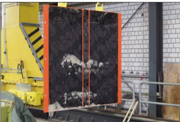
Bild 4–13: Versuch 0, Sandanhaftungen auf der Schalhaut
