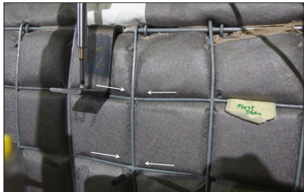
Bild 4–85: Versuch 2, Laststufe 235 kN, Absenkung der horizontalen Drähte im Frontgitter
