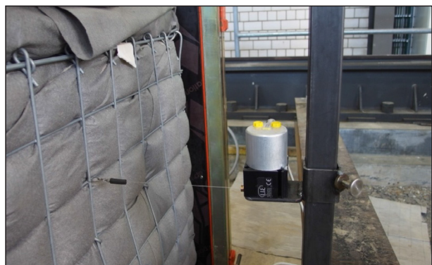
Bild 3–11: Versuch 0, Detailaufnahme des Seilzug-Wegsensors, Messhöhe 0,8 m
