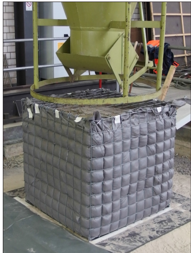
Bild 4–2: Versuch 0, Füllung des oberen Korbereiches durch den Deckel
