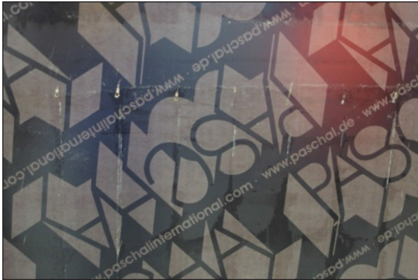
Bild 4-53: Versuch 1, Beschädigungen an der Stahlrahmenschalung durch Gitterrösen
