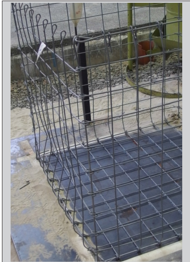
Bild 4–15: Versuch 0, Entleerter Korb (links Frontseite, rechts Seitenteil – Ost)
