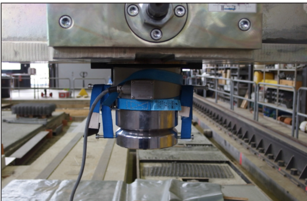
Bild 3–6: Kraftmessdose und Kugelkalotte am Belastungszyylinder befestigt
