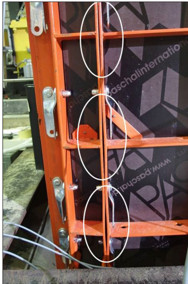
Bild 4-91: Versuch 2, Laststufe 340 kN, Ausbeulungen der Randstege der Stahlrahmenschalung (Rückseite)
