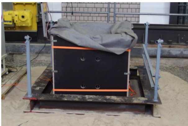
Bild 4–26: Versuch 1, Mit Vlies ausgekleidete Gabione am Versuchsort; die Behelfsschalung ist zusätzlich mit 2 Spanngurten verzurrt.
