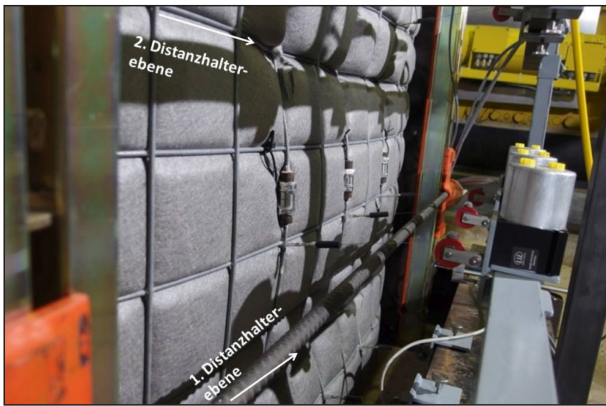
Bild 4-89: Versuch 2, Laststufe 310 kN, verformungsbegrenzende Wirkung beider Distanzhalterebenen (1. DH-Ebene durch GEWI verdeckt)
