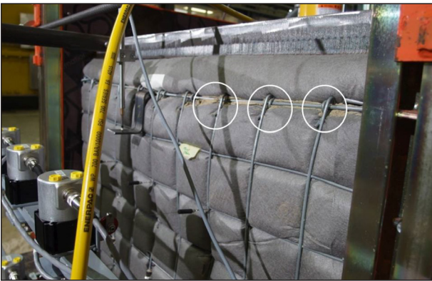
Bild 4–83: Versuch 2, Laststufe 210 kN, Abknicken der oberen Ösen des Frontgitters
