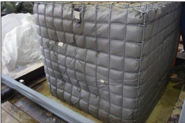
Bild 4–57: Versuch 1, Deformierter Gabionenkorb nach Versuchsende
