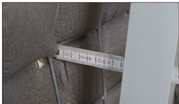
Bild 3–12: Versuch 0, Durchführung vereinfachter Distanzmessungen an der Mittelachse der Front
