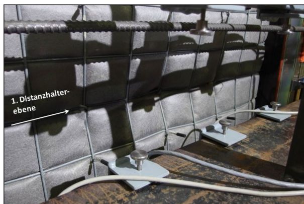
Bild 4–88: Versuch 2, Laststufe 285 kN, Verminderte Ausbauchungen im Bereich der 1. Distanzhalterebene (H = 0,3 m)
