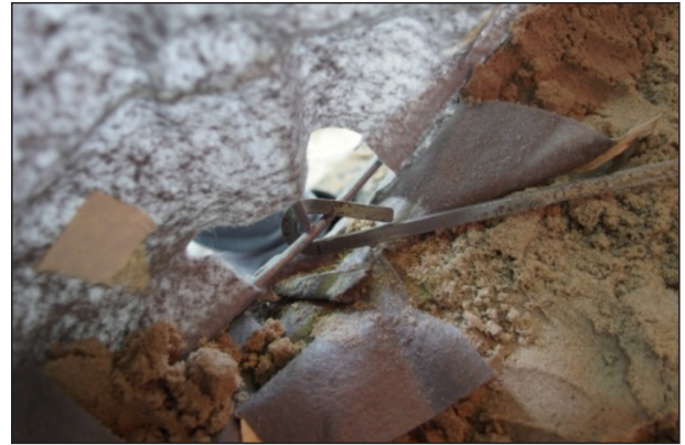
Bild 4–62: Versuch 1, Intakter Haken von Distanzhalter D1.9 (Flachstahl) nach Versuchsende bei 185 kN (Beispiel)
