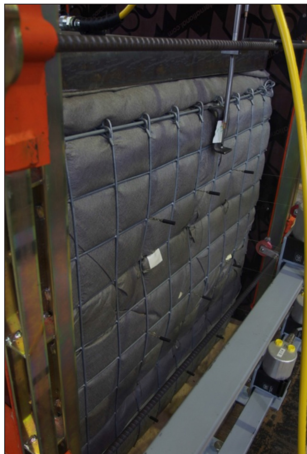
Bild 4–41: Versuch 1, Erkennbare Ausbauchungen in der Mitte der Gabione bei einer Belastung von 85 kN
