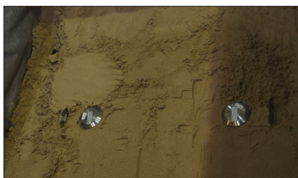
Bild 3–15: Versuch 1, Erddruckgeber Ebene 1 (0,4 m Höhe)
