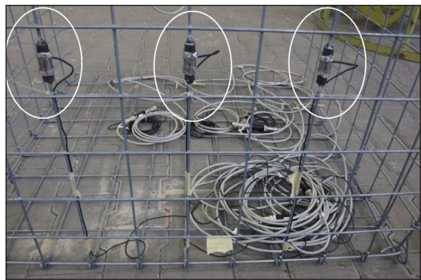
Bild 4–69: Versuch 2, Bodengitter mit Kraftsensoren K2.1 bis K2.3 (Ausschnitt aus Bild 4–68)
