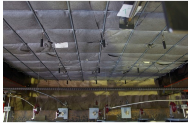
Bild 4-54: Versuch 1, Die Seilzug-Wegsensoren wurden unter den Gitterknoten des Frontgitters eingehängt.
