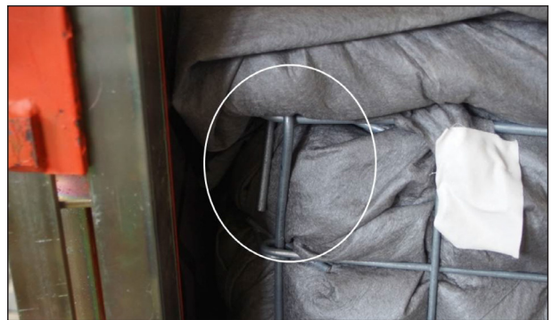
Bild 4–10: Versuch 0, Aufbiegung der Öse am linken Steckstab der Frontseite
