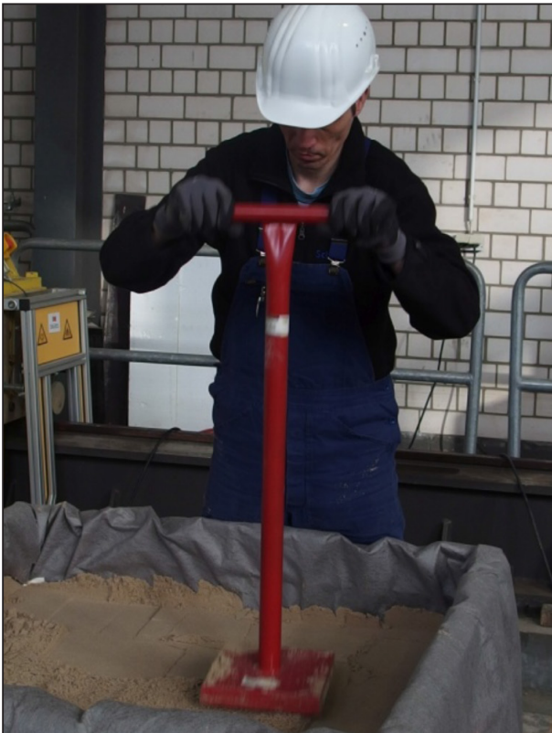
Bild 4–29: Versuch 1, Verdichten der Sandfüllung
