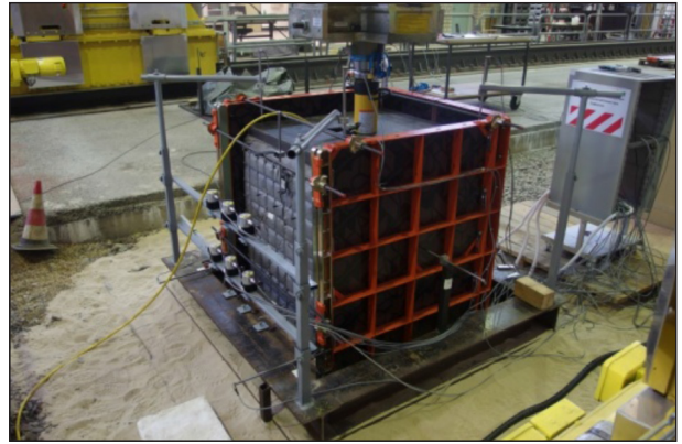
Bild 4-35: Versuch 1, Kompletter Versuchsaufbau mit Handhydraulikeinheit
