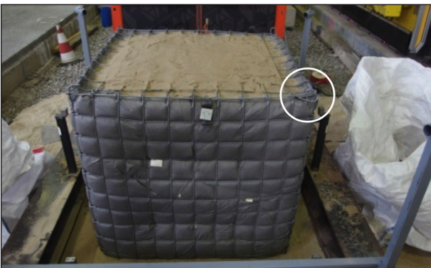
Bild 4–44: Versuch 1, Deformation an der rechten vorderen Ecke des Deckelgitters
