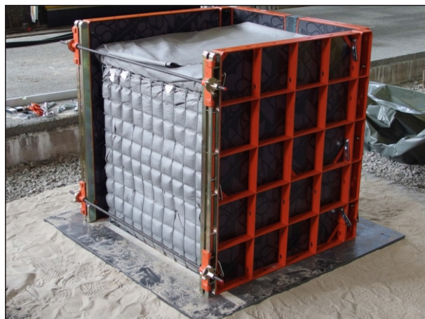
Bild 4–4: Versuch 0, Gabione mit eingebauter Stahlrahmenschalung und Lastkissen
