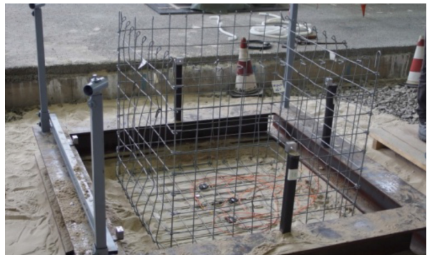
Bild 4–46: Versuch 1, Leerer Gabionenkorb nach Versuchsende und Abbau
