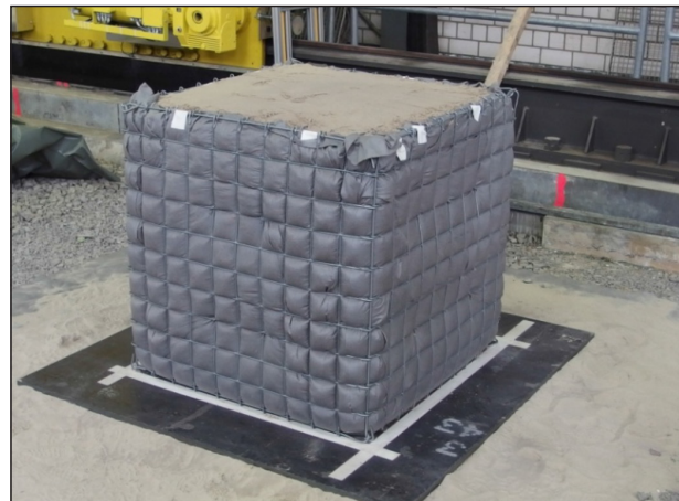
Bild 4–3: Versuch 0, vollständig befüllter Korb
