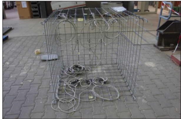
Bild 4–68: Versuch 2, Montage des Korbes außerhalb der Versuchsfläche
