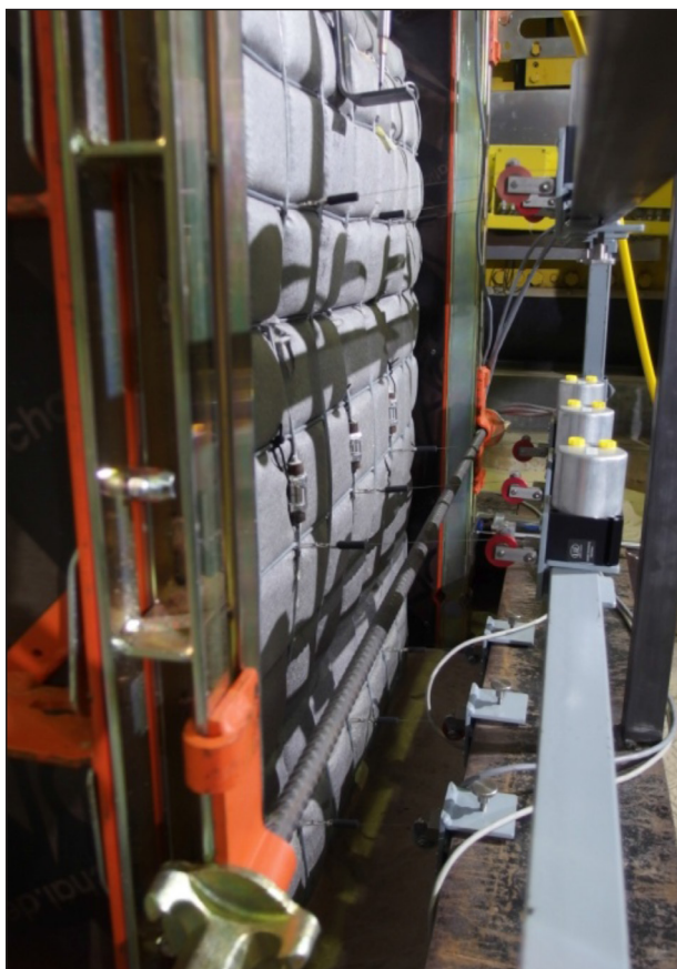
Bild 4–86: Versuch 2, Laststufe 235 kN, Ausbauchungen des Frontgitters
