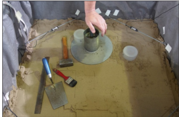
Bild 4-100: Versuch 2, Entnahme einer ungestörten Sandprobe mithilfe eines Ausstechzylinders in Höhe 0,62 m beim Aufbau der Gabione
