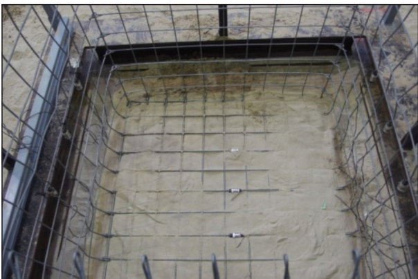
Bild 4-99: Versuch 2, Entleerter Korb, Ansicht Bodengitter (Frontseite im Bild links)
