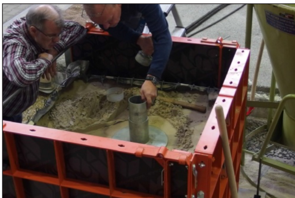
Bild 4–17: Versuch 0, Positionieren eines Ausstechzylinders
