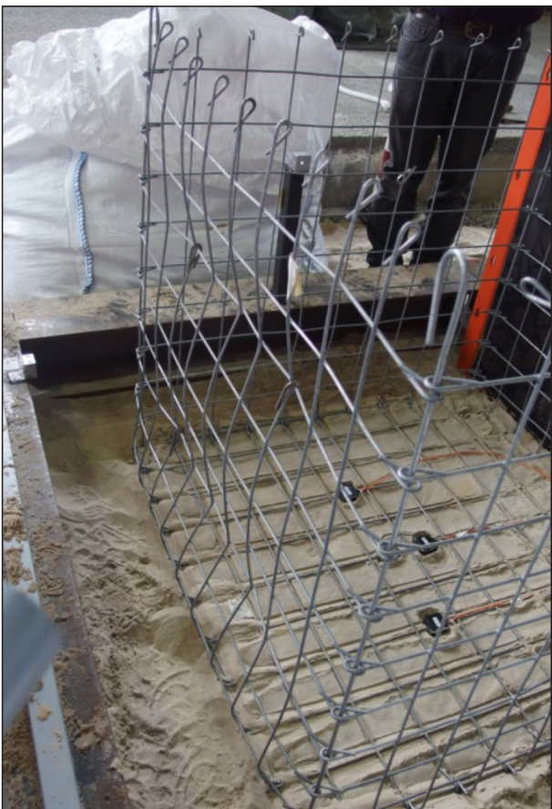
Bild 4–58: Frontseite des leeren Gabionenkorbes nach Versuchsende
