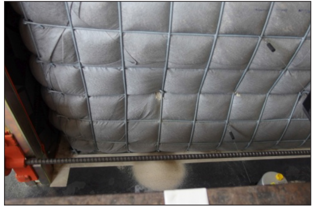
Bild 4–8: Versuch 0, Vlies reißt auf (Laststufe 135 kN)
