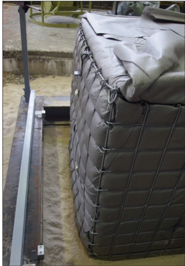
Bild 4–45: Versuch 1, Gabione ohne Schalung, Deformation des Korbes sehr gut erkennbar
