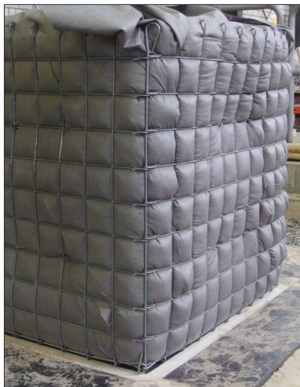
Bild 4–19: Versuch 0, nahezu vollständig befüllte Gabione ohne Deckelgitter (links Rückseite, rechts Seitenteil West)
