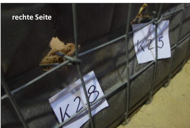
Bild 4–110: Versuch 2, Leicht aufgebogene Haken von K2.5 und K2.8 an der rechten Seite der Gabione
