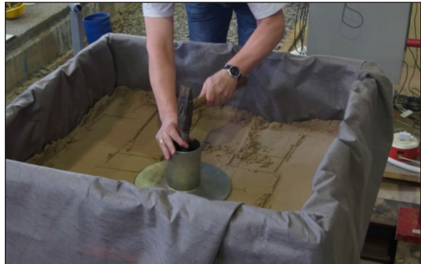
Bild 4–30: Versuch 1, Stutzenentnahme durch das Erdbaulabor zur Bestimmung der Dichte und des Wassergehalts
