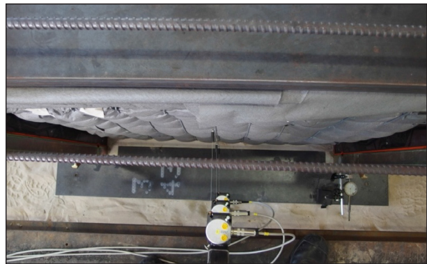
Bild 3–10: Versuch 0, Draufsicht auf die Seilzug-Wegsensoren und Messuhr 4 an der Frontseite (Südseite)
