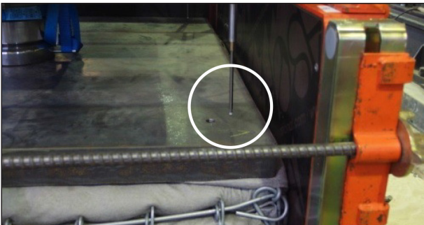
Bild 4–43: Versuch 1, Wegsensor W 1.5 hat den Kontakt zur Lastplatte verloren. Das Lastpolster wurde in das Deckelgitter hinein gedrückt
