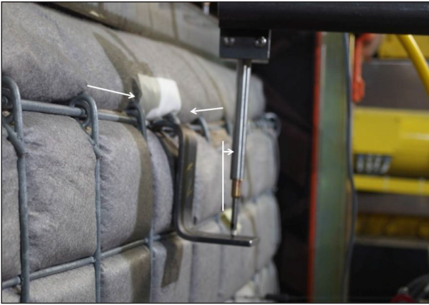
Bild 4–82: Versuch 2, Laststufe 160 kN, Durchbiegung des oberen Steckstabs des Frontgitters und Neigung von Wegsensor W2.4
