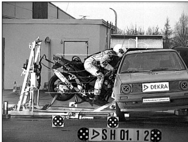
Bild 6.32: Kopfanprall und Darstellung der Trajektorien einiger Targets am Dummy
