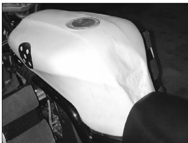
Bild 6.43: Beschädigungen am Tank
