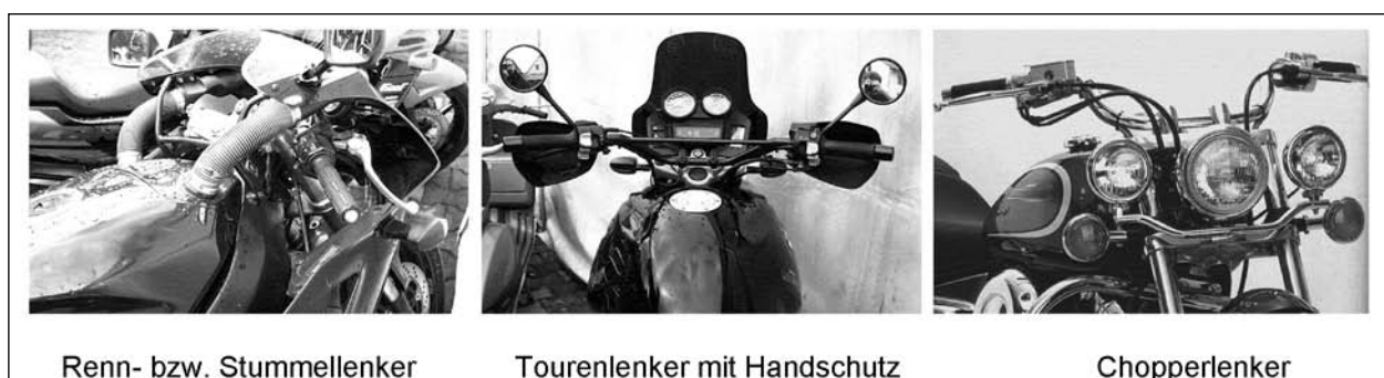
Bild 4.4: Grundtypen von Motorrad-Lenkern
