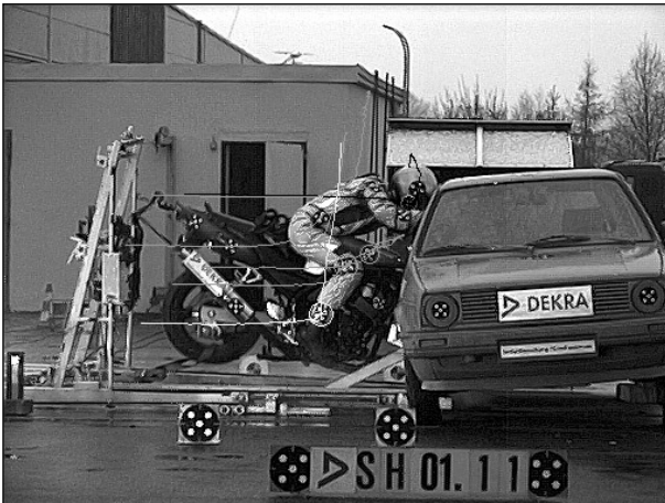
Bild 6.28: Kopfanprall und Darstellung der Trajektorien einzelner Targets am Dummy
