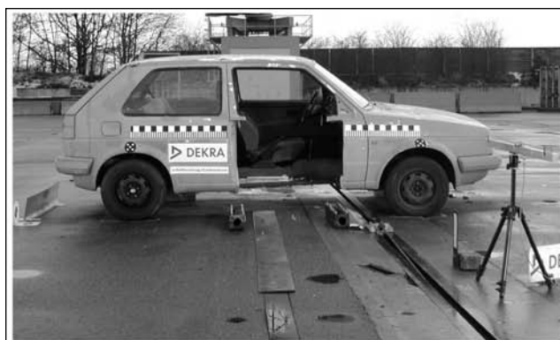
Bild 6.7: Pkw für Schlittenversuch mit ausgeschnittenem Unterboden und entfernter Seitentür
