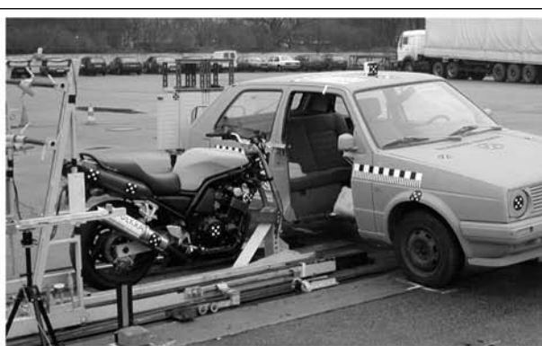
Bild 6.7: Pkw für Schlittenversuch mit ausgeschnittenem Unterboden und entfernter Seitentür
