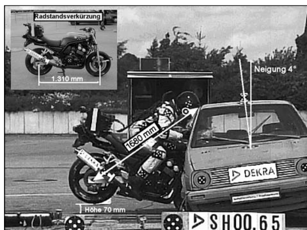
Bild 6.5: Für die Reproduzierbarkeit relevante Maße beim Full-Scale-Test
