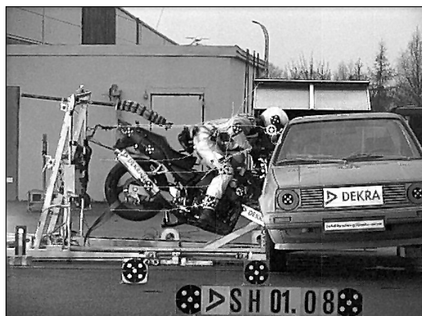
Bild 6.20: Kopfanprall und Darstellung der Trajektorien einzelner Targets
