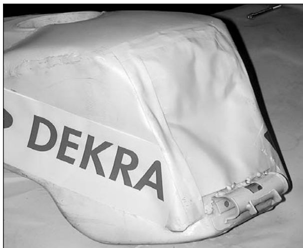
Bild 6.27: Beschädigungen am adaptierten Sporttank
