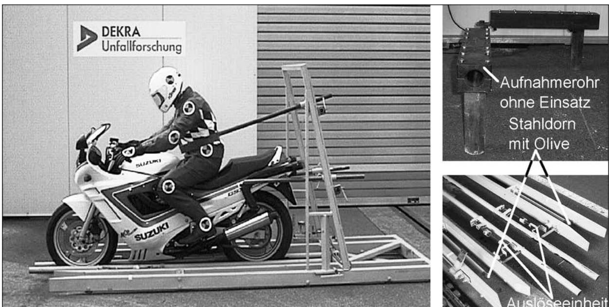
Bild 4.21: Schlitten zur Fixierung von Dummy und Motorrad während der Bewegung bis kurz vor den Kollisionsort
