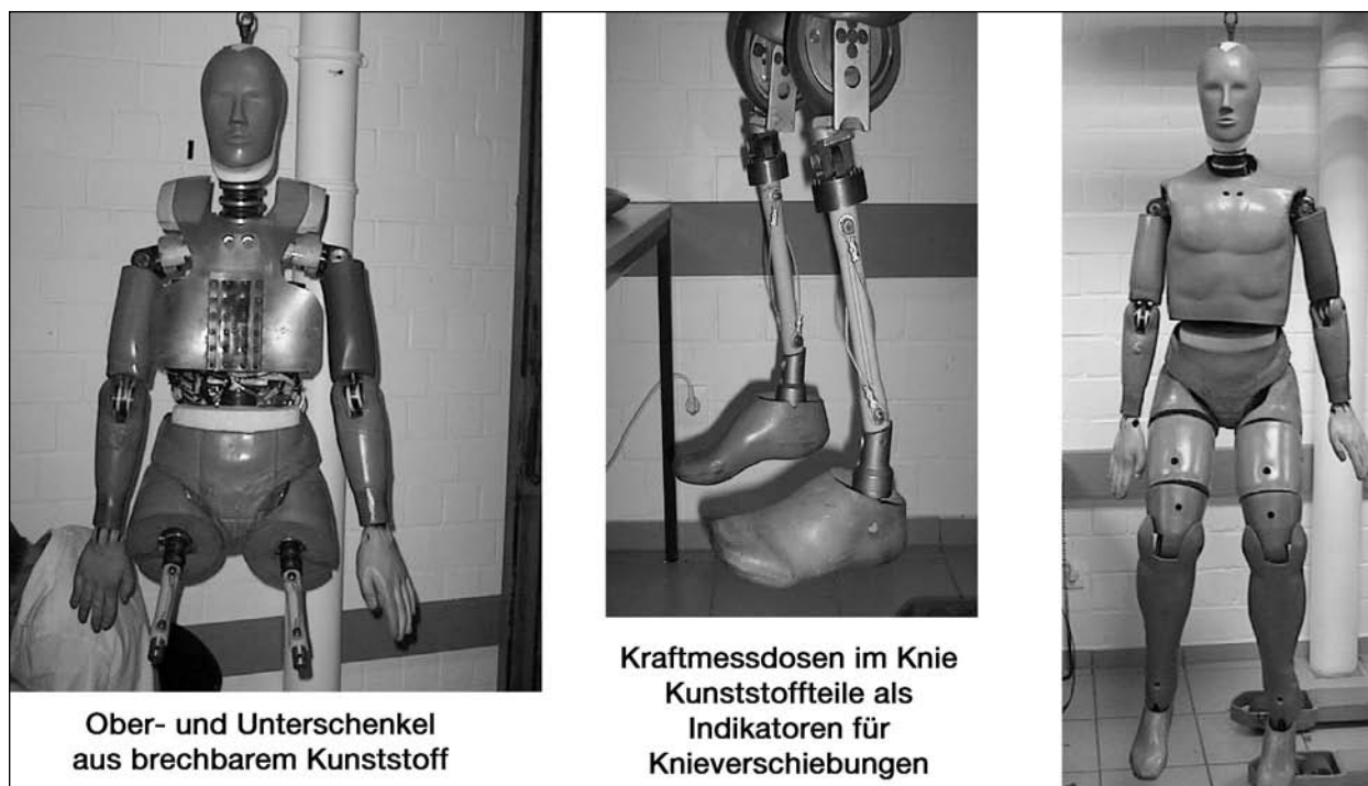
Bild 7.5: Motorcyclist Anthropometric Test Device (MATD) nach ISO 13232
