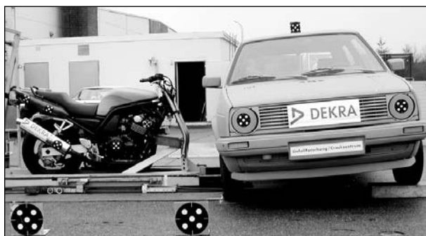
Bild 6.6: Neigung des Pkw und verkürzter Radstand des Motorrads beim Schlittenversuch
