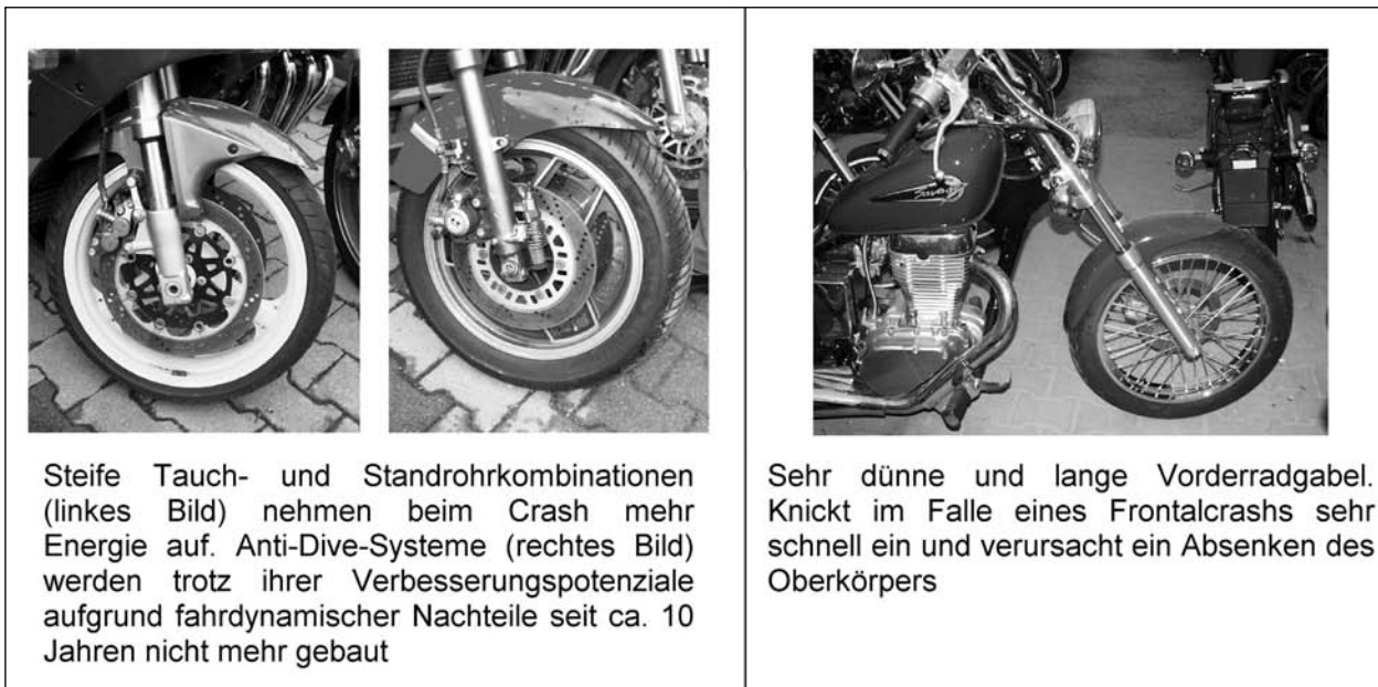
Bild 4.10: Verschiedene Gabelkonstruktionen
