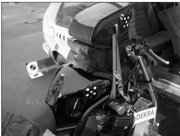
Bild 6.35: Beschädigungen am Tank
