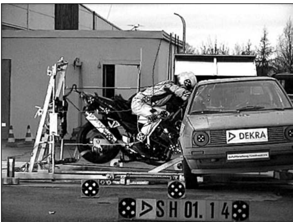
Bild 6.40: Kopfanprall und Darstellung der Trajektorien einzelner Targets am Dummy
