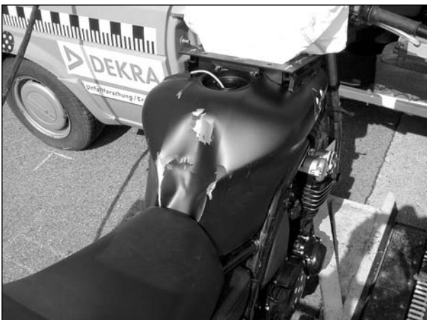
Bild 6.47: Beschädigungen am Tank
