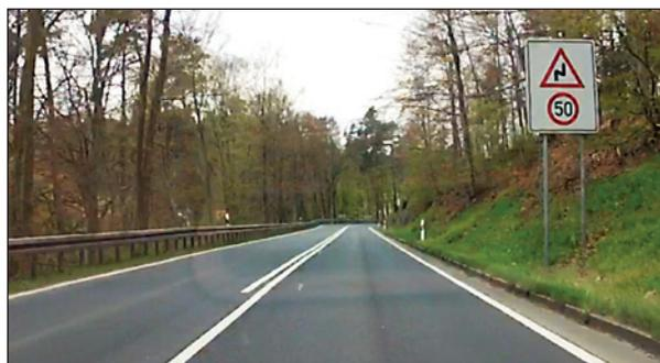
Bild 96: S 95 – Beschränkung der zulässigen Höchstgeschwindigkeit auf  $V_{zul} = 50$  km/h mit Z 105 StVO und einer doppelten Fahrstreifenbegrenzungslinie
