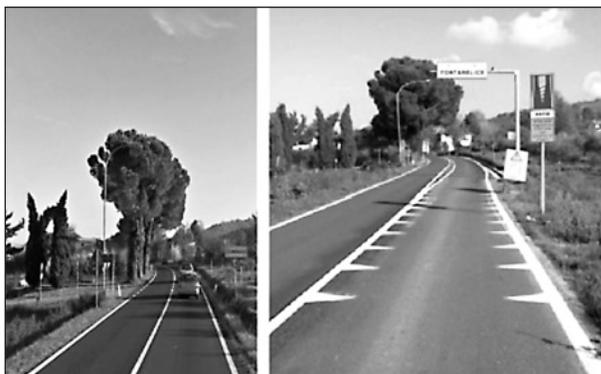
Bild 20: Ortseingang vor der Umgestaltung (links), Ortseingang mit Haifischzähnen, markierter Mittelinsel und Ortseingangsschild nach der Umgestaltung (rechts) (LANTIERI u. a., 2015)
