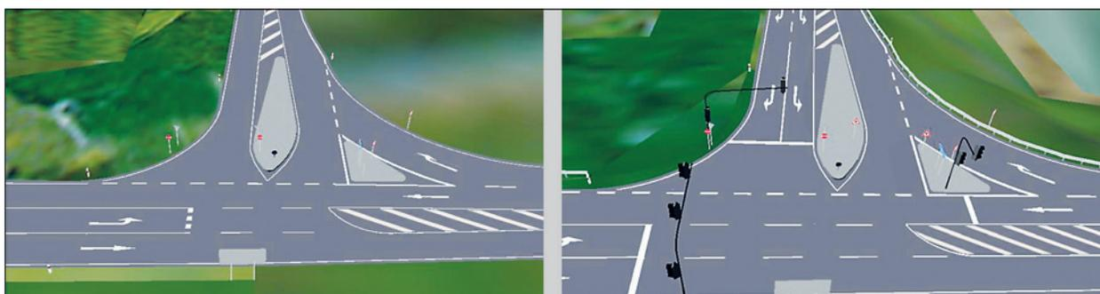
Bild 30: Standardsituation nach RMS (1980) ohne LSA (links) und mit LSA (rechts), ergänzt durch Leitplatte (Z 626 StVO) an Z 222 StVO (MAIER u. a., 2015)
