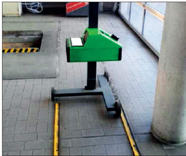
Bild 36: SEP mit nicht verwendeten Führungsschienen
