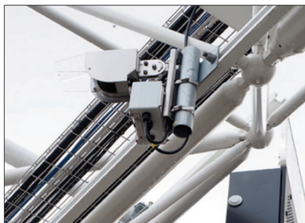
Bild 4-1: Lasersensoren zur Ermittlung der Restlängen [ZVM]
