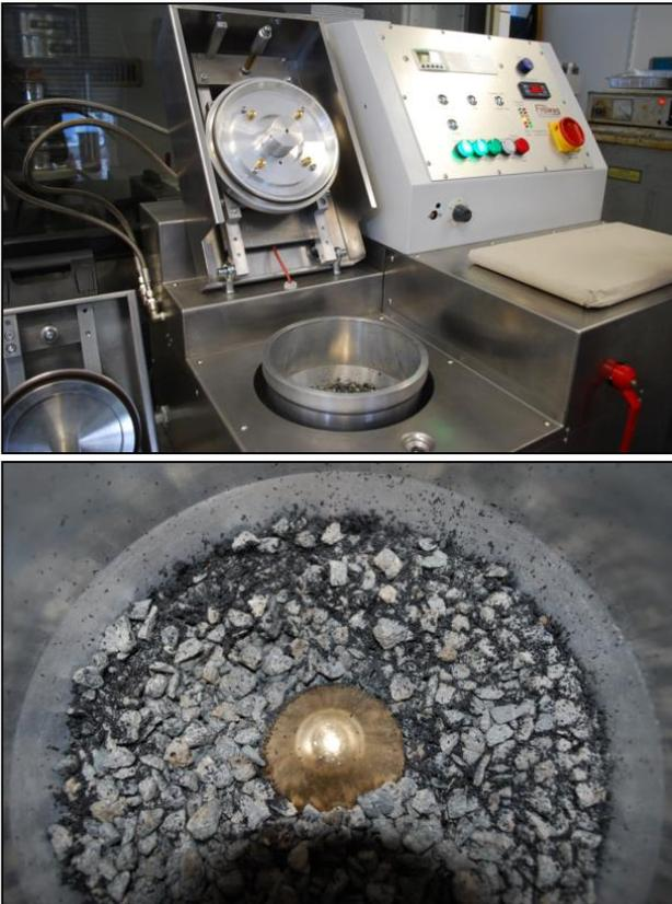
Bild 42: Geschlossene Extraktionsanlage – Hersteller 2
