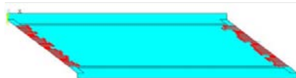
Bild 1-43: Einwirkungen aus Normalkräften der Vorspannung
