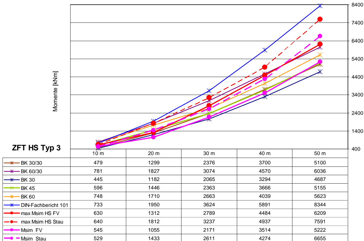
Abbildung 23: Zweifeldträger: Verkehr nur in der Hauptspur
