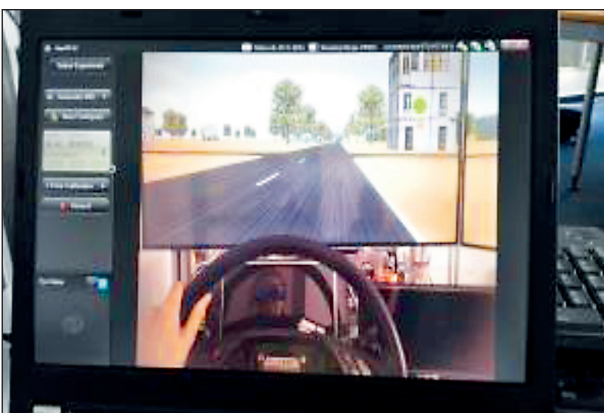
Bild 10: Test der Blickbewegungsmessung am Simulator: der Proband schaut auf das Haus (grüner Punkt).
