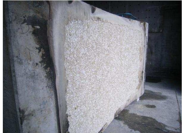
**Bild 132** Brandbeanspruchte Seite des Probekörpers GB4 (Faserbeton 2,0 kg/m<sup>3</sup> PP)
