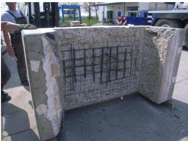
**Bild 143** Probekörper nach der Brandbeanspruchung
