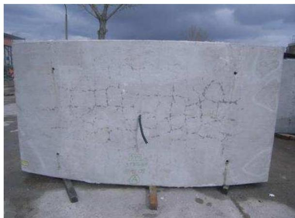
**Bild 97** Rückseite des Probekörpers GB1 (Referenzbeton) nach dem Brandversuch
