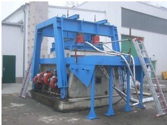
**Bild 26** Vorhandene Belastungseinrichtung für die Durchführung von Großbrandversuchen an Tunnelinnenschalensegmenten
