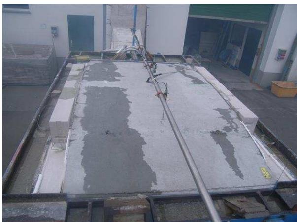
**Bild 108** Probekörper GB2 (Faserbeton 2,0 kg/m<sup>3</sup> PP) nach Beendigung der Brandbeanspruchung
