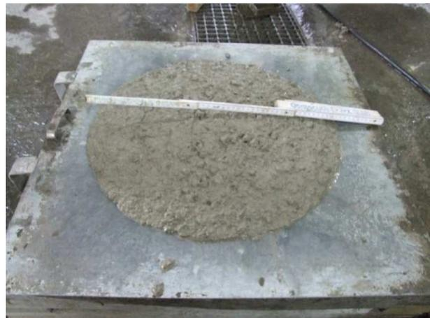
**Bild 164** Beton GL4,  $ao^8=51,0$  cm
