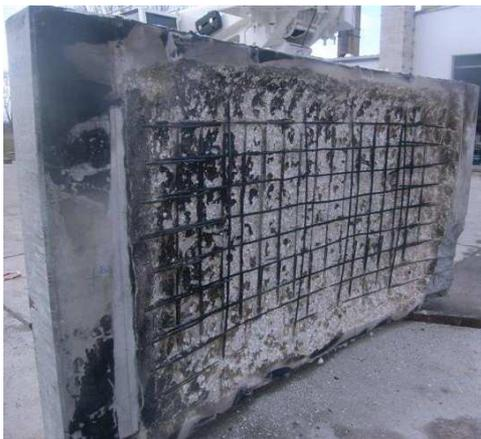
**Bild 67** Probekörper GB1 (Referenzbeton) nach der unbelasteten Brandbeanspruchung
