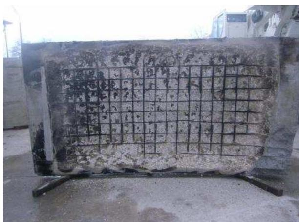
**Bild 98** Brandbeanspruchte Seite des Probekörpers GB1 (Referenzbeton) nach dem Brandversuch
