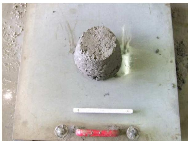
**Bild 191** Beton OG5,  $a_m=43,0\text{cm}$ , nach Pumpvorgang mit 0,8 M.-% v.Z. Sedimentationsreduzierer
