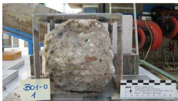
**Bild 14** „Rest“-Prüfkörper B01-1 (1) nach dem Entfernen der losen Bestandteile
