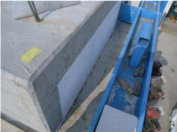
**Bild 137** Probekörper OB1 (Referenzbeton) vor der Brandprüfung
