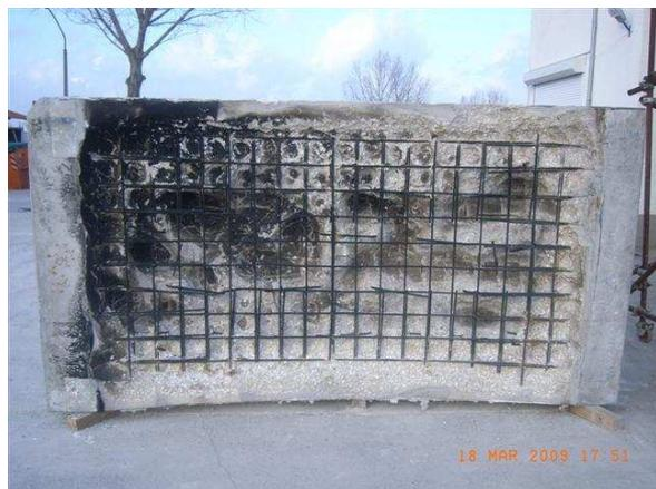
**Bild 69** Probekörper GB3 (Referenzbeton) nach der belasteten Brandbeanspruchung
