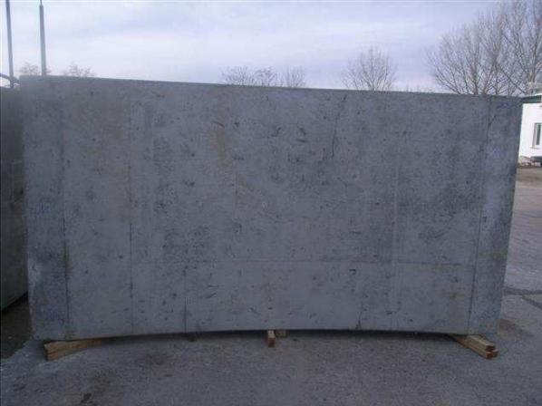
**Bild 102** Probekörper GB2 (Faserbeton 2,0 kg/m<sup>3</sup> PP) vor der Prüfung
