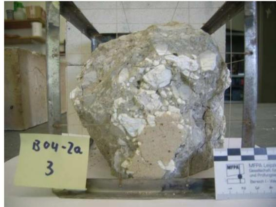
**Bild 25** Probekörper B04-2a (3) – „Restquerschnitt“ nach dem händischen Entfernen des losen Materials
