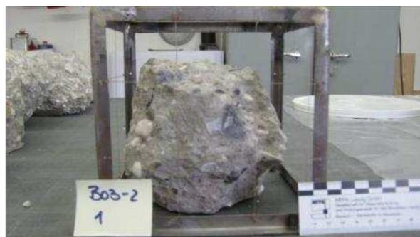
**Bild 22** Prüfkörper B03-2 (1) – „Restquerschnitt“ nach dem händischen Entfernen des losen Materials
