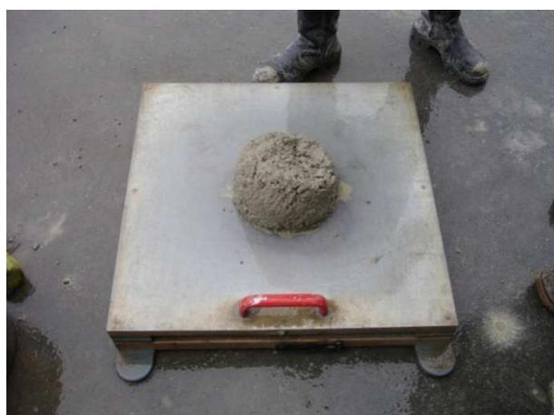
**Bild 179** Beton GG1,  $ao^8=47,5$  cm, nach Pumpvorgang
