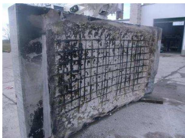
**Bild 99** Brandbeanspruchte Seite des Probekörpers GB1 (Referenzbeton) nach dem Brandversuch
