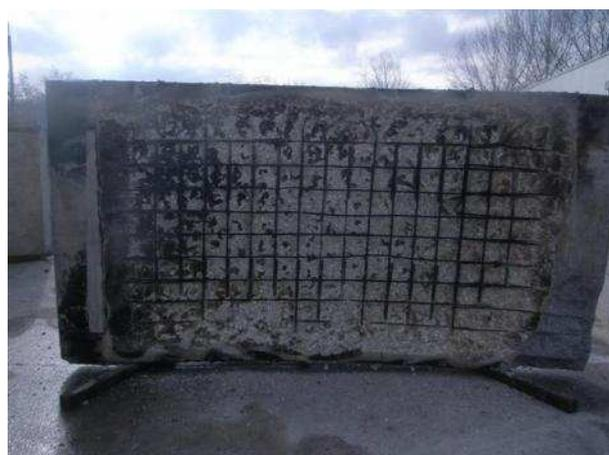
**Bild 101** Brandbeanspruchte Seite des Probekörpers GB1 (Referenzbeton) nach dem Brandversuch
