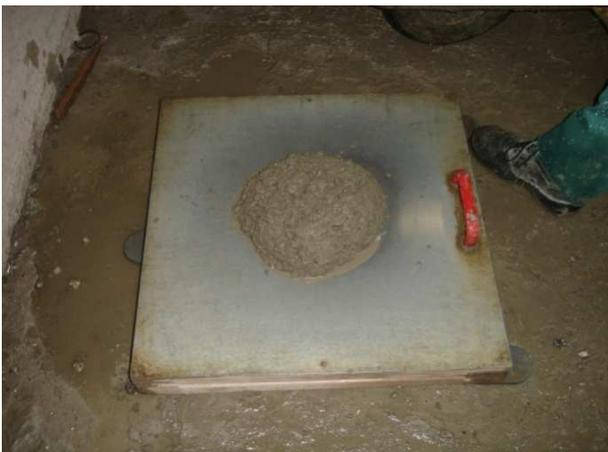
**Bild 182** Beton OG2,  $a_0^8=52,5$  cm, nach Pumpvorgang
