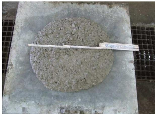
**Bild 166** Beton GL6,  $ao^8=51,0$  cm,  $am^9=46,0$  cm
