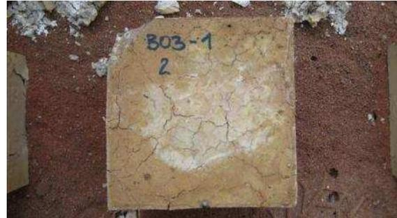
**Bild 17** Prüfkörper B03-1 (2) mit quarzitischen Gesteinskörnungen im ausgekühlten Zustand, drei Tage nach dem Brandversuch
