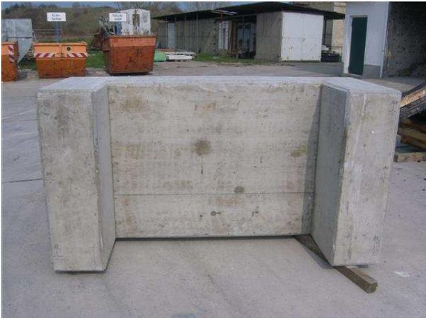
**Bild 135** Probekörper OB1 (Referenzbeton) vor der Brandbeanspruchung
