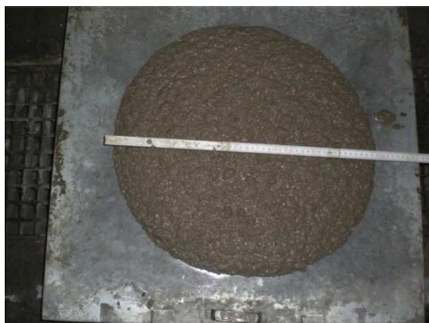
**Bild 170** Beton GL10,  $ao^8=49,5$  cm
