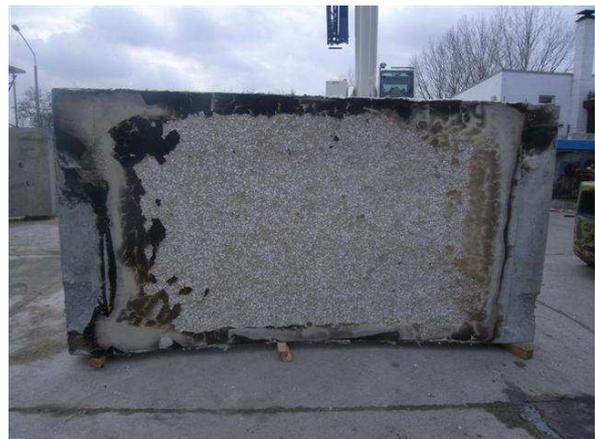
**Bild 68** Probekörper GB2 (Faserbeton mit 2,0 kg/m<sup>3</sup> PP-Fasern) nach der unbelasteten Brandbeanspruchung
