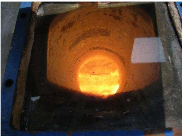
**Bild 139** Blick in den Brandraum während der Prüfung
