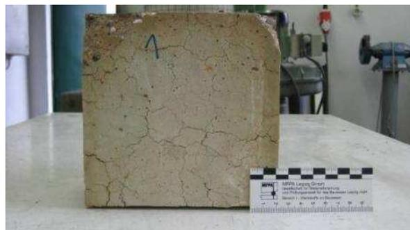
**Bild 21** Prüfkörper B03-2 (1) – Seitenfläche 1 des brandbeanspruchten Kleinprüfkörpers
