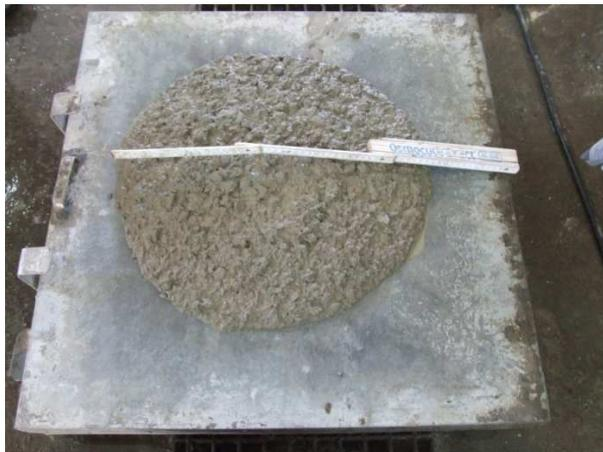
**Bild 167** Beton GL7,  $ao^8=47,5$  cm
