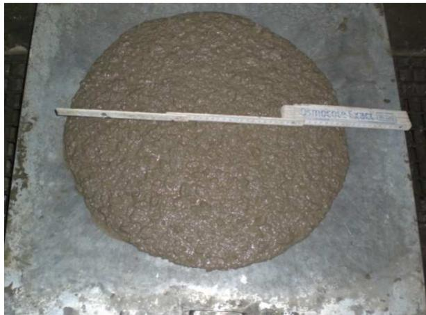
**Bild 177** Beton OL7,  $a_0^{\text{e}}=50,0$  cm
