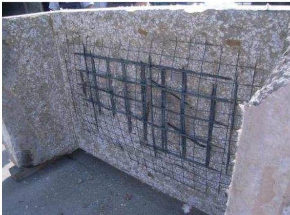
**Bild 76** Probekörper OB1 aus Referenzbeton und mit der N94-Matte nach der Brandbeanspruchung
