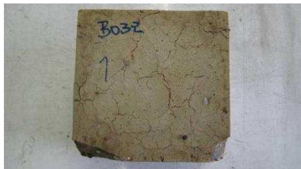
**Bild 20** Prüfkörper B03-2 (1) – Oberfläche des brandbeanspruchten Kleinprüfkörpers
