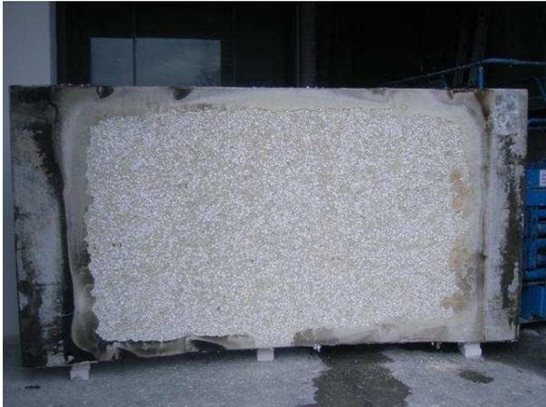
**Bild 131** Brandbeanspruchte Seite des Probekörpers GB4 (Faserbeton 2,0 kg/m<sup>3</sup> PP)
