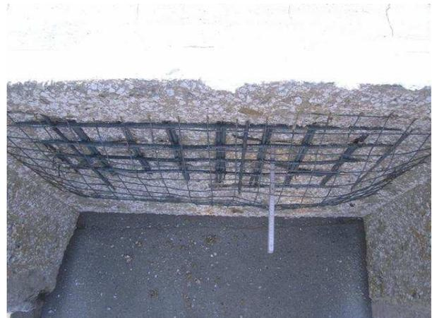
**Bild 146** Detailansicht des Probekörpers nach der Brandbeanspruchung
