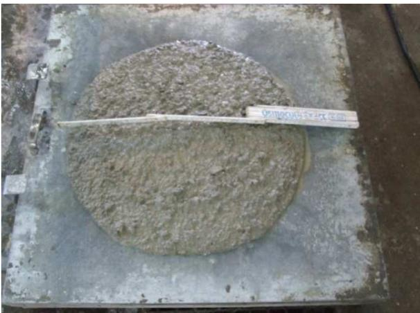
**Bild 165** Beton GL5,  $ao^8=50,0$  cm
