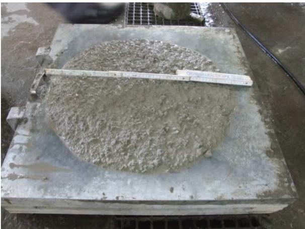
**Bild 163** Beton GL3,  $ao^8=52,5$  cm,  $am^9=53,5$  cm
