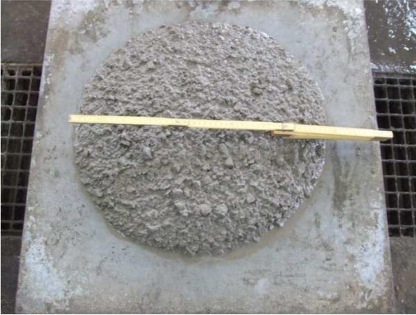
**Bild 161** Beton GL1,  $ao^8=52$  cm,  $am^9=50,0$  cm
