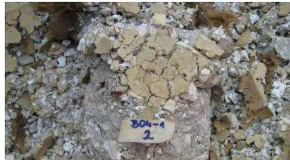
**Bild 18** Prüfkörper B04-1 (2) mit kalzitischen Gesteinskörnungen im ausgekühlten Zustand, drei Tage nach dem Brandversuch
