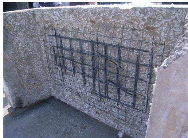
**Bild 144** Probekörper nach der Brandbeanspruchung
