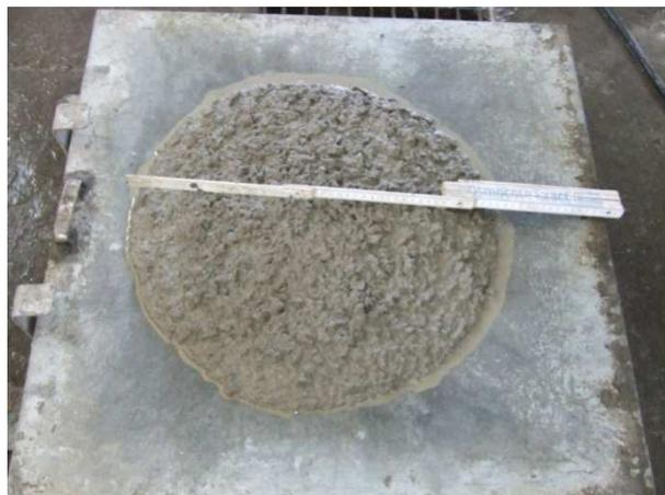
**Bild 168** Beton GL8,  $ao^8=47,0$  cm
