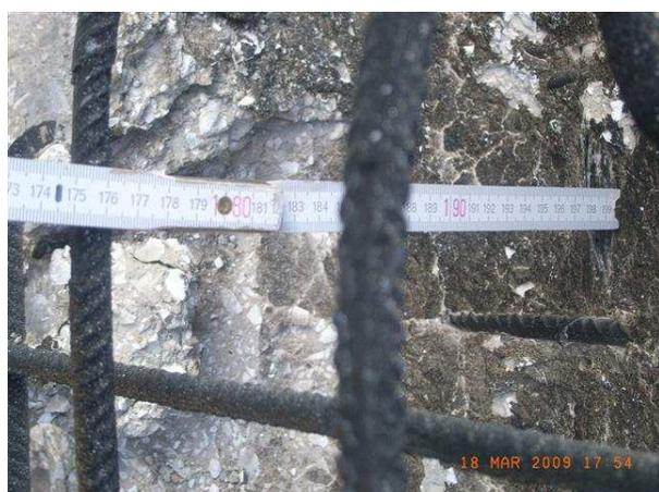
**Bild 121** Detailansicht der brandbeanspruchten Seite am Probekörper GB3 (Referenzbeton)
