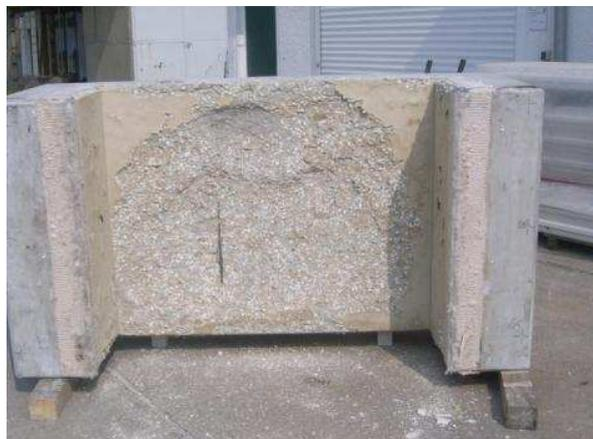
**Bild 79** Probekörper GB4 (Faserbeton) nach der belasteten Brandbeanspruchung
