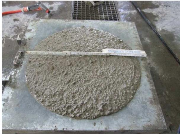
**Bild 162** Beton GL2,  $ao^8=58,0$  cm
