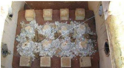
**Bild 16** Blick auf die Probekörper nach der zweiten Prüfung (drei Tage nach dem Brandversuch) - Probekörper mit den kalzitischen Gesteinskörnungen in den beiden mittleren Reihen zu sehen
