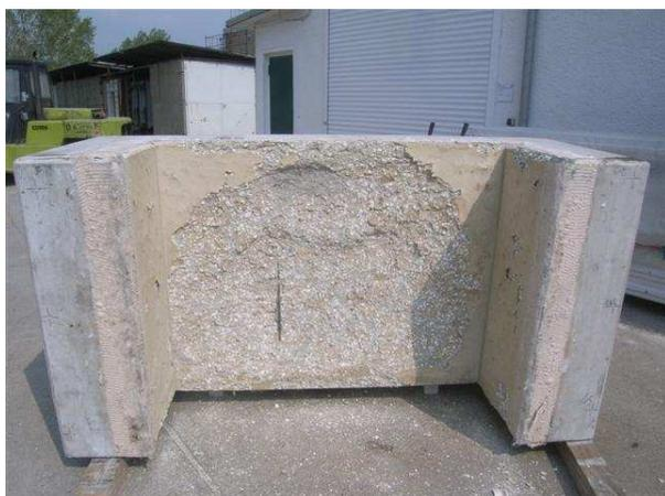
**Bild 153** Brandbeanspruchte Seite des Probekörpers OB2 (Faserbeton 2,0kg/m<sup>3</sup> PP)
