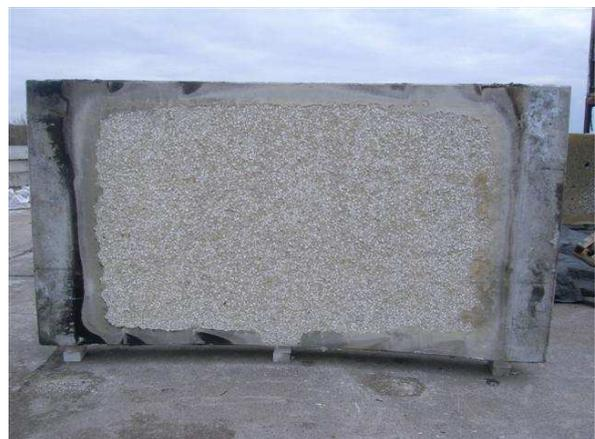
**Bild 70** Probekörper GB4 (Faserbeton mit 2,0 kg/m<sup>3</sup> PP-Fasern) nach der belasteten Brandbeanspruchung
