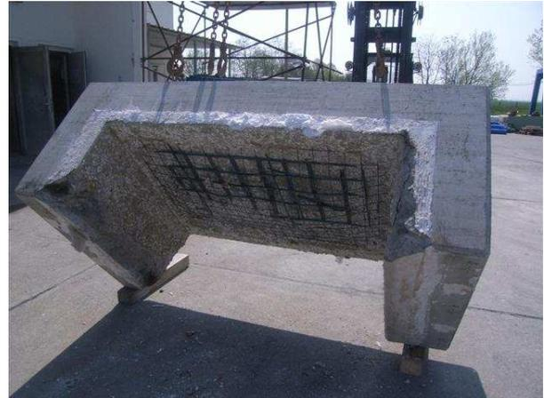
**Bild 142** Probekörper nach der Brandbeanspruchung
