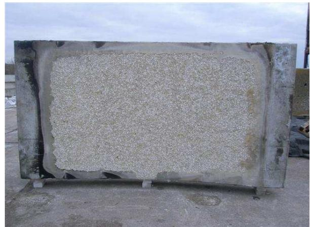
**Bild 134** Brandbeanspruchte Seite des Probekörpers GB4 (Faserbeton 2,0 kg/m<sup>3</sup> PP)
