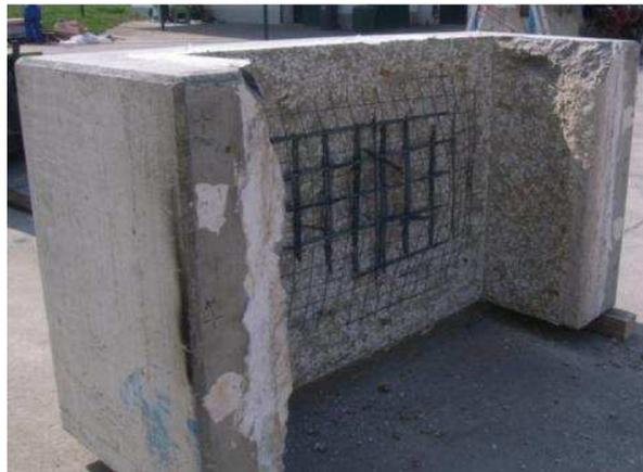
**Bild 77** Probekörper OB1 aus Referenzbeton und mit der N94-Matte nach der Brandbeanspruchung
