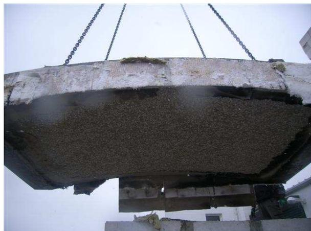
**Bild 130** Abheben des Probekörpers GB4 (Faserbeton 2,0 kg/m<sup>3</sup> PP) vom Tunnelofen nach dem Brandversuch
