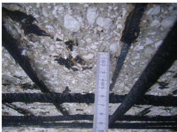
**Bild 100** Detailansicht der brandbeanspruchten Seite des Probekörpers GB1 (Referenzbeton)
