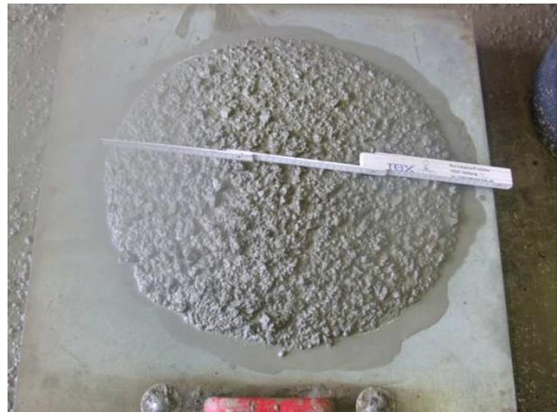
**Bild 188** Beton OG4,  $a_0=53,0$  cm, nach Pumpvorgang
