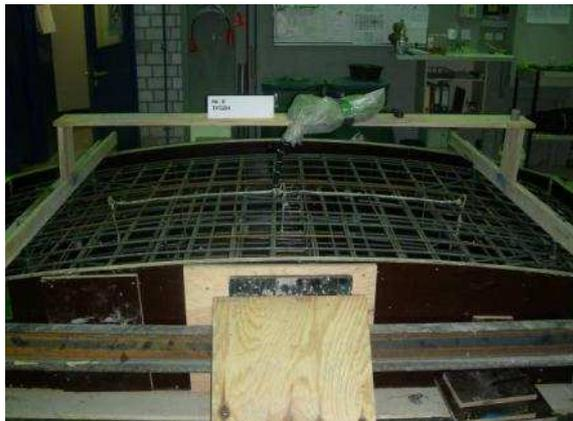
**Bild 31** Schalung der Probekörper für die Tunnelchalensegmente der geschlossenen Bauweise
