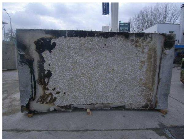
**Bild 109** Brandbeanspruchte Seite des Probekörpers GB2 (Faserbeton 2,0 kg/m<sup>3</sup> PP)
