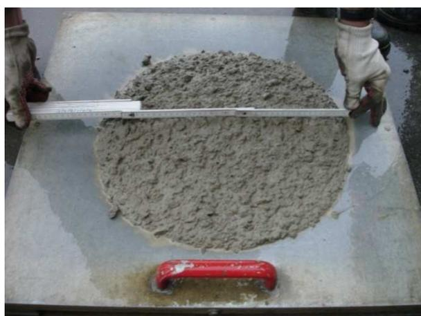
*Fotodokumentation der Konsistenz der Betone für die offene Bauweise im Transportbetonwerk*
