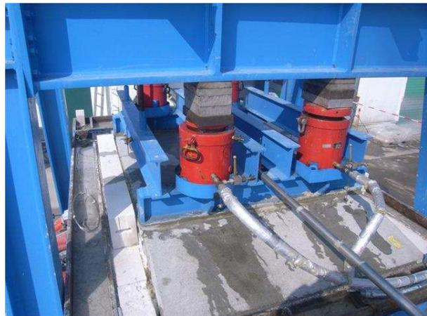
**Bild 128** Blick auf die vertikale Belastungseinrichtung
