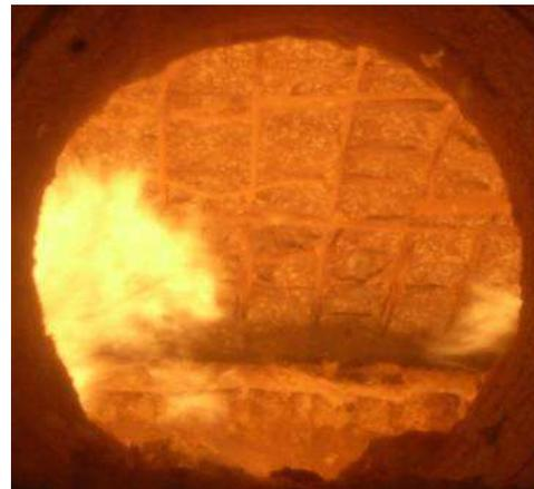
**Bild 45** Blick in den Brandraum - Probekörper GB1 mit freiliegender Bewehrung während der Versuchsdurchführung
