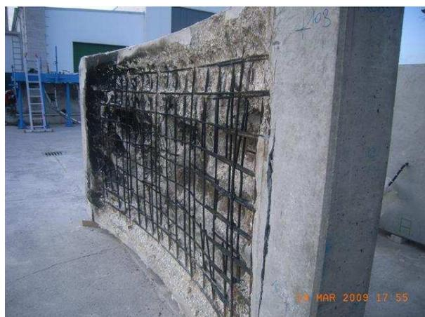
**Bild 123** Detailansicht der brandbeanspruchten Seite am Probekörper GB3 (Referenzbeton)
