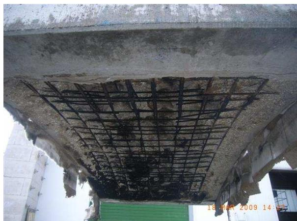
**Bild 119** Probekörper GB3 (Referenzbeton) nach der Prüfung
