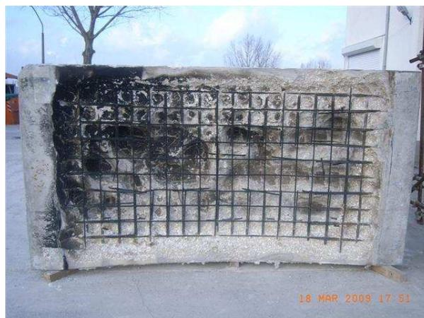
**Bild 120** Probekörper GB3 (Referenzbeton) brandbeanspruchte Seite
