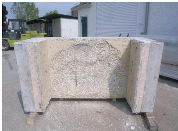
**Bild 152** Brandbeanspruchte Seite des Probekörpers OB2 (Faserbeton 2,0kg/m<sup>3</sup> PP)
