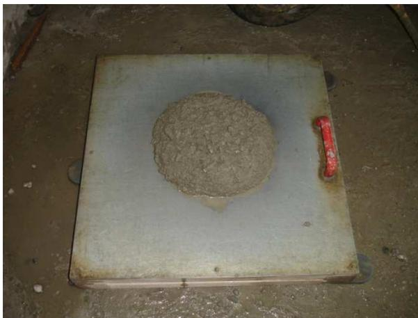
**Bild 184** Beton OG3,  $ao^8=52,5$  cm, nach Pumpvorgang
