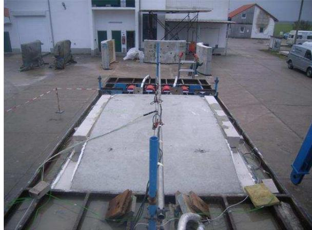
**Bild 103** Probekörper GB2 (Faserbeton 2,0 kg/m<sup>3</sup> PP) auf dem Tunnelofen vor der unbelasteten Tunnelbrandprüfung
