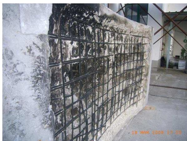
**Bild 122** Detailansicht der brandbeanspruchten Seite am Probekörper GB3 (Referenzbeton)
