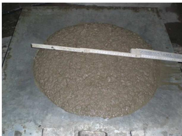
**Bild 169** Beton GL9,  $ao^8=49,5$  cm
