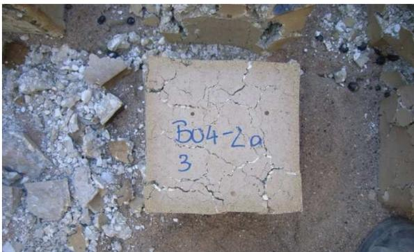
**Bild 24** Probekörper B04-2a (3) - Schadensaufnahme nach der Brandbeanspruchung
