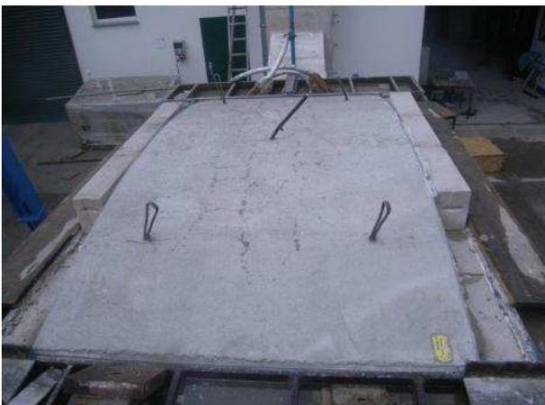
**Bild 94** Probekörper GB1 (Referenzbeton) auf dem Tunnelofen nach Beendigung der Brandbeanspruchung
