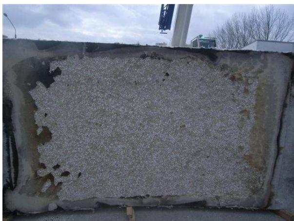
**Bild 112** Brandbeanspruchte Seite des Probekörpers GB2 (Faserbeton 2,0 kg/m<sup>3</sup> PP)
