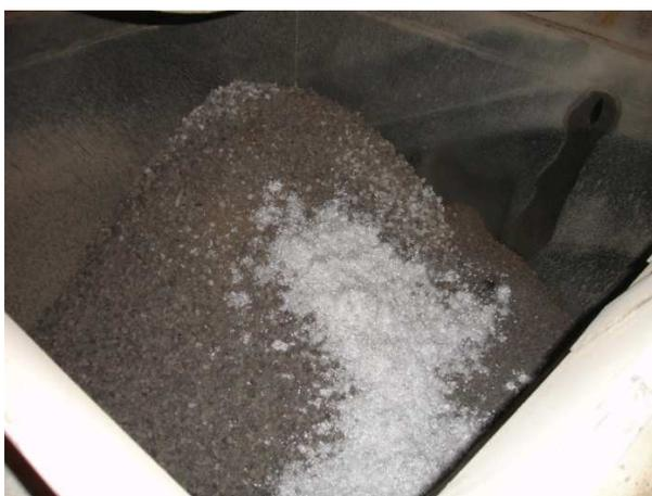
**Bild 185** PP-Faserzugabe auf die Trockenmischung bei allen Betonen mit Ausnahme von Beton OG3
