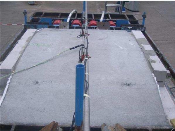
**Bild 104** Probekörper GB2 (Faserbeton 2,0 kg/m<sup>3</sup> PP) auf dem Tunnelofen vor der unbelasteten Tunnelbrandprüfung
