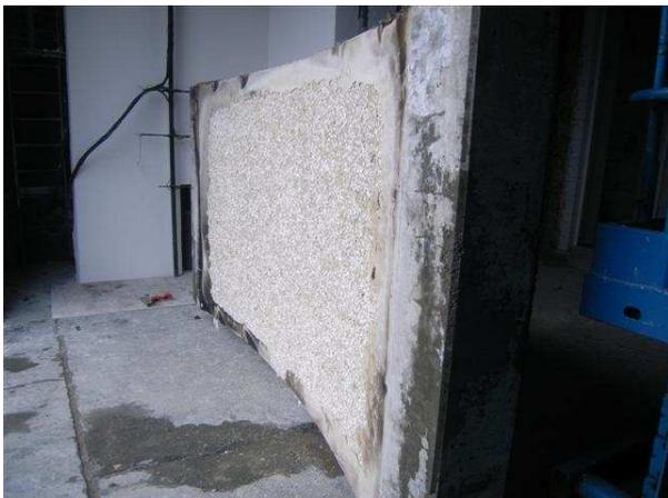
**Bild 133** Brandbeanspruchte Seite des Probekörpers GB4 (Faserbeton 2,0 kg/m<sup>3</sup> PP)
