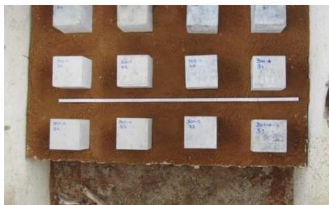
**Bild 5** Anordnung der Probekörper zur Prüfung
