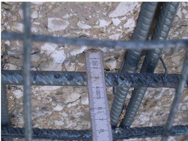
**Bild 145** Detailansicht des Probekörpers nach der Brandbeanspruchung
