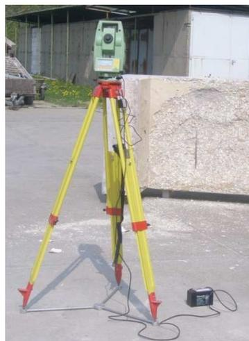
**Bild 55** Tachymeter: verwendetes geodätisches Messinstrument zur Bestimmung der Abplatztiefen
