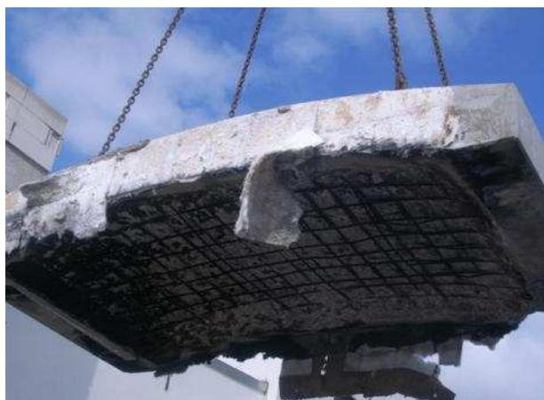
**Bild 96** Probekörper GB1 (Referenzbeton) beim Abheben vom Tunnelofen
