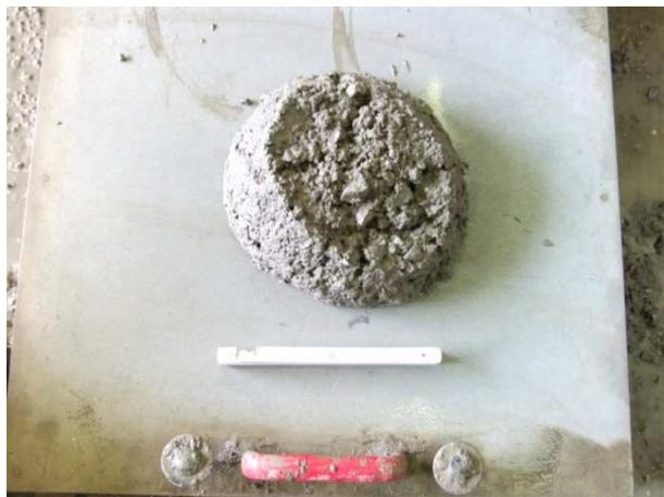
**Bild 190** Beton OG5,  $a_0=48,5\text{cm}$ , nach Pumpvorgang
