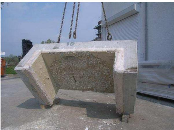
**Bild 151** Brandbeanspruchte Seite des Probekörpers OB2 (Faserbeton 2,0kg/m<sup>3</sup> PP)
