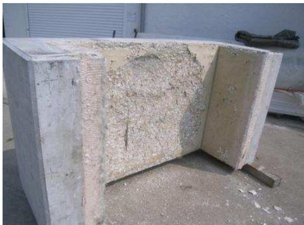
**Bild 78** Probekörper GB2 (Faserbeton) nach der unbelasteten Brandbeanspruchung
