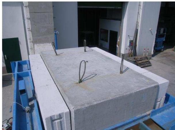
**Bild 140** Außenseite des Probekörpers OB1 (Referenzbeton) nach der Brandbeanspruchung
