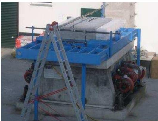
**Bild 32** Belastungseinrichtung für die Durchführung der Versuche an den Rahmenecken
