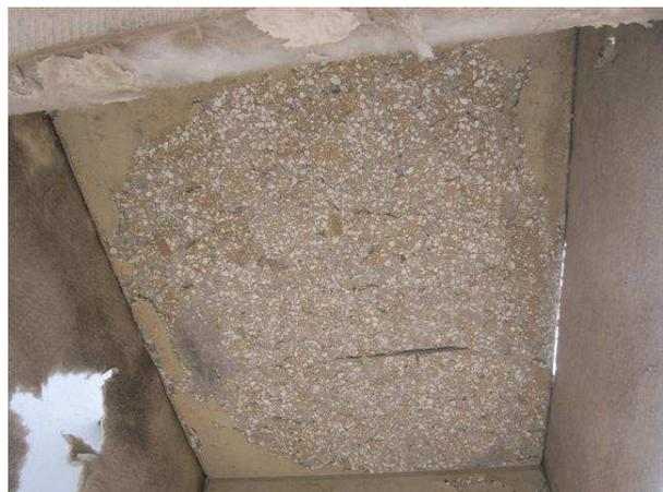
**Bild 150** Brandbeanspruchte Seite des Probekörpers OB2 (Faserbeton 2,0kg/m<sup>3</sup> PP)
