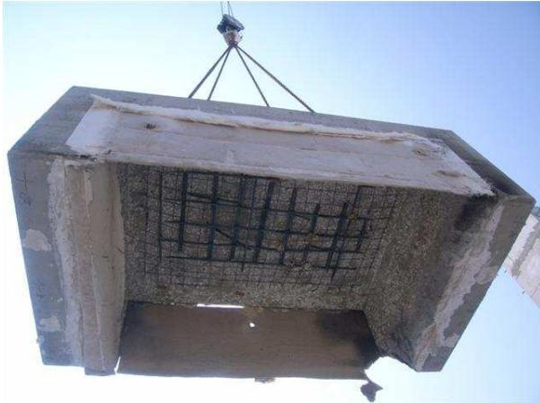
**Bild 141** Abheben des Probekörpers nach der Prüfung vom Tunnelofen
