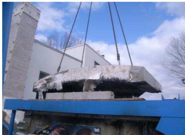
**Bild 95** Probekörper GB1 (Referenzbeton) nach der Brandbeanspruchung beim Abheben vom Tunnelofen
