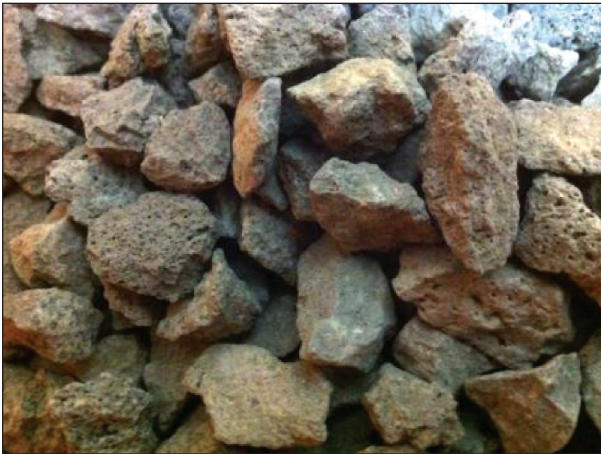
Bild 58: Basaltlava mit hoher Porosität (Kornmaterial) [BASALTLAVA, 2012]
