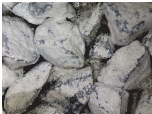
Bild 73: \text{TiO}_2 -umhüllte Gesteinskörner vor einer 5-stündigen Polierbeanspruchung in der ARTE
