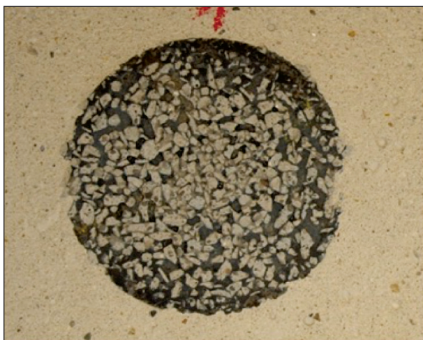
Bild 81: Bohrkern aus der Einbaustrecke nach 300 Minuten Polierdauer
