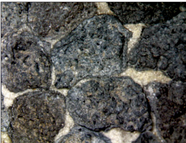
Bild 61: Basaltlava nach der Beanspruchung im Polierversuch
