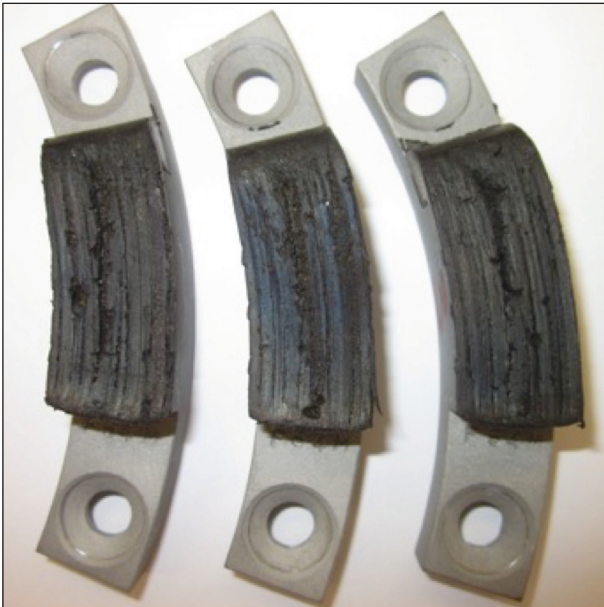
Bild 80: Verschlossener Gleitschuh nach Messungen mit der Wehner/Schulze auf einem abgestreuten Probekörper
