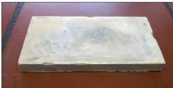
Bild 25: Probekörper (100 x 50 x 10 mm 3 ) zur Überprüfung der photokatalytischen Wirksamkeit
