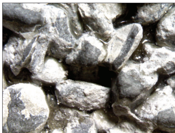
Bild 74: \text{TiO}_2 -umhüllte Gesteinskörner nach einer 5-stündigen Polierbeanspruchung in der ARTE
