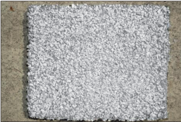
Bild 28: Abgestreute Asphaltplatten mit \text{TiO}_2 -haltigen Körnern
