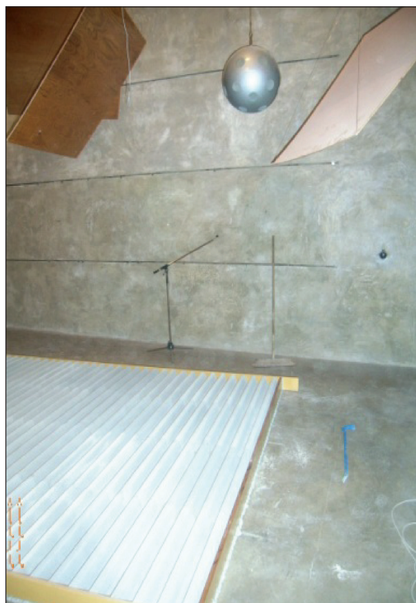
Bild 3.8: Einer der beiden Prüfkörper der Lärmschutzwand im Hallraum der MFPA Leipzig GmbH
