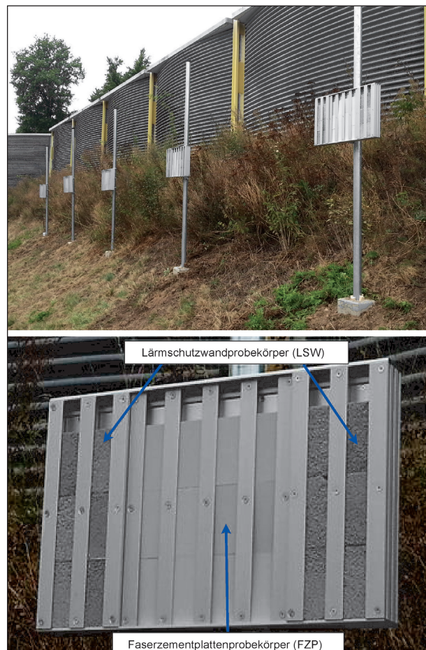
Bild 4.6: Gestelle zur Aufnahme der Prüfkörper für die Freibewitterung (oben) und Aufteilung der verwendeten Prüfkörper in den Gestellen (unten)
