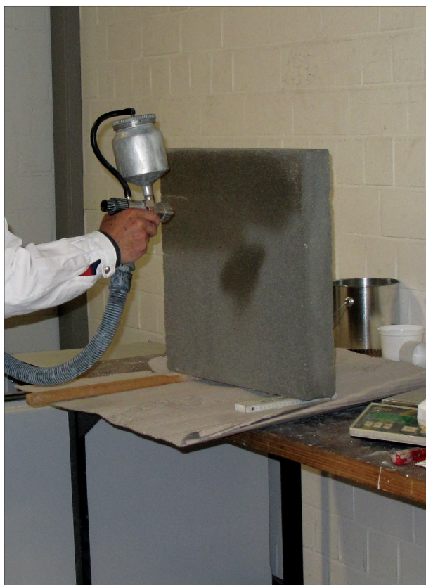
Bild 3.1: Beschichtung der Lärmschutzwand-Prüfkörper
