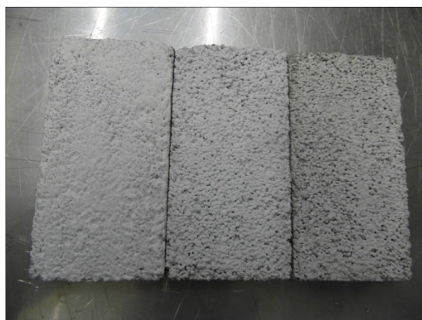
Bild 53: Erscheinungsbild der Prüfkörper nach ISO 22197 nach 24 Monaten Bewitterung. Von Links: Referenz (unbewittert), Prüfkörper aus der Kontrollfläche, Prüfkörper aus der Versuchsfläche.
