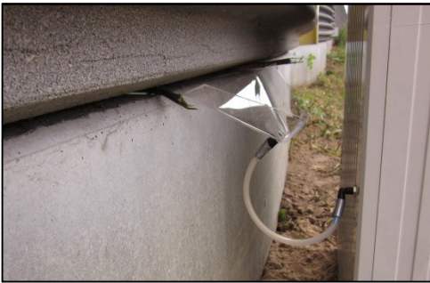
Abb. 2.16 Erste Trichterkonstruktion (0,3 m)
