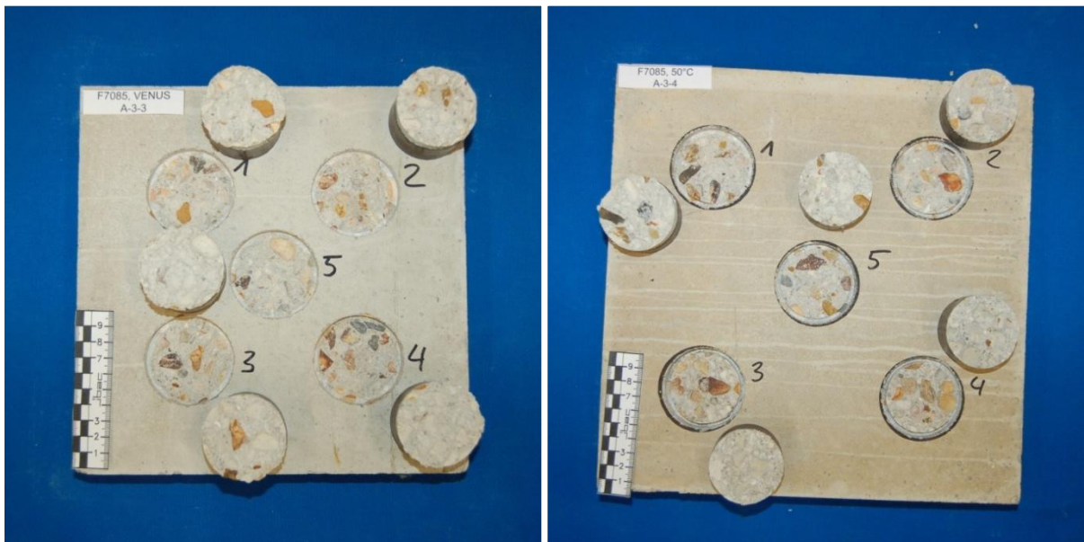
Bild A8: Probekörper A3-BEW365 (links) und A3-REF365 (rechts) nach der Bewitterung bzw. Referenzlagerung sowie nach dem Abreißversuch
