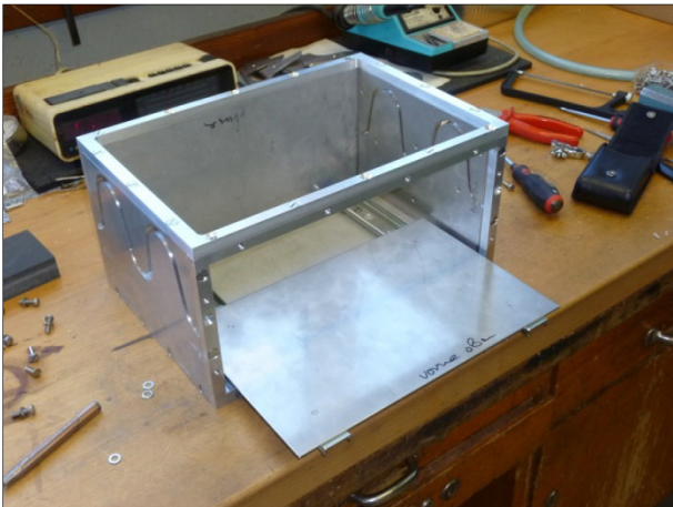
Bild 23: Probenraum der Messzelle für reale Schallschutzwand-Prüfkörper.
