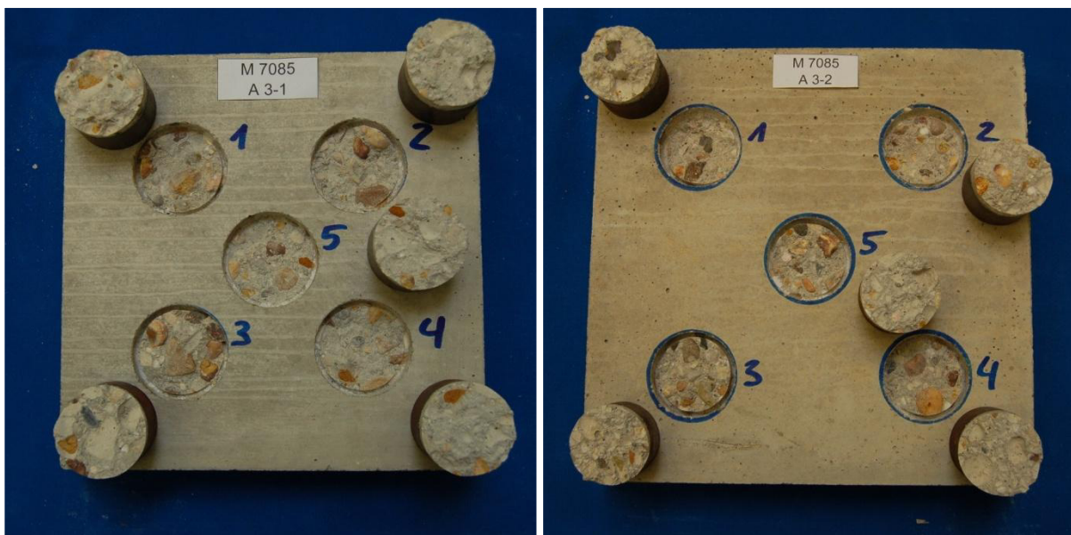
Bild A7: Probekörper A3-BEW180 (links) und A3-REF180 (rechts) nach der Bewitterung bzw. Referenzlagerung sowie nach dem Abreißversuch
