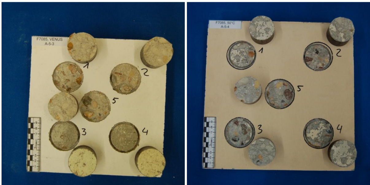
Bild A18: Probekörper A5-BEW365 (links) und A5-REF365 (rechts) nach der Bewitterung bzw. Referenzlagerung sowie nach dem Abreißversuch
