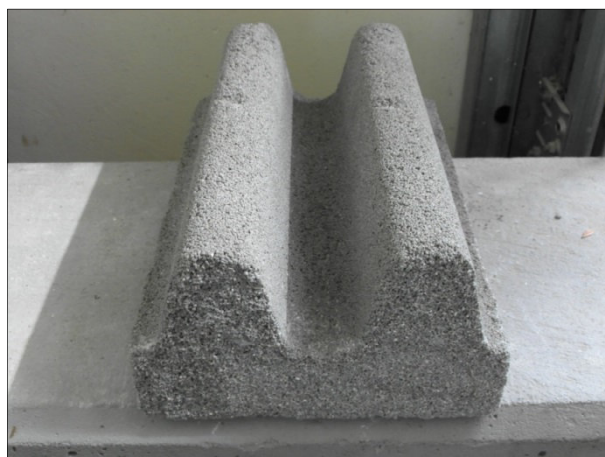
Bild 13: Schallschutzwand-Prüfkörper zugeschnitten für die Messung in der Messzelle.
