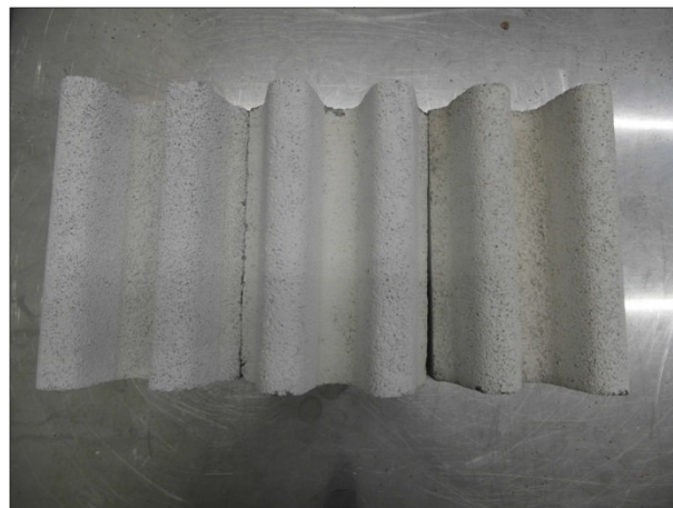
Bild 54: Erscheinungsbild realer Schallschutzwand-Prüfkörper nach 24 Monaten Bewitterung. Von Links: Referenz (unbewittert), Prüfkörper aus der Kontrollfläche, Prüfkörper aus der Versuchsfläche.
