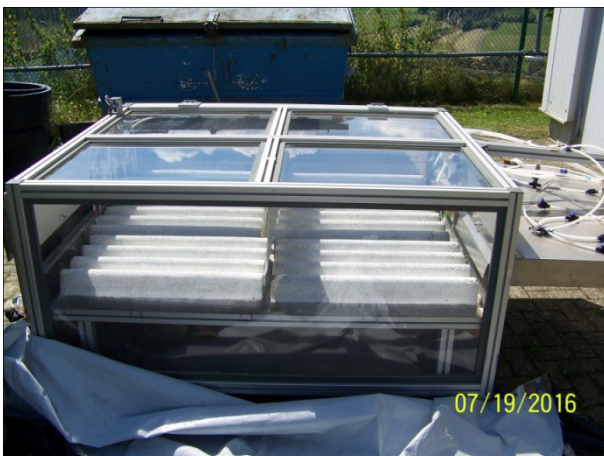
Bild 30: Technikums-Messkammer bestückt mit großen Schallschutzwand-Prüfkörpern.
