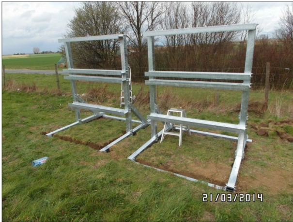
Bild 28: Gestelle für die Freilandbewitterung nach Aufbau auf der Versuchsfläche an der BAB 61.
