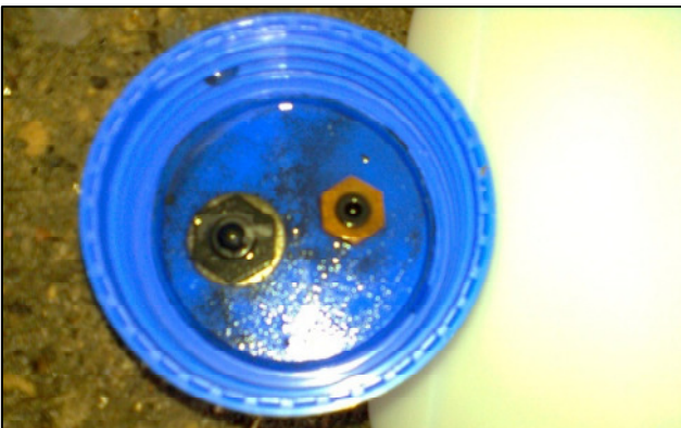
Abb. 2.22 Verschmutzter optischer Sensor (links im Bild) auf Grund hoher Staubbelastung an der Autobahn
