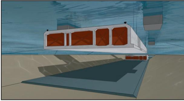
**Bild 10:** Absenkvorgang eines Elementes auf das Fundamentbett
