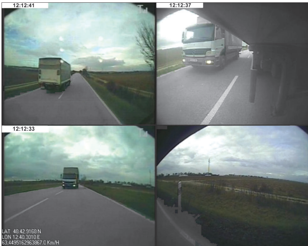
Bild 42: Beispielbilder der am Lang-Lkw angebrachten Kameras. Links oben Frontkamera, links unten Heckkamera, rechts Seitenkameras (Spedition A)
