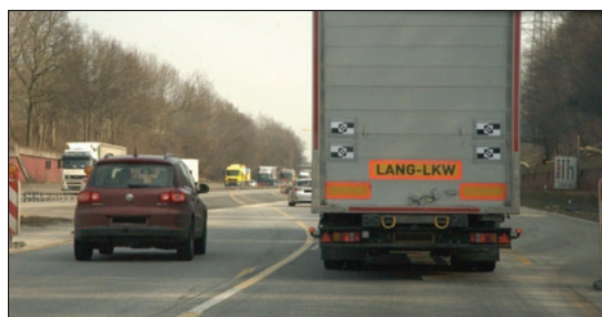
Bild 40: Fahrt eines Lang-Lkw durch eine Überleitung
