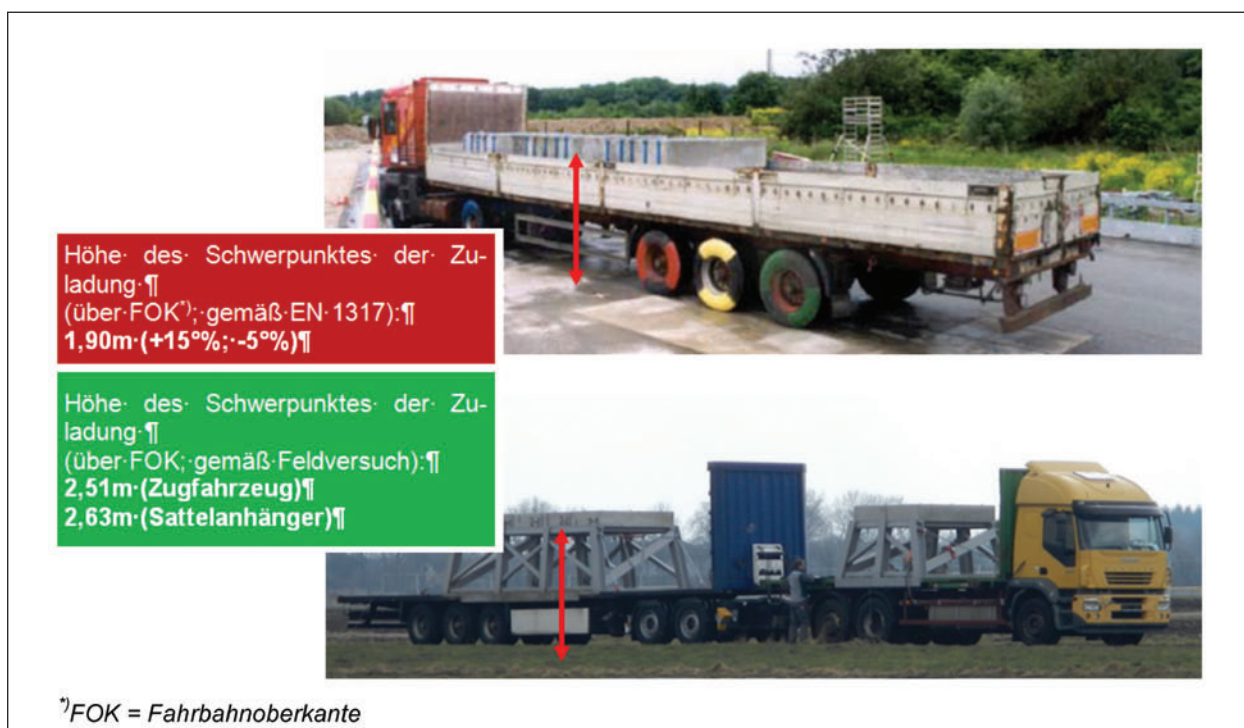
Bild 29: Beladungsszenarien der Prüffahrzeuge gemäß DIN EN 1317 (oben) und für Lang-Lkw aus dem Feldversuch (unten) im Vergleich
