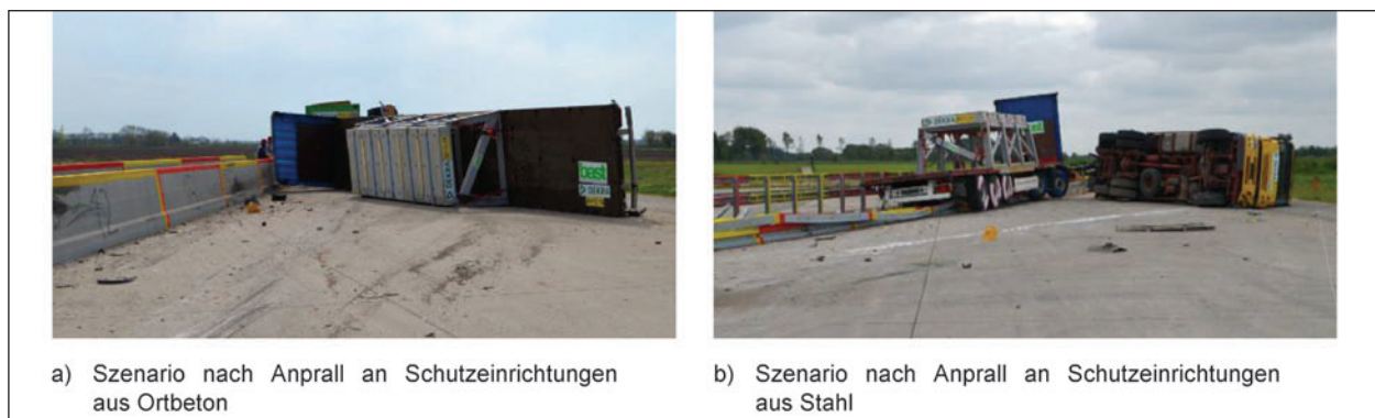
Bild 30: Endposition des Lang-Lkw nach Anprall
