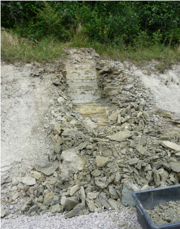
Bild 3 / A-7: Entnahmestelle 2 (ca. 1+325 Bau-km): Mergel bis Mergelstein; nach Baggeraushub bis Oberkante Kalksteinbank; Entnahme von Brocken
