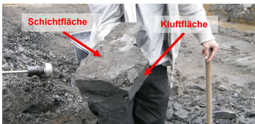
Bild 8 / A-2: Brocken, der mit Pickel herausgelöst wurde
