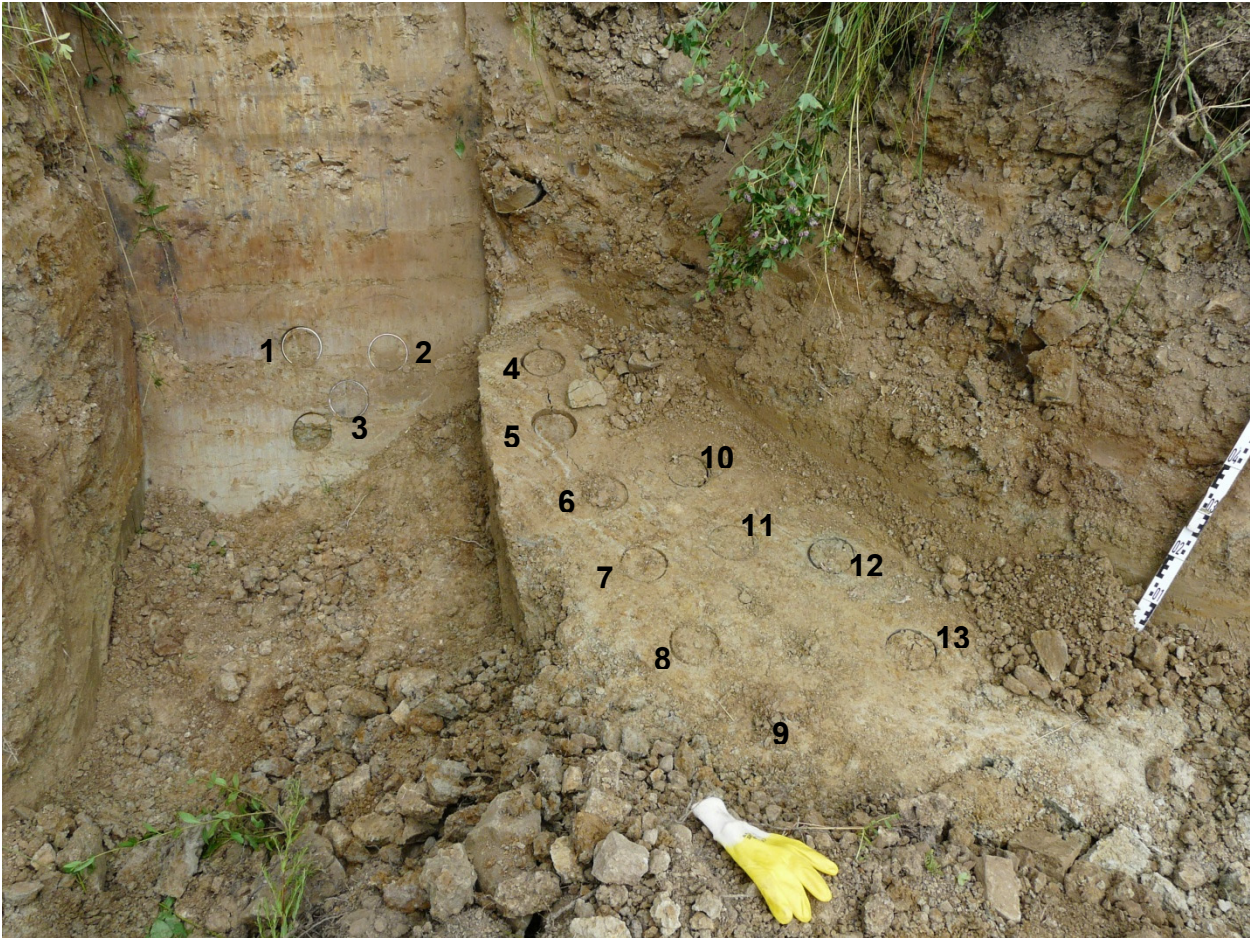
Bild 8 / A-7: Entnahmestelle 3 nach Einschlagen von 13 Entnahmezylindern
