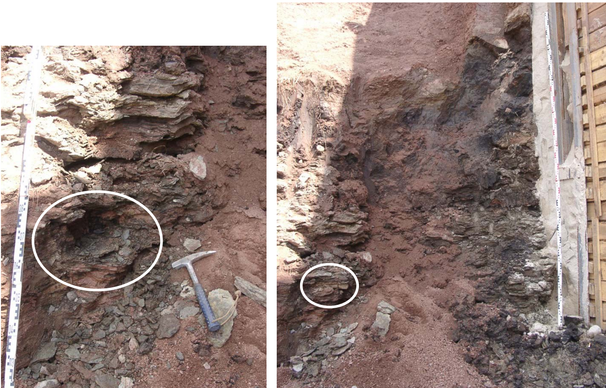
Bild 8 / A-6: Entnahmestelle A.2 (Brocken): dunkelgrauer, plattiger Zechsteindolomit
