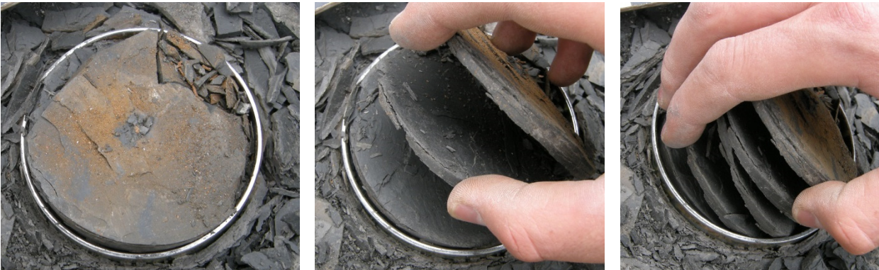
Bild 10 / A-2: Entnahmezylinder nach Einschlagen in Boden: durch Schlägeinwirkung bei Einschlagen bricht Probe scheibenartig, Probenstruktur wird zerstört, d.h. Probeentnahme mit Entnahmezylinder nicht sinnvoll
