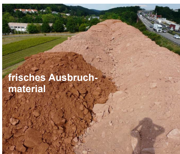
Bild 5 / A-5: oben: Probenlager; unten: frisches Ausbruchmaterial – Sammeln ausreichend großer Brocken
