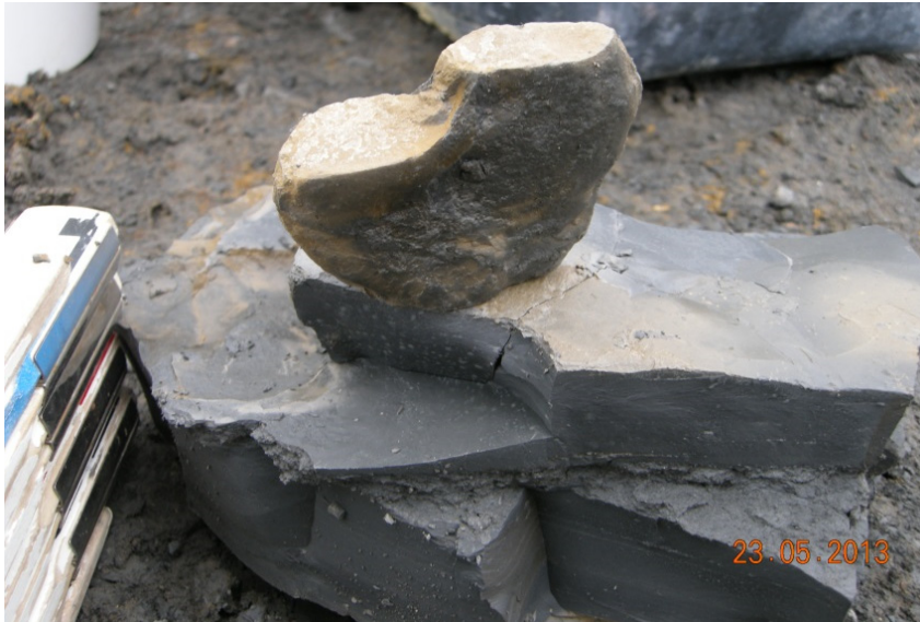
Bild 12 / A-2: Besonderheiten: Eisen-Karbonatknollen in Kieskorngöße, z.T mehrere sich horizontal erstreckende Lagen (Lagendicke im Dezimeterbereich): härter/fester als Opalinuston
