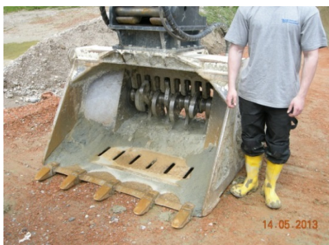
Bild 3 / A-1: Baggerschaufel mit Fräse zum Zerkleinern der Tonbrocken zur Weiterverarbeitung
