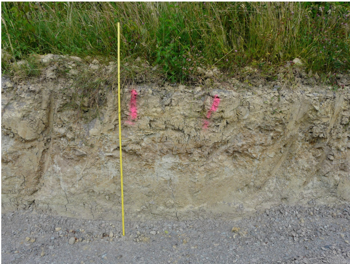
Bild 5 / A-7: Entnahmestelle 3 (ca. 2+130 Bau-km): Mergel (halbfeste bis feste Tone); vor Baggeraushub
