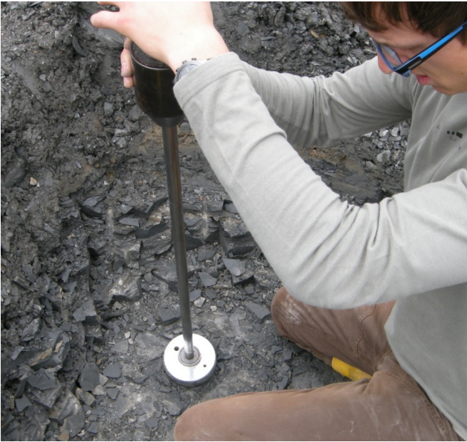
Bild 9 / A-2: Einschlagen Entnahmezylinder: Entnahmegesetz mit Stange und Fallgewicht und zusätzlich Beschleunigung per Hand auf Fallgewicht, wobei >100 Schläge für Eindringung 120 mm notwendig waren
