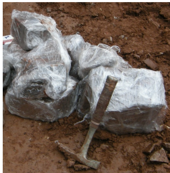
Bild 6 / A-3: Brocken, die in Frischhaltefolie verpackt worden sind (und im Anschluss in Plastiktüte oder Eimer luftdicht verschlossen worden sind)
