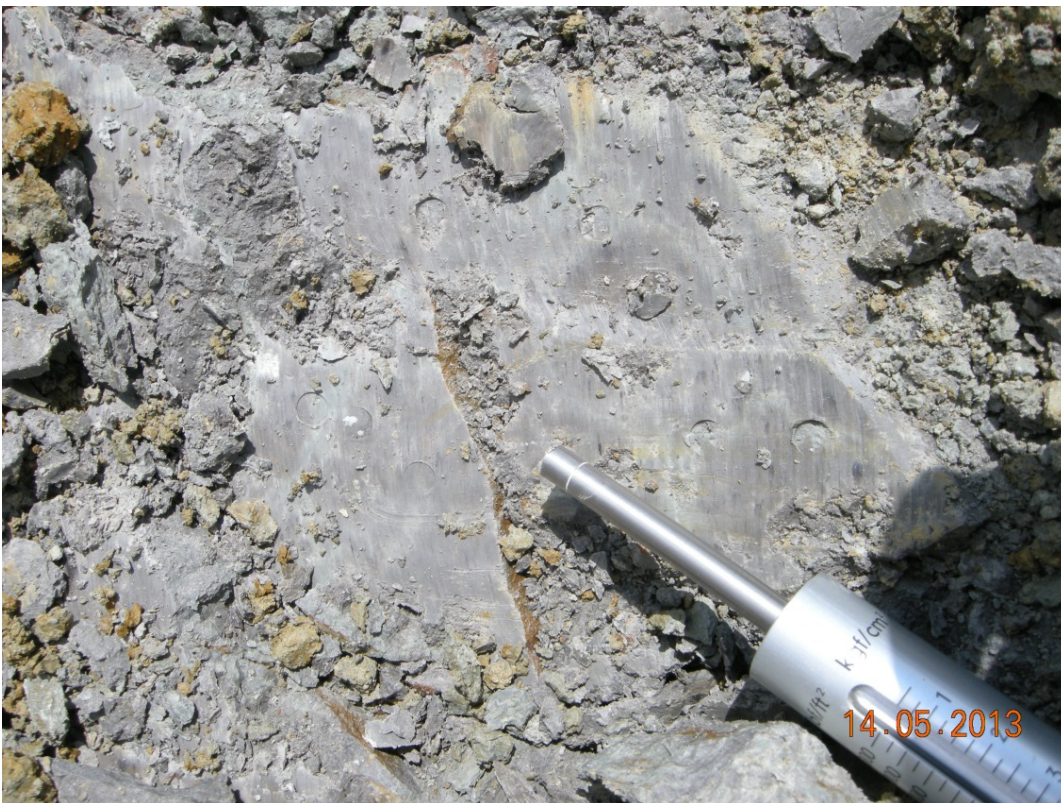
Bild 9 / A-1: Taschenpenetrometer: keine Eindringung möglich
