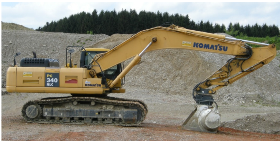
Bild 2 / A-1: Abbauwerkzeug zum Lösen: Bagger (gemäß Aussage Grubenleiter lösen ohne Probleme möglich, könnte auch mit kleinerem Bagger gelöst werden)
