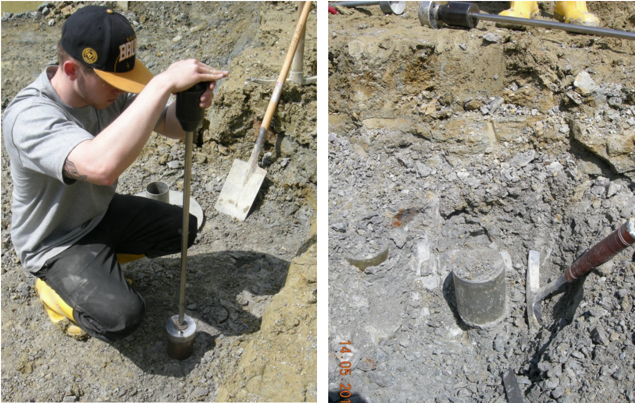
Bild 8 / A-1: links: Einschlagen Entnahmezylinder mit Entnahmegerät mit Stange und Fallgewicht; rechts: ausgegrabener Entnahmezylinder
