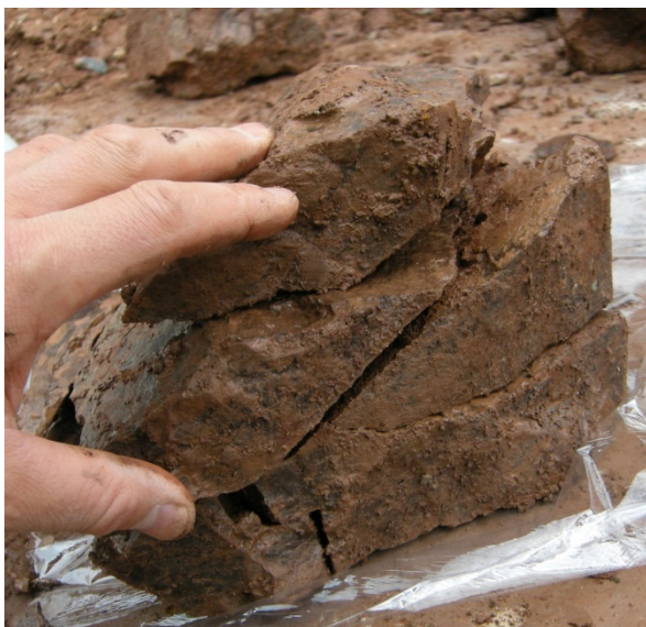
Bild 5 / A-3: Herausgelöster Gesteinsbrocken, der an Trennflächen bei geringer Beanspruchung in kleinere Stücke zerfällt
