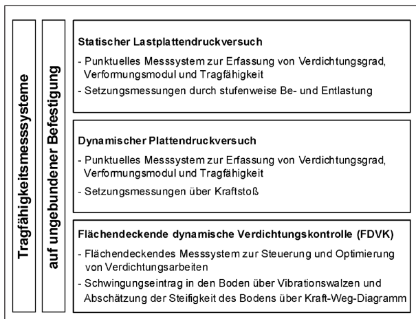
Bild 3-21: Tragfähigkeitsmesssysteme auf ungebundener Befestigung
