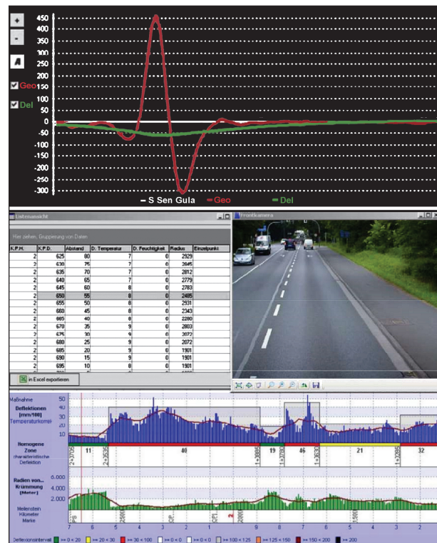
Bild 3-5: oben: Verformungs-Zeit-Kurve (grün) und Reaktion des Geophons (rot); unten: Beispiel für die Visualisierung der Daten [AP Trag Teil B 4, 2012]
