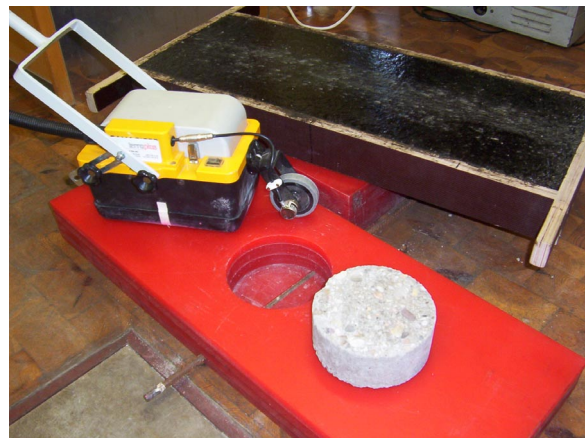
Bild 82. Foto der Messanordnung für Betonzylinder mit Asphalt-Deckplatte. Die Radarwellen durchdringen die Asphaltdeckplatte und den Betonzylinder und werden am darunterliegenden Bewehrungsbügel reflektiert.
