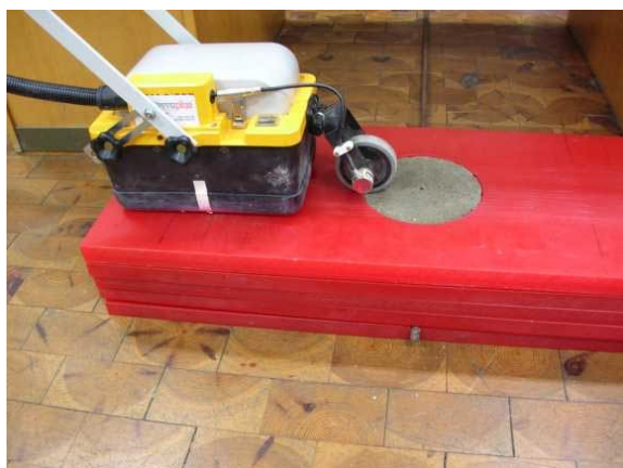
Bild 78. Radar-Messung der Betonzylinder.
