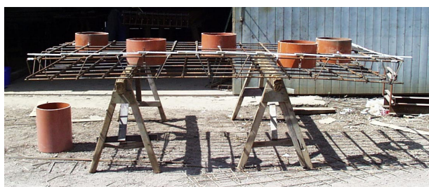
Bild 60. Der Bewehrungskorb mit den Kunststoffrohren für die Präparation der Chloridnester.
