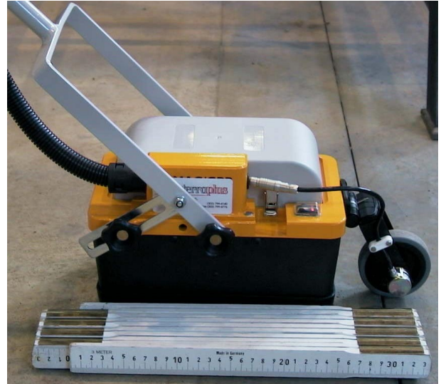
Bild 24. Die 1 GHz-Antenne des Geo-Radar-Systems RAMAC/GPR von MALÅ GeoScience.
