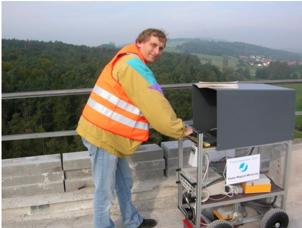
Bild 87. Durchführung der Messung mit dem Radar-Magnet-Messwagen auf der Döllbachtalbrücke.
