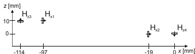
Bild 11. Skizze der Sensorpositionen im Magnet-Messkopf Version 3.
