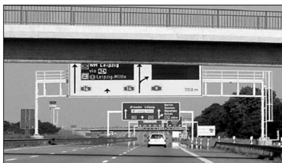
Bild 18: Beispiel für Sichtbehinderung durch eine Brücke
