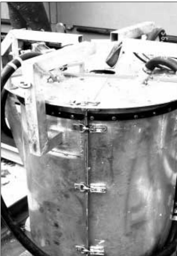
**Bild 3.9:** Mobile Strahlkammer
