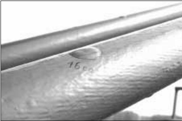
**Bild 3.14:** Angehobene Beschichtung (Blase) auf den Seilen
