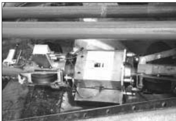
**Bild 3.7:** EMP-Gerät auf dem Seil
