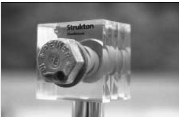
**Bild 1.25:** Injektionsschraube in Plexiglas
