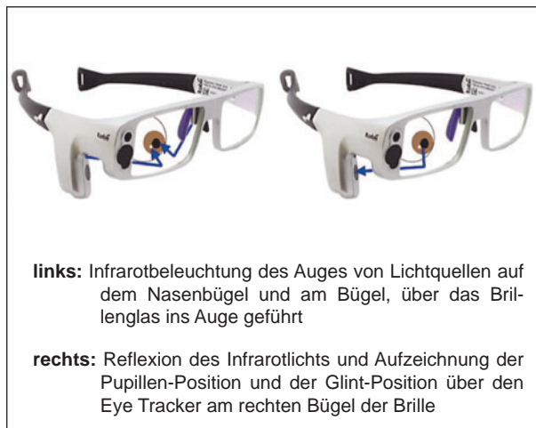
Bild 11: Funktionsweise der Eye Tracking Brille von Tobii Technology [nach REUTER, 2013]
