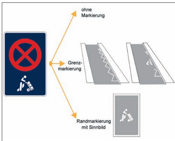
Bild 49: Empfohlene Elemente zur Beschilderung/Markierung der Ladebereiche
