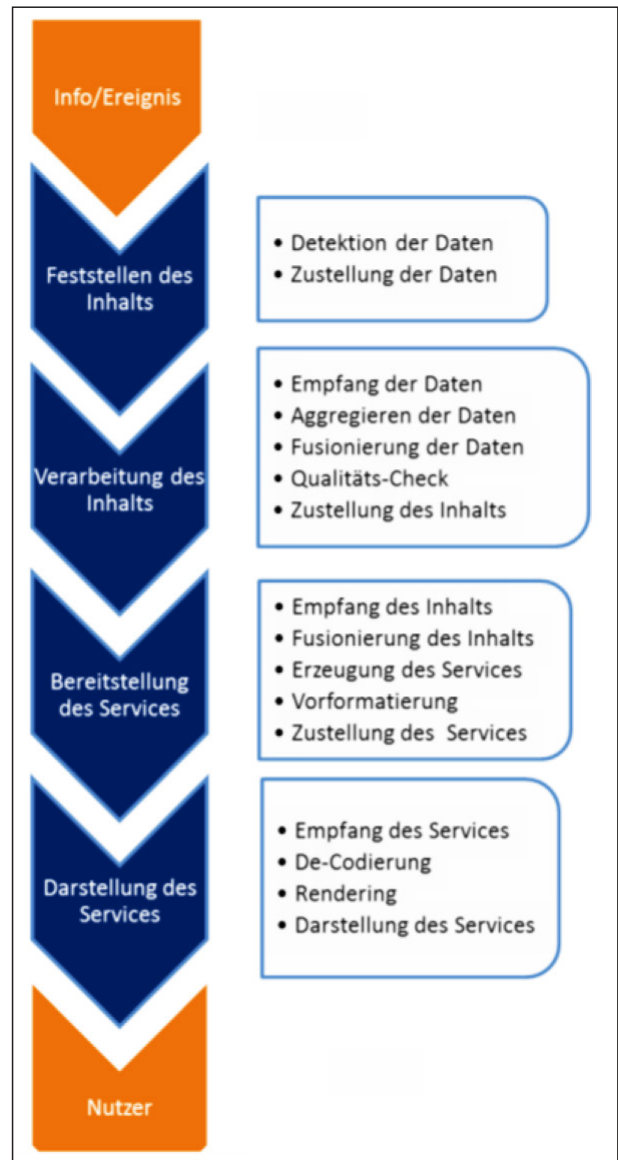
Bild 8: High-level Prozesskette zur Bereitstellung von Verkehrsinformation (TISA, 2012)
