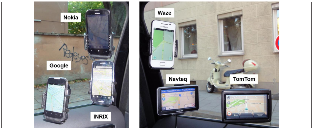
Bild 21: Mobile Endgeräte mit verschiedenen Verkehrsinformationsdiensten montiert an den hinteren Seitenscheiben des Testfahrzeugs.
