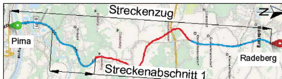
Bild 123: S 177, Streckenzug und betrachteter Streckenabschnitt (rot: nicht fertig gestellter Abschnitt; openstreetmap.org)
