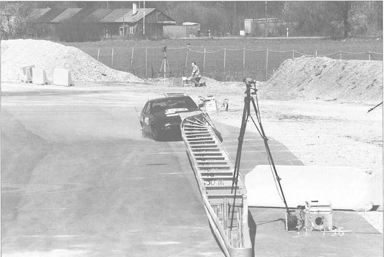
Bild 2: Anprallversuch entsprechend der Prüfung TB 11 mit Porsche 924 an einer Stahlschutzplanke (Foto: Lukas; 96-43-5)
