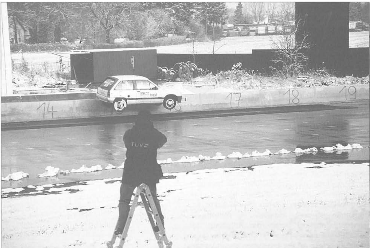
Bild 3: Anprallvorgang entsprechend Prüfung TB 11 mit 10° Anprallwinkel mit einem Opel Corsa an einer Betonschutzwand (Foto: Lukas; 96-349-6)
