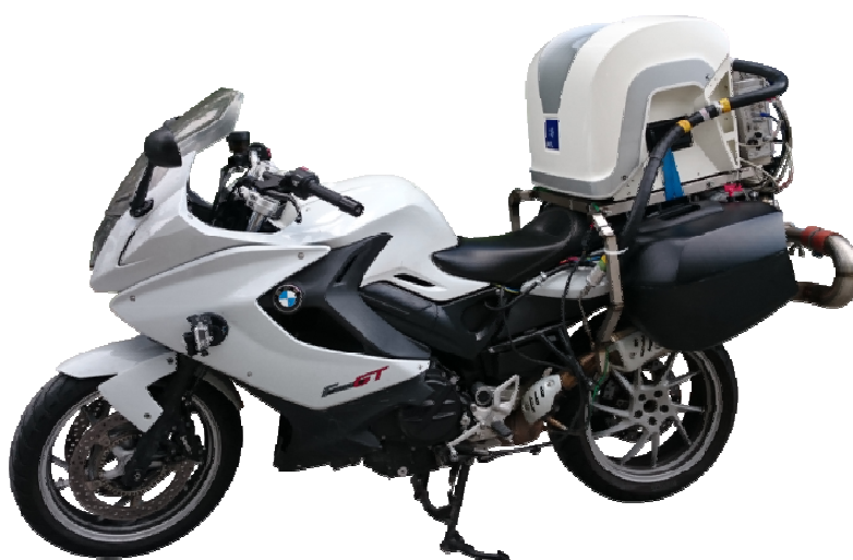
Abbildung 57: Beispielhafter Versuchsaufbau eines vollständigen PEMS auf einem BMW F800GT Motorrad
