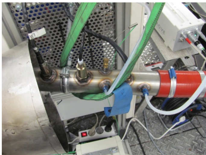
Abbildung 63: Sensoranordnung im Abgasrohr
