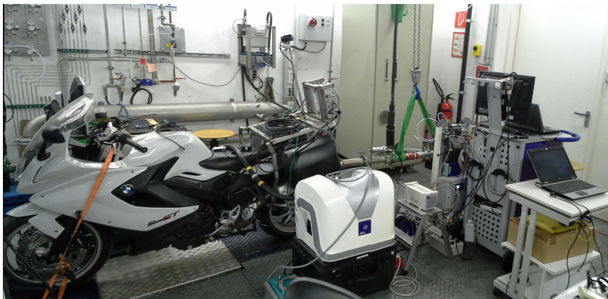
Abbildung 4: Messaufbau am Rollenprüfstand mit PEMS, FTIR, PLUtron und CVS Anlage inklusive Abgas-Analysator.
