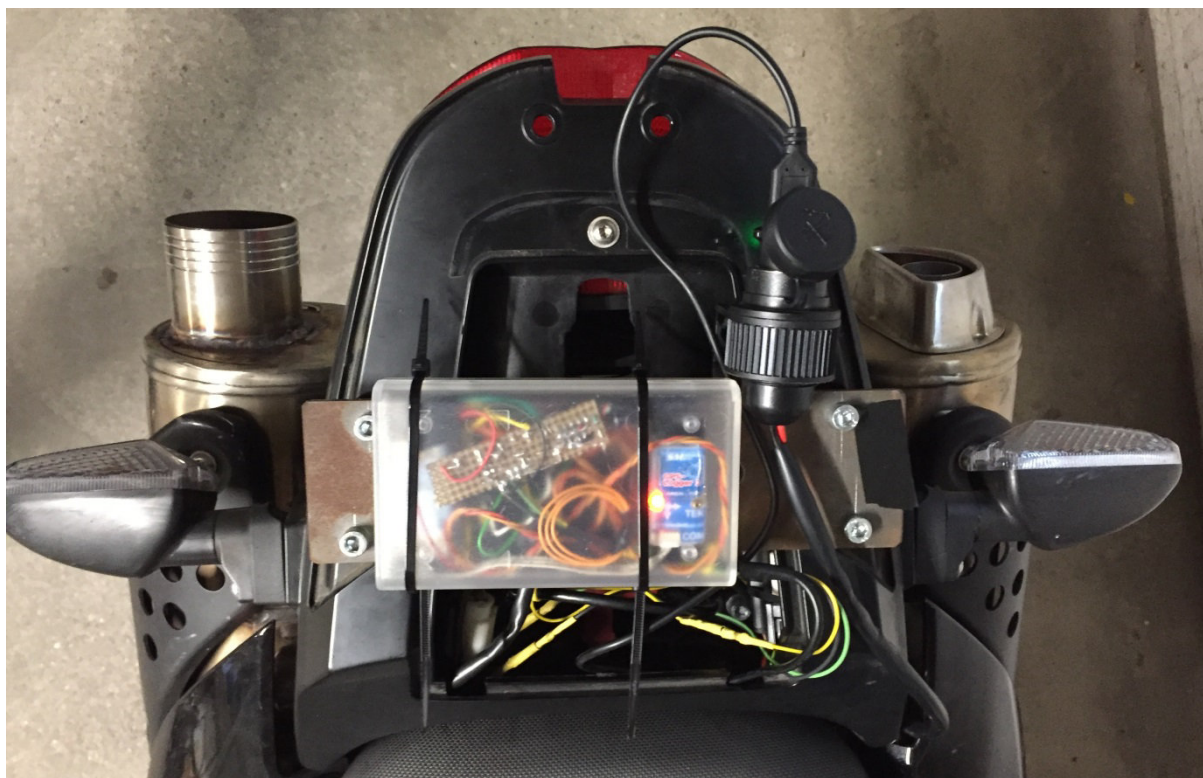
Abbildung 7: GPS-Logger mit zusätzlichen Anschlüssen für Drehzahlmessung und weitere analoge Eingänge auf einem BMW G650 GS Motorrad.
