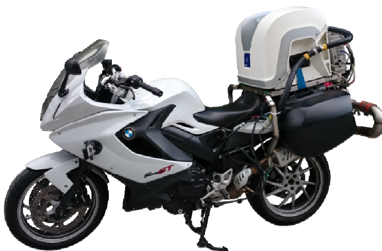
Abbildung 62: Vollständiger Aufbau eines PEMS auf einem BMW F800GT Motorrad
