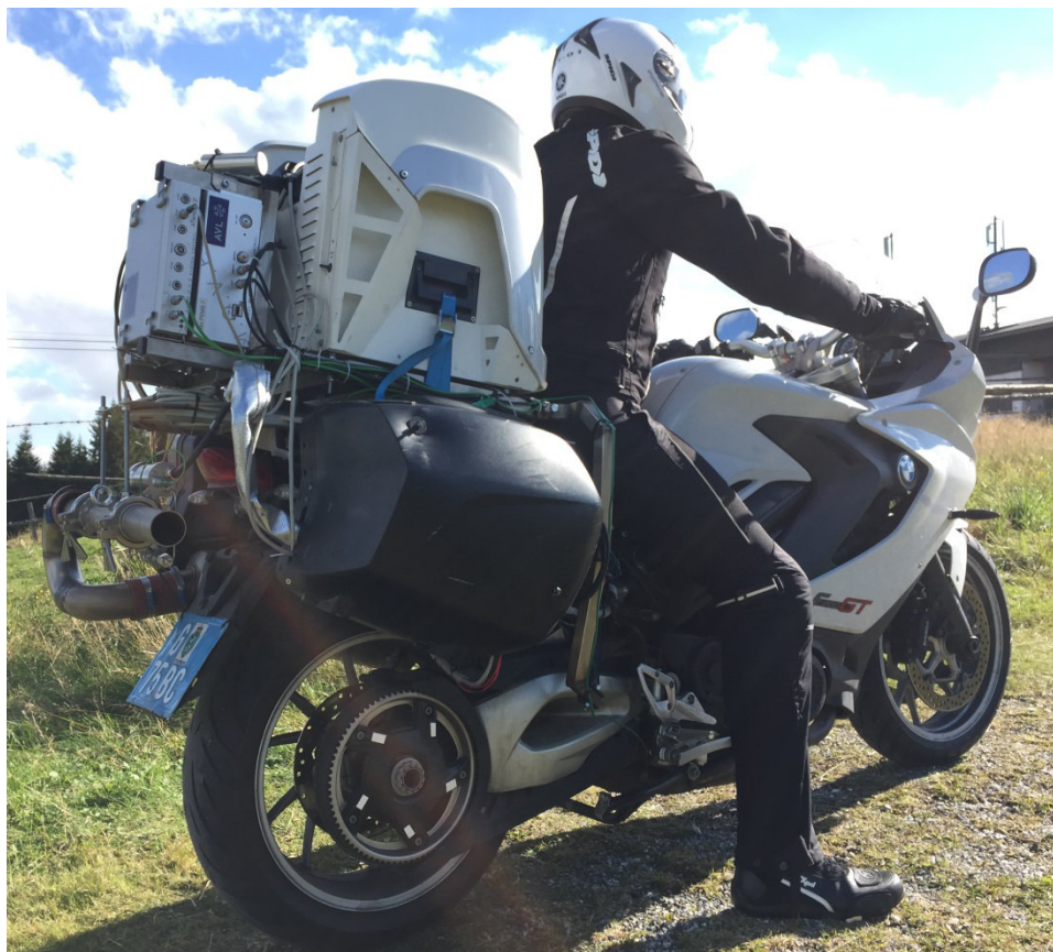
Abbildung 6: Emissions- und Fahrdynamik-Messungen mit einem BMW F800 GT Motorrad.
