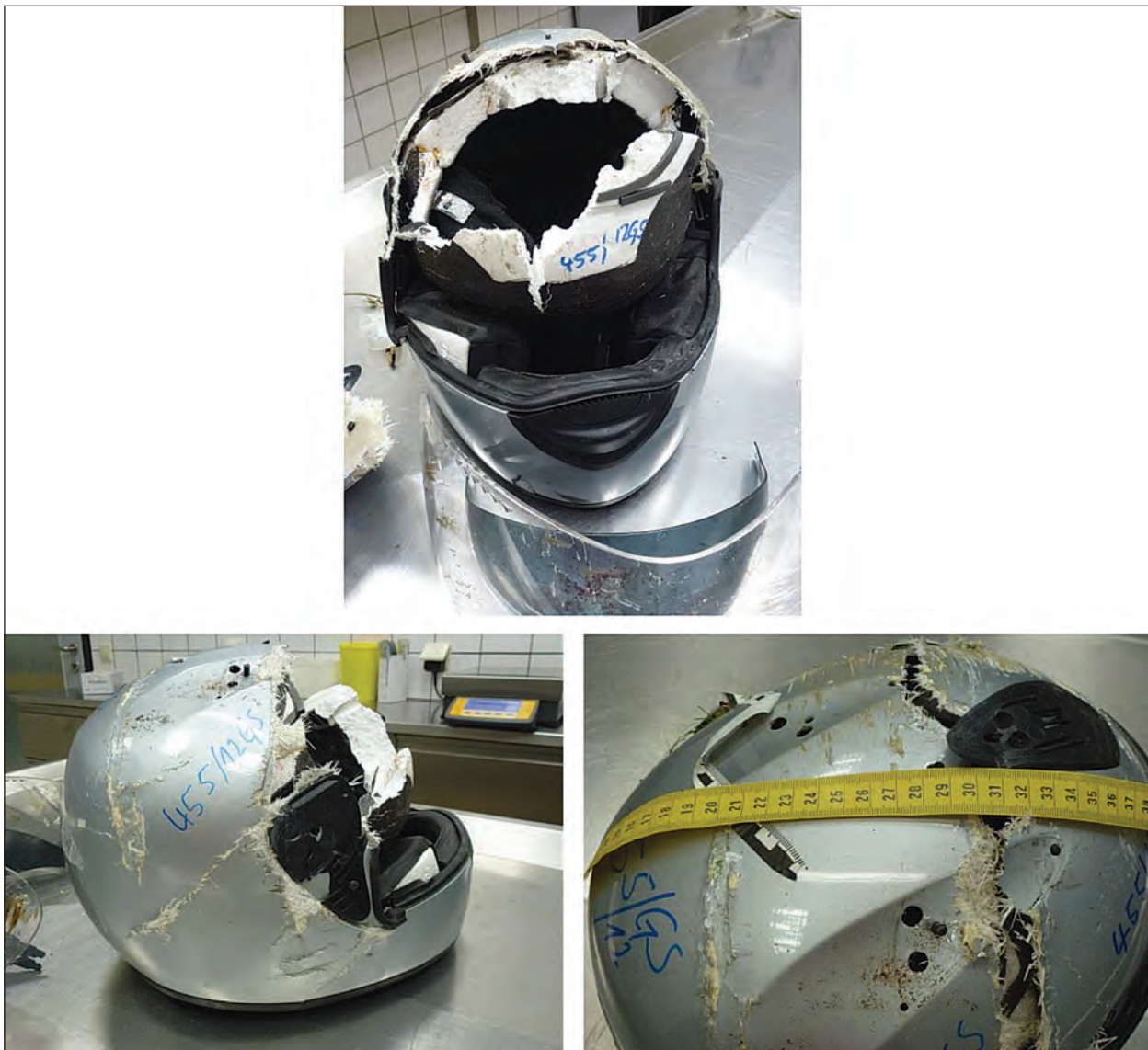
Bild 23: Getragener, unfallbeschädigter Integralhelm (GFK) – Archiv IRMFR
