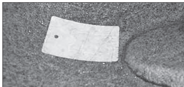
Bild 25: Fälschungssicherer Aufkleber entsprechend dem australischen Standard (Quelle des Bildes und aller weiteren, in diesem Kapitel wiedergegebenen Abbildungen ist das Archiv der Fa. Schubert GmbH, Magdeburg)
