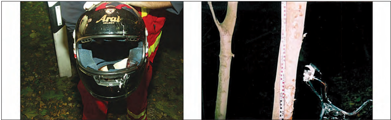
Bild 42: Getragener Integralschutzhelm und Anprallstruktur – Baumstamm
