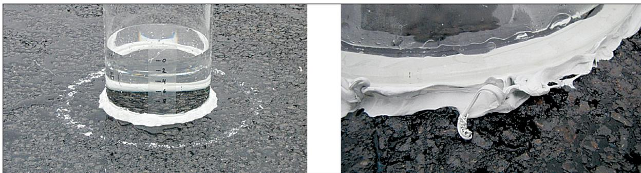
**Bild 5:** Durchflussmessgerät IVT zur Bestimmung der Wasserdurchlässigkeit in situ und Detail des Kittkranzes
