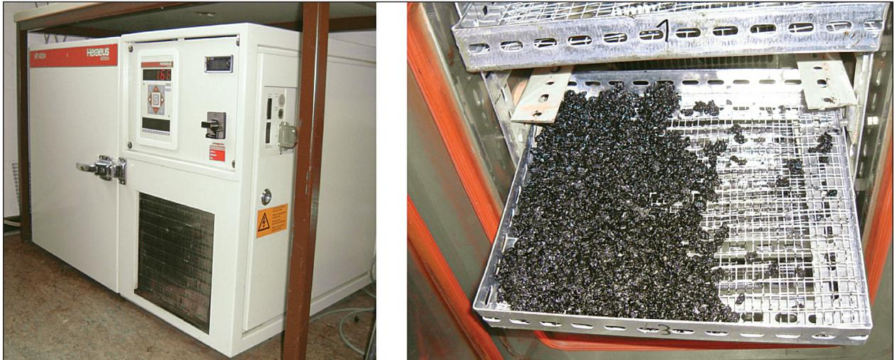
**Bild 9:** Materialprüfschrank und Lagerrost für die Braunschweiger Alterung (BSA)
