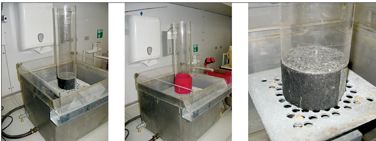
**Bild 4:** ISBS-Prüfgerät zur Bestimmung der vertikalen und horizontalen Wasserdurchlässigkeit von Probekörpern
