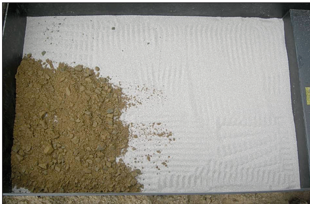
Bild 5: Bankettlysimeter mit Drainageschicht
