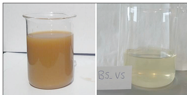
Bild 53: Trübung des BS-Sickerwasser am 30.05.2013 (links) und am 06.03.2014 (rechts)
