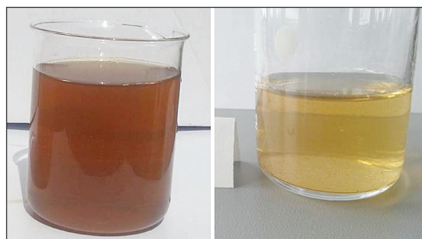
Bild 50: Trübung des OB Sickerwasser am 30.05.2013 (links) und am 15.05.2014 (rechts)
