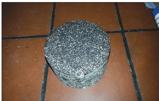
Bild 4.6: Mit Graphit beschichteter Probekörper
