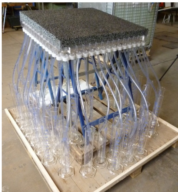
Bild 23: Erster Versuchsaufbau mit seitlich angeordneten Flaschenbatterien, PVC-Schläuchen und Messzylindern
