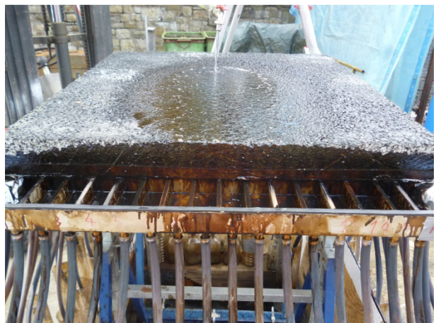
Bild 46: Überströmung der Oberfläche bei der hohlraumarmen PA-Variante (PA 3)
