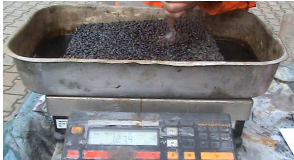
Bild 47: Kleinversuch zur Abschätzung des Verdunstungseffektes
