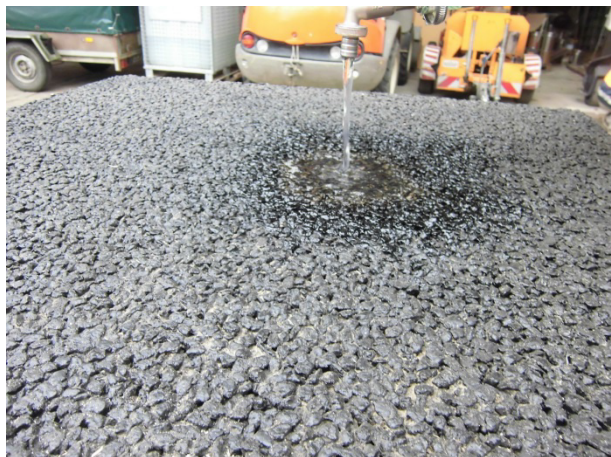
Bild 37: Benzinaufgabe auf Variante PA 1 (V = 29 Vol.-%) bei 6,0 % Neigung
