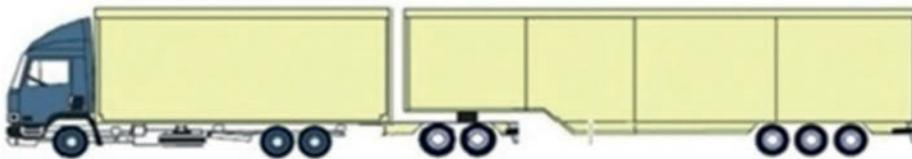
3. Lastkraftwagen mit Untersetzachse und Sattelanhänger bis zu einer Gesamtlänge von 25,25 Metern
