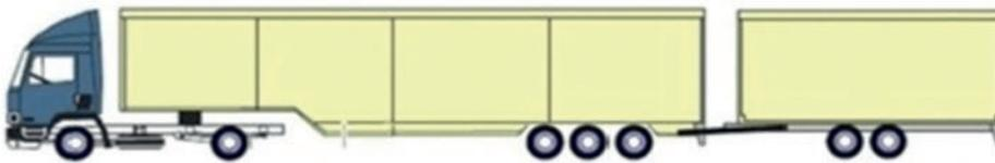
2. Sattelkraftfahrzeug mit Zentralachsanhänger bis zu einer Gesamtlänge von 25,25 Metern
