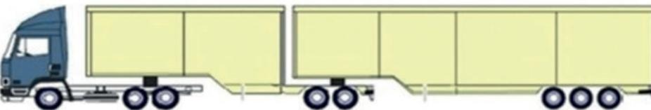
4. Sattelkraftfahrzeug mit einem weiteren Sattelanhänger bis zu einer Gesamtlänge von 25,25 Metern
