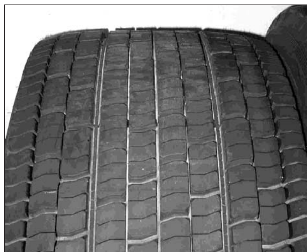
Bild 3.34: Profil des 495/45 R 22,5 HTR (Hersteller: Fa. Continental)
