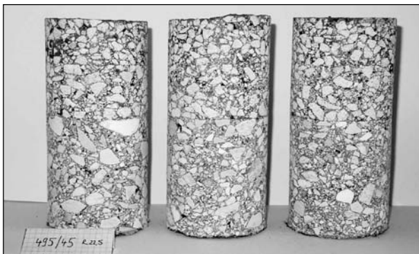
Bild 4.39: Bohrkern aus V3 mit 495/45R 22,5; Mitte Rollspur; Spurrand; Aus unbelastetem Bereich (von links)
