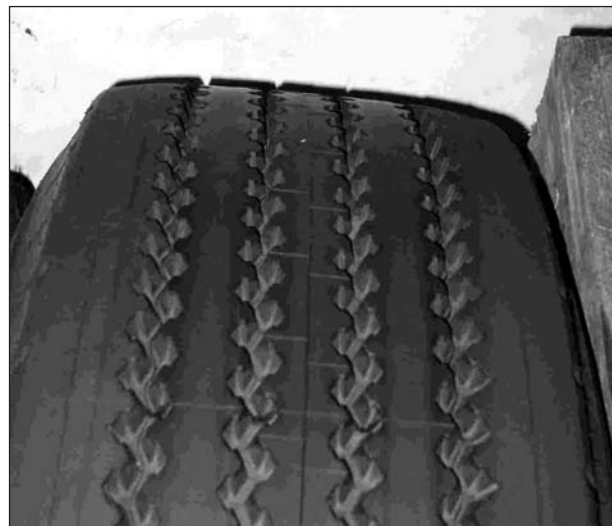
Bild 3.31: Profil des 385/65 R 22,5 HDR (Hersteller: Fa. Continental)
