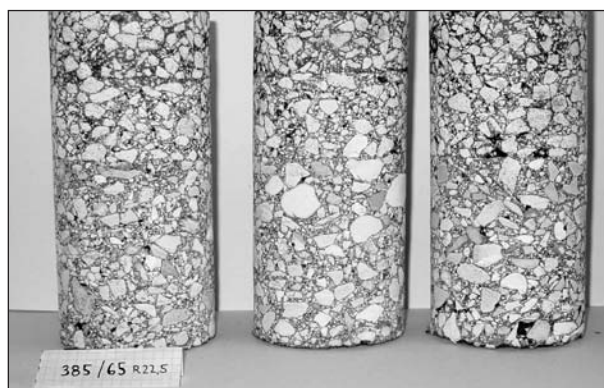
Bild 4.38: Bohrkern aus V2 mit 385/65 R 22,5; Mitte Rollspur; Spurrand; aus unbelastetem Bereich (von links)
