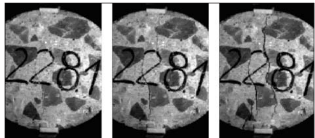
Bild 3.42: Bruchablauf eines Betonprobekörpers im Spaltzugversuch
