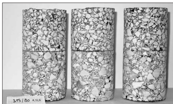
Bild 4.37: Bohrkern aus V1 mit 315/80 R 22,5 Mitte Rollspur; Spurrand; aus unbelastetem Bereich (von links)
