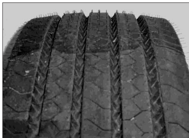
Bild 3.29: Profilgestaltung des Lenkachsreifens 315/80 R 22,5 (Hersteller: Fa. Continental)
