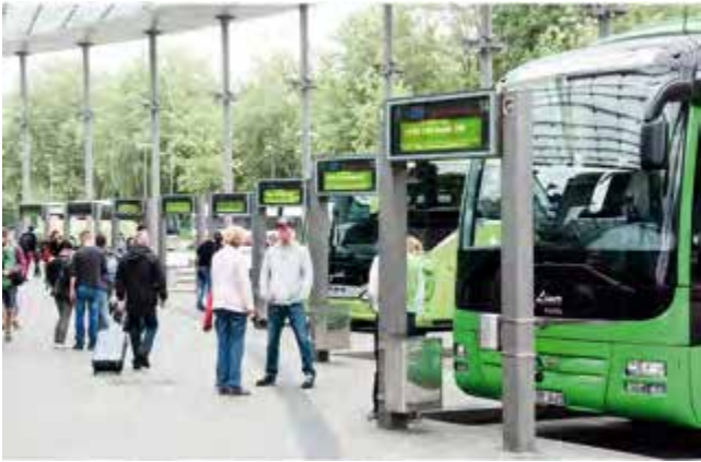
Bild 40: Parallel angeordnete Haltestellentaschen mit Erschließung für die Fahrgäste von vorne ohne Überqueren der Fahrbahn – Hamburg
