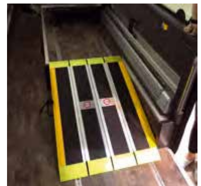
Bild 6: Faltrampe zur Auffahrt auf ein Podest (Rollstuhlstellplatz)
