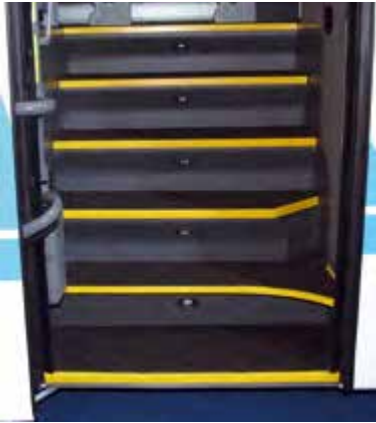
Bild 5: Einstiegsstufen mit visuell kontrastierender Stufenkantenmarkierung
