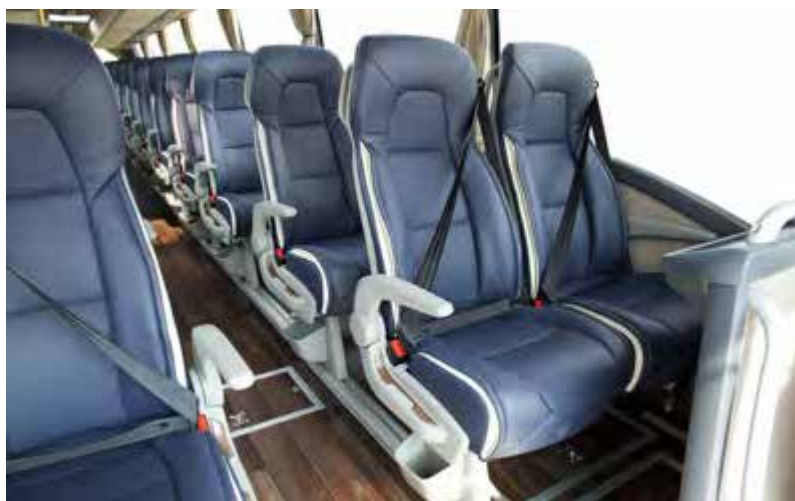
Bild 32: Fahrgastsitze mit Dreipunkt-Gurtsystem in einem Reisebus
