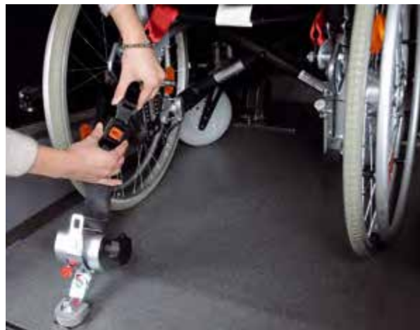
Bild 20: Bestandteile eines kombinierten Personen- und Rollstuhlrückhaltesystems mit Kraftknoten nach DIN 75078-2 – Schema
