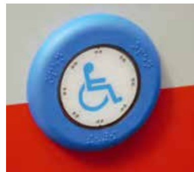
Bild 12: Kommunikationseinrichtung zur Anforderung einer Einstiegshilfe neben der Betriebstür an der Fahrzeugaußenseite
