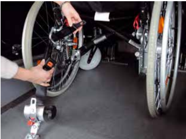
Bild 21: Verbinden des Rückhaltesystems mit dem Kraftknoten (Gurt und Öse)
