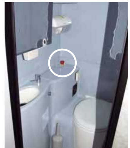
Bild 34: Bord-WC mit visuell kontrastierendem Notruftaster
