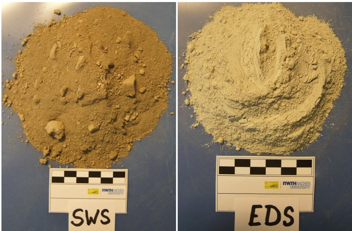
**Bild B6:** Fotos der Stahlwerksschlacke und der Edelstahlschlacke
