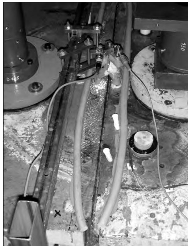
**Bild 19:** Gezielte Wasserzugabe an der Fuge; STSuB S1 nach 1,45 Mio LW
