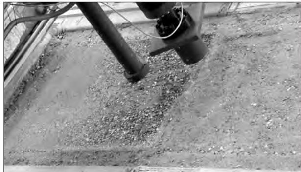
**Bild 23:** Oberfläche der freigelegten Kiestragschicht Kg nach dem Dauerschwingversuch mit Wasserzugabe; simulierte Fahrtrichtung von rechts (Platte 1 mit Prüfzylinder P1) nach links
