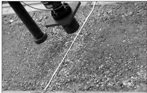
**Bild 24:** Oberfläche der freigelegten modifizierten Kiestragschicht Km nach dem Dauerschwingversuch mit Wasserzugabe; simulierte Fahrtrichtung von rechts (Platte 1) nach links; das weiße Maßband markiert den Verlauf der – zunächst als verdübelt, dann in der Schlussphase als unverdübelt simulierten – Fuge
