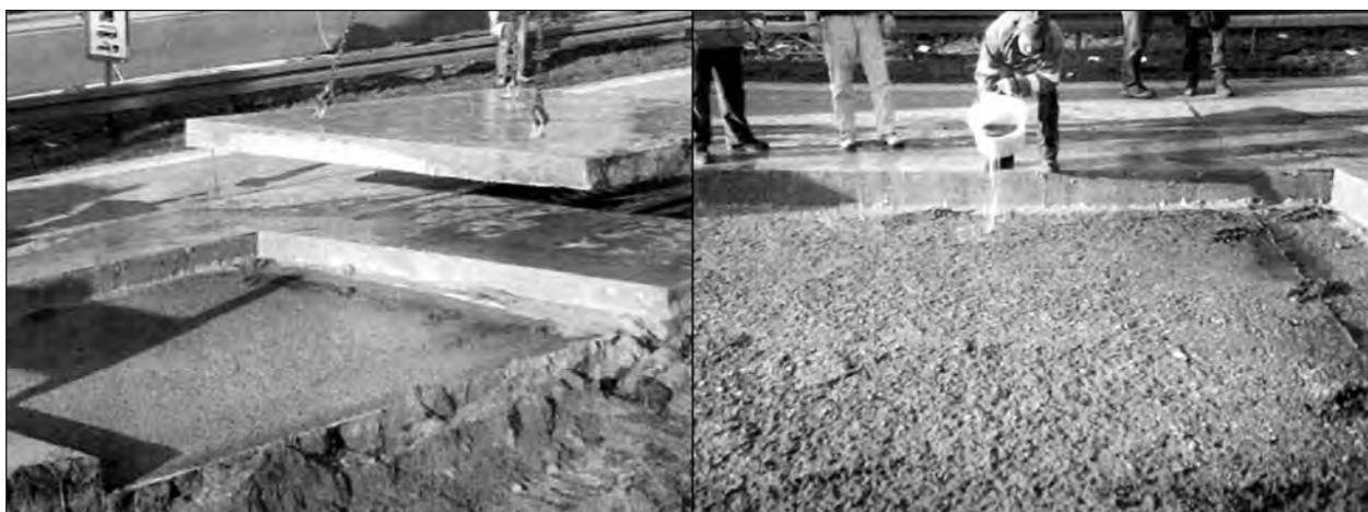
**Bild 20:** STSuB aus natürlicher Gesteinskörnung nach neunjähriger Nutzungsdauer, Schnitt 30 cm hinter der Querfuge; gute Wasserdurchlässigkeit [15]
