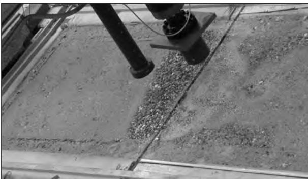
**Bild 22:** Oberfläche der freigelegten Kiestragschicht KTS nach dem Dauerschwingversuch mit Wasserzugabe; simulierte Fahrtrichtung von rechts (Platte 1 mit Prüfzylinder P1) nach links; die dunkelgraue Markierung zeigt die – in der Schlussphase unverdübelte – Fuge an
