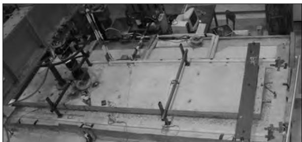
**Bild 8:** Großprüfstand mit zwei an den Enden abgespannten Betonplatten und Messeinrichtungen; an den Fugenrändern gegenüberliegend je ein unabhängig gesteuerter Prüfzylinder
