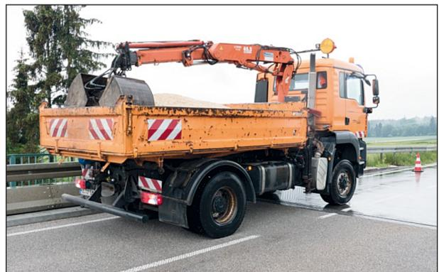
Bild 11: Beladener Lkw als Belastungsfahrzeug
