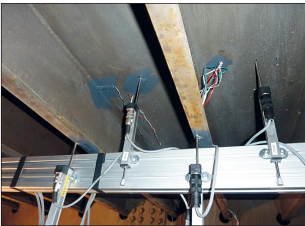
Bild 13: Messgeber im Inneren des Hohlkastens
