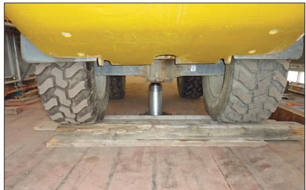
Bild 10: Belastung mit Presse und Radlader als Gegengewicht
