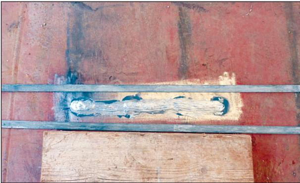
Bild 12: Dehnungsmesstreifen auf der Oberseite
