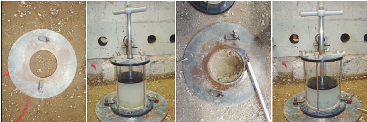
Bild 53: Dichtebestimmung mit dem Ballonverfahren
