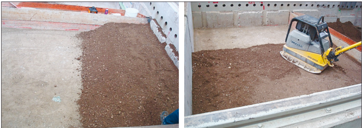
Bild 46: Verdichtung der ersten Versuchsmischung
