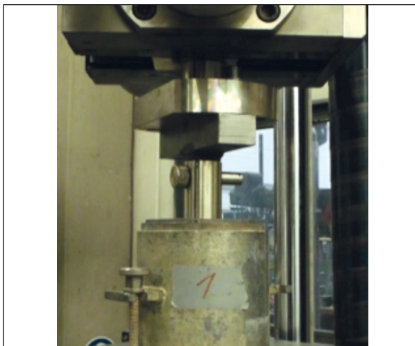
Bild 29: Durchführung eines CBR-Versuchs
