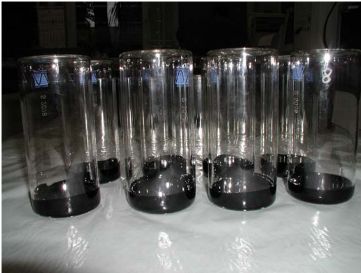
Bild 2.1.1: Alterung von Bindemitteln nach RTFOT-Verfahren Glasbehälter mit bitumenhaltigem Bindemittel befüllt, vor Durchführung der Alterung
