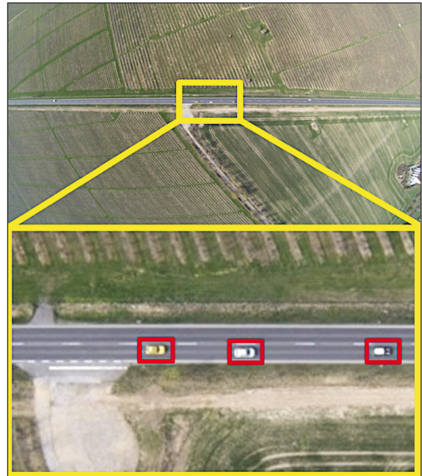
Bild 42: Bildausschnitte aus den Messdaten inkl. verfolgter Fahrzeuge
