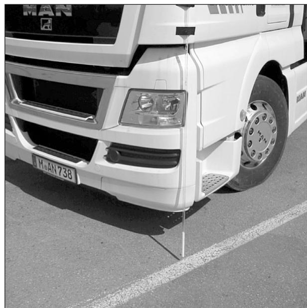
**Bild 18:** Peilhilfe an vorderer, äußerer Ecke des Fahrzeugs für die Kreisfahrt nach § 32d der StVZO
