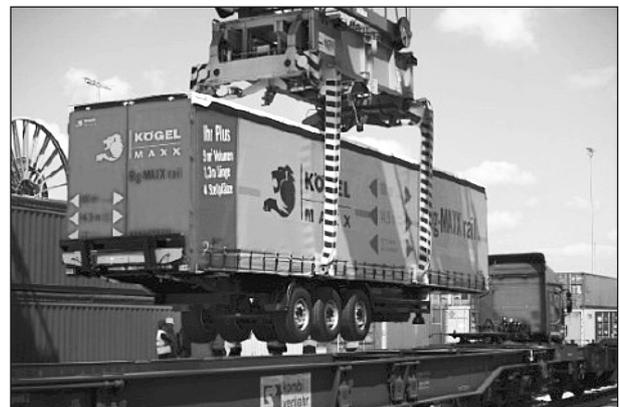
**Bild 7:** Verladung eines verlängerten Aufliegers (entsprechend Lang-Lkw Typ 1) mit hochgeklappten Unterfahrschutz auf einen Taschenwagen
