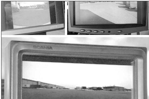
**Bild 14:** Sichtfelder bei Anbringung der Kamera im Bereich des hinteren Unterfahrschutzes
