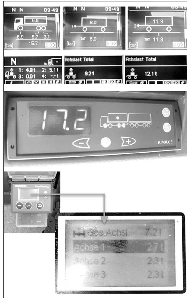
**Bild 11:** Oben: Achslastanzeigen in der Tachomuschel des Fahrerhauses. Mitte: nachgerüstetes System mit Anzeige im Fahrerhaus (Kimax), Unten: elektronische Anzeige am Anhänger (Wabco Smartboard System)
