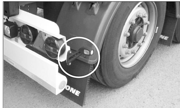
Bild 3: Spurhalteleuchten nach § 51 Absatz 4 der StVZO
